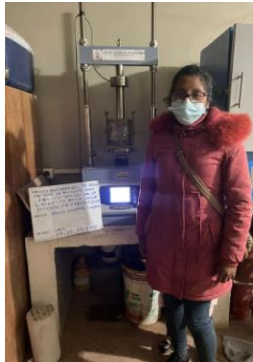
Figura 25. Ensayo de CBR con proporciones de 3%, 7% y 11% de ceniza.
