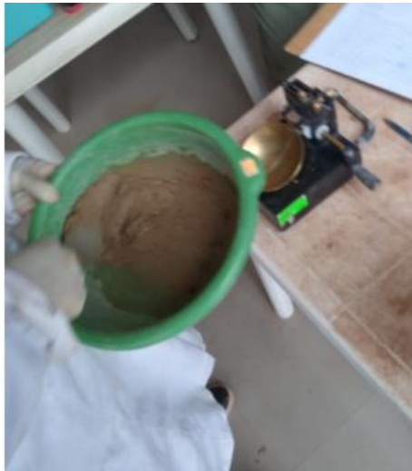
FIGURA 19. Preparando muestra para el ensayo de limite plastico con las incorporacion de ceniza de hojas d e eucalipto con proporciones de 0%. 3%, 7% y 11%
