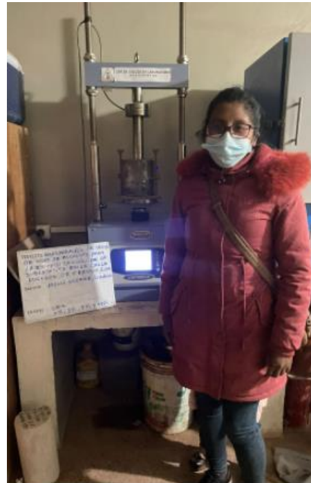
FIGURA 27. El ensayo de penetración en la máquina de compresión, CBR con la incorporación de ceniza en proporciones de 0%, 3%, 7% y 11%.
