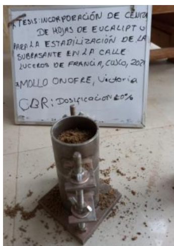
FIGURA 23. Compactacion del suelo para realizar en el ensayo de CBR.
