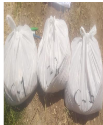
Figura 14. Muestra de las tres calicatas
