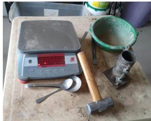
FIGURA 18. Algunos materiales que se utilizaron en los ensayos realizados tales como limite liquido, proctor modificado, CBR.
