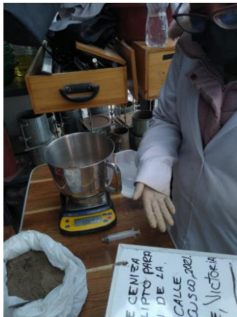
FIGURA 21. Realizando la dosificacion de ceniza de 3%, 7% y 11%
