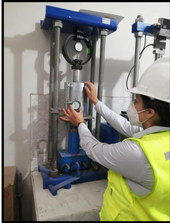
Imagen 14: Ensayo de CBR
