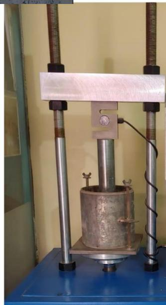
*ENSAYOS EN LABORATORIO DE MUESTRAS DE CBR*
