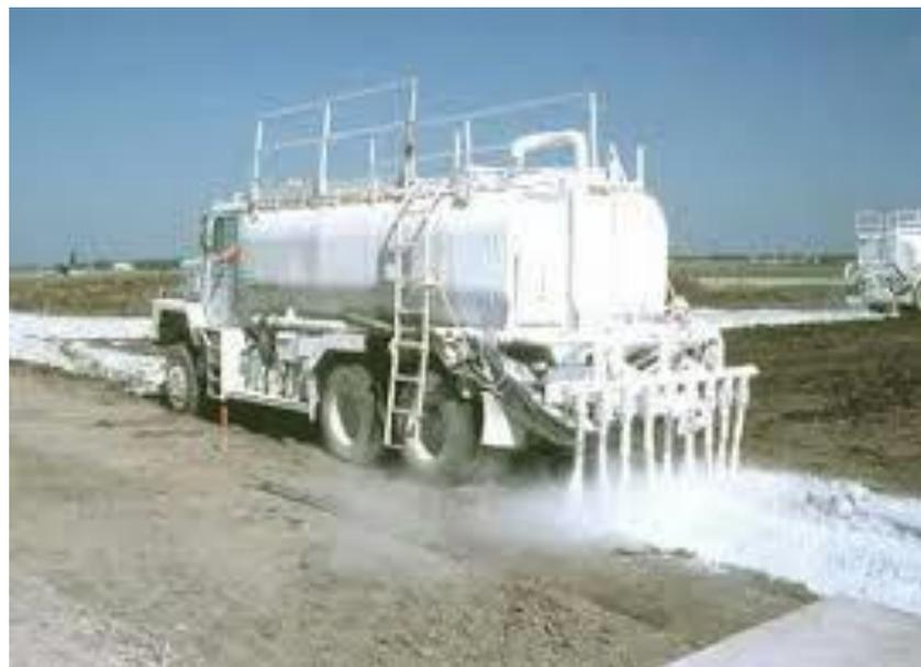
FIGURA N° 20: Camión estabilizador
