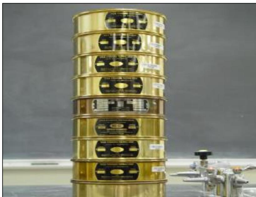
Figura 6: Tamices (Mallas para tamizado)
