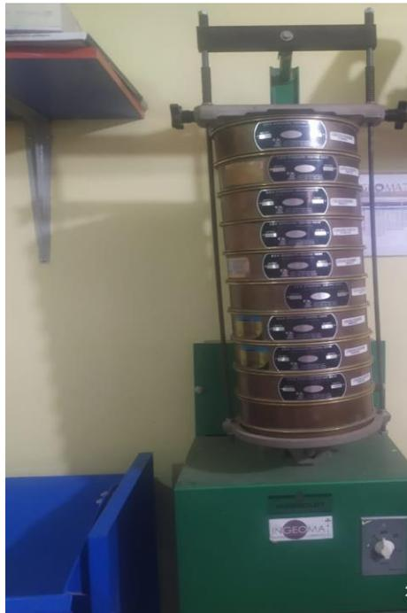
*ENSAYOS DE LABORATORIO DE LA GRANULOMETRIA*
