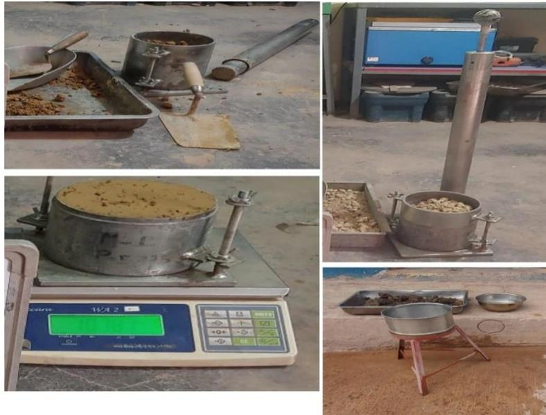
*ENSAYOS EN LABORATORIO DE MUESTRAS DE CBR*
