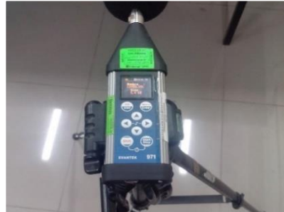
Paso N°2: medicion del ruido ambiental en el laboratorio con el sonometro
