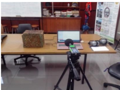
Paso N°5: se coloco los parlantes dentro de la caja de planchas acusticas
