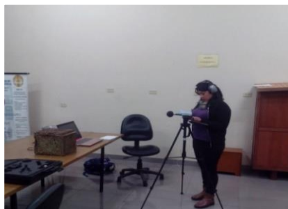
Paso N°6: se procedio a medir el ruido generado por las bandas de octavas (63 Hz; 125 Hz; 250 Hz; 500 Hz; 1000 Hz; 2000 Hz; 4000 Hz). para ver la absorcion acustica.
