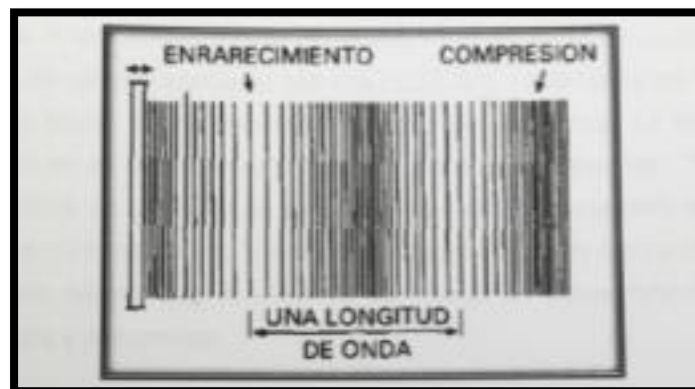
Figura 1. Generación de ondas sonoras por una superficie vibrante
