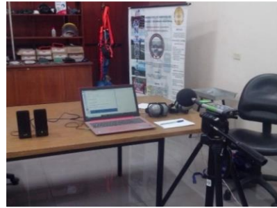
Paso N°4: se procedio a medir el ruido generado con bandas de octavas sin la plancha acustica (63 Hz; 125 Hz; 250 Hz; 500 Hz; 1000 Hz; 2000 Hz; 4000 Hz).
