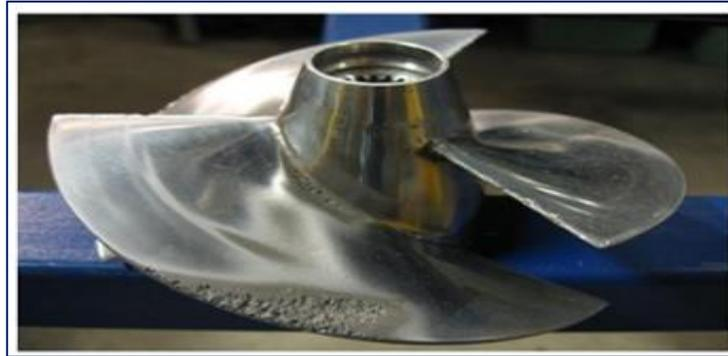
*Figura 6. Daño por cavitación en hélice de lancha.*
