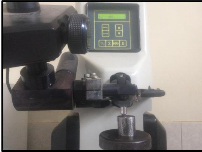
*Figura C. Durómetro digital a utilizar.*
