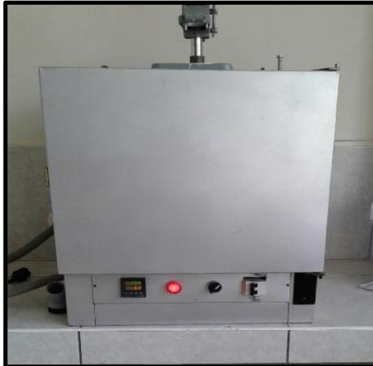
*Figura A.* Horno eléctrico tipo mufla utilizado en la presente investigación. Temperatura máxima = 1200°C
