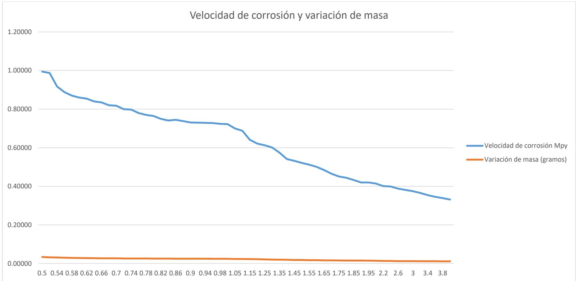
Gráfica 5. Tiempo de carburización, sobre la variación de masa (Gramos) y velocidad de corrosión del acero AISI 3115
