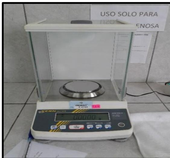
*Figura B.* Balanza digital.  $\pm 0.0001$  g
