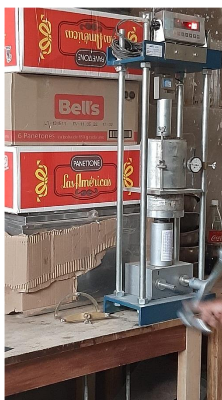
Figura 32: Ensayo de CBR
