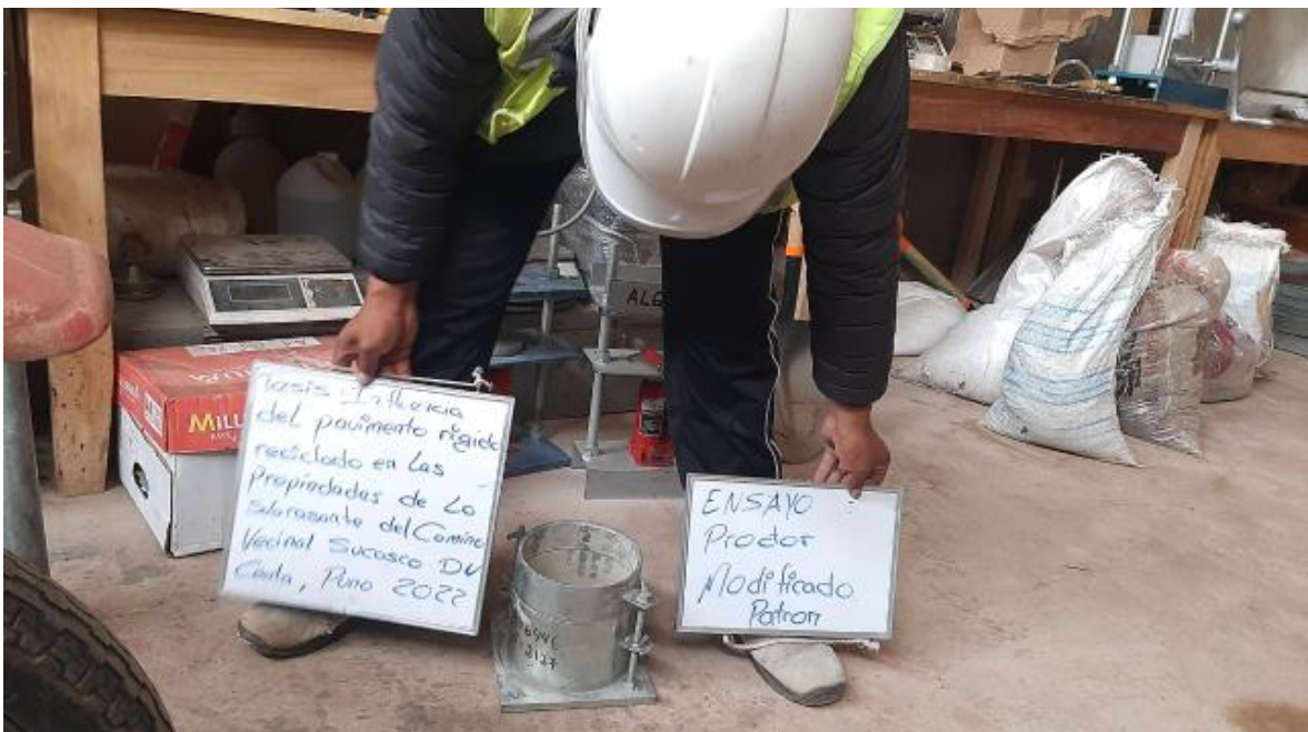
Fotografía 6. Ensayo de Proctor Modificado
