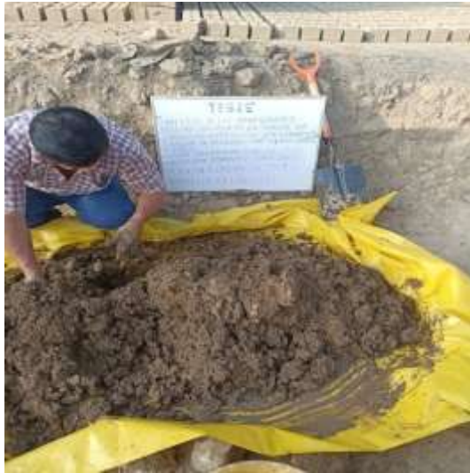
Foto 23. Mezcla con agua homogeneidad.
