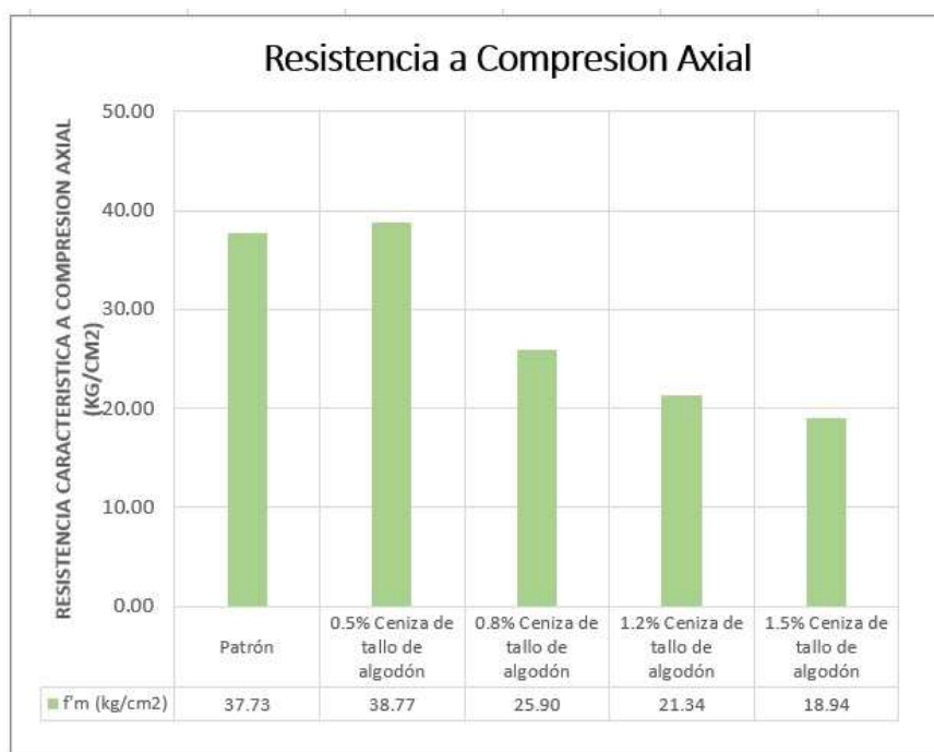
Figura 60 . Grafico de barras de resultados del ensayo de Compresión Axial de unidades con 0%, 0.5% , 0.8% ,1.2% y 1.5% de ceniza de tallo de algodón.
