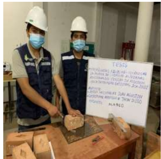
Foto 40. Ensayo de Alabeo
