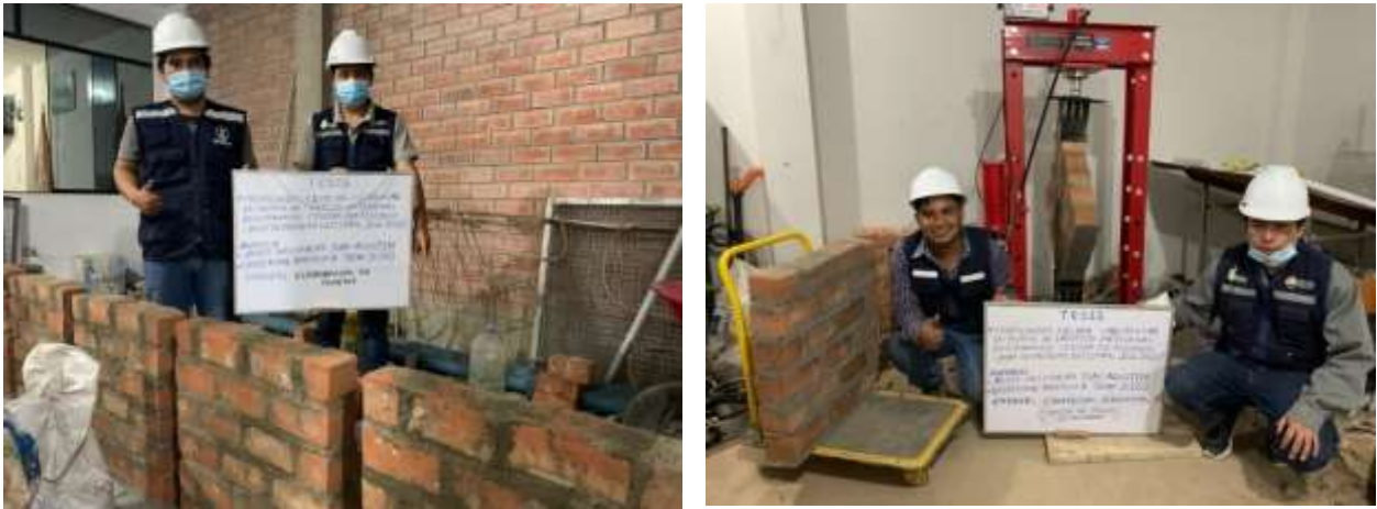
Figura 66. Ensayo de compresión diagonal
