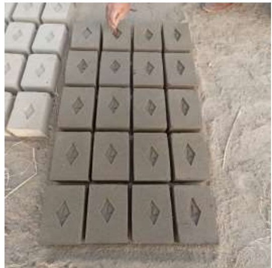
Foto 26. Reposo de 24, para homogeneidad.
