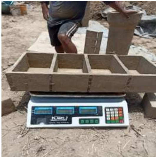
Foto 19. Molde para ladrillos artesanales
