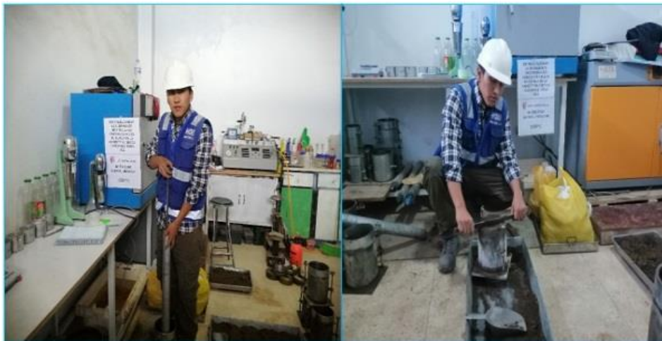
figura 45. compactación y enrasado CBR
