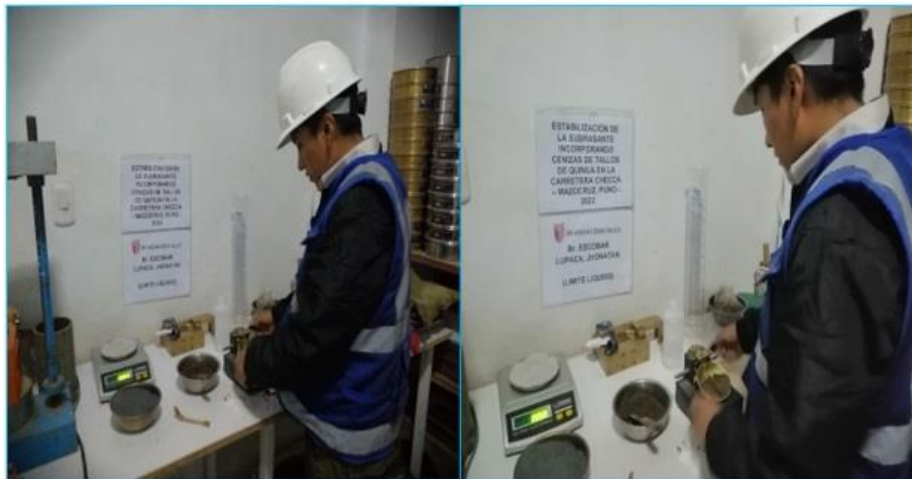
figura 32. Ensayo de Limite Liquido
