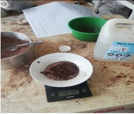
Foto. N° 14.- En la imagen se muestra la agregado de agua destilada para muestra y obtener una humedad.
