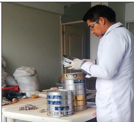
Foto. N° 04.- En la imagen se muestra proceso de granulometría.
