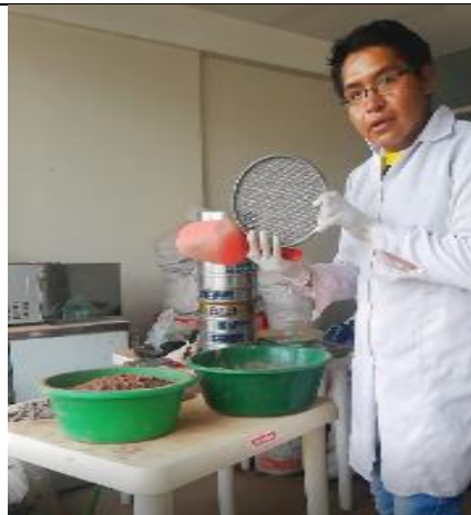
Foto. N° 07.- En la imagen se muestra la separación de material por la malla N° 4 para realizar los ensayos de límite de consistencia.
