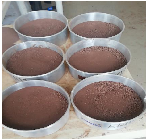
Foto. N° 13.- En la imagen se muestra el material pasante por el tamiz de 4,760 mm (N° 4). para realizar el ensayo de contenido de humedad por los métodos
