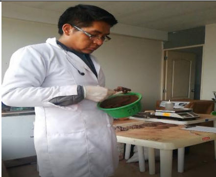
Foto. N° 10.- En la imagen se muestra el proceso de ensayo límite plástico.
