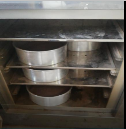
Foto. N° 12.- En la imagen se muestra el proceso de secado en el horno tipo tiro forzado de una temperatura de 110 \pm 5 °C. durante un tiempo de 24 horas.
