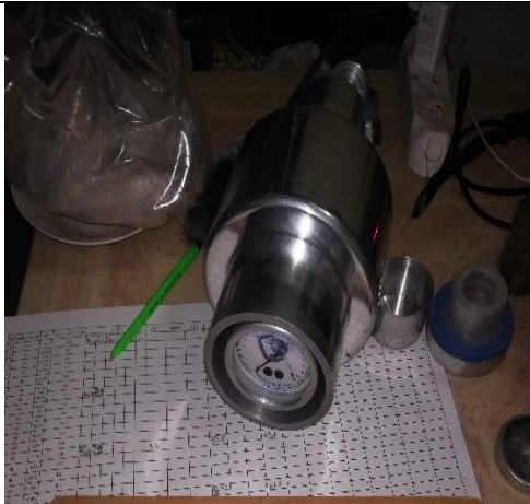
Foto. N° 18.- En la imagen se muestra proseso de secado por el metodo sucion matrica ( speedy )
