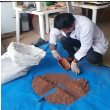
Foto. N° 02.- En la imagen se muestra proceso descarte dos porciones de muestra
