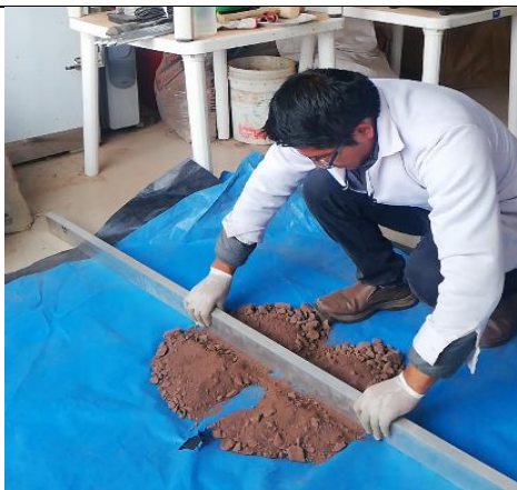
Foto. N° 01.- En la imagen se muestra es cuarteo del material.
