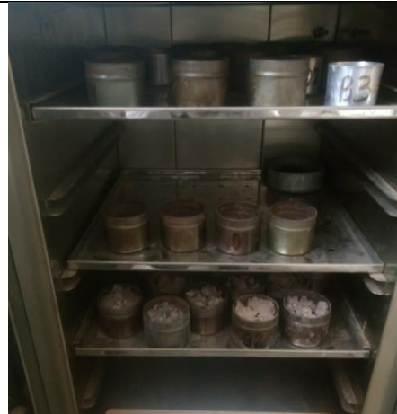
Foto. N° 19.-En la imagen se muestra el secado por el metodo grabimetrico ( tipo tiro forzado) de una temperatura de 110 \pm 5 °C. durante tiempo de 24 horas.
