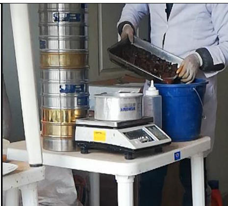
Foto. N° 03.- En la imagen se muestra proceso de lavado material determinar el porcentaje de finos.
