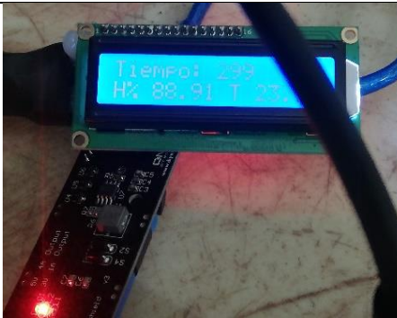
Foto. N° 17.- En la imagen se muestra proceso del ensayo método capacitivo (sensor).
