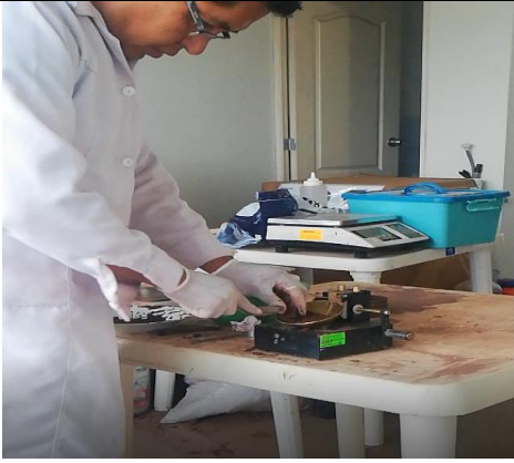
Foto. N° 08.- En la imagen se muestra el proceso de límite líquido.
