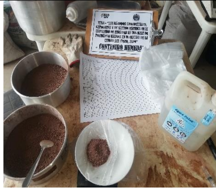
Foto. N° 15.- En la imagen se muestra pesos de muestra humedad.
