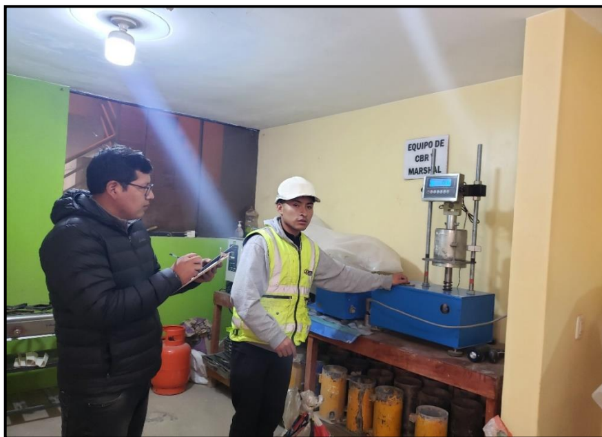
Figura 16: Lectura del ensayo de penetración para CBR. Fuente: Elaboración propia.
