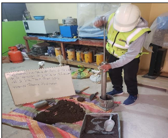
Fotografía 5: Procedimiento de ensayo Proctor Modificado.
