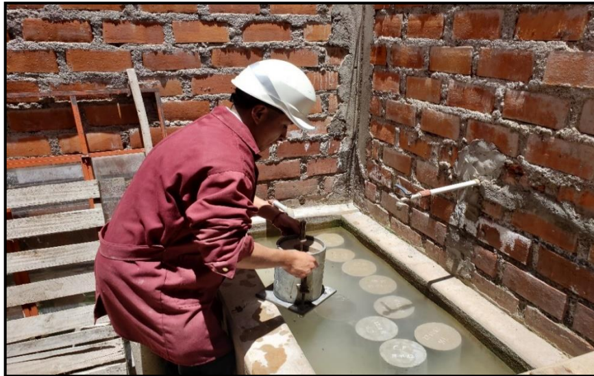
Figura 15: Sumergido de moldes de CBR. Fuente: Elaboración propia.
