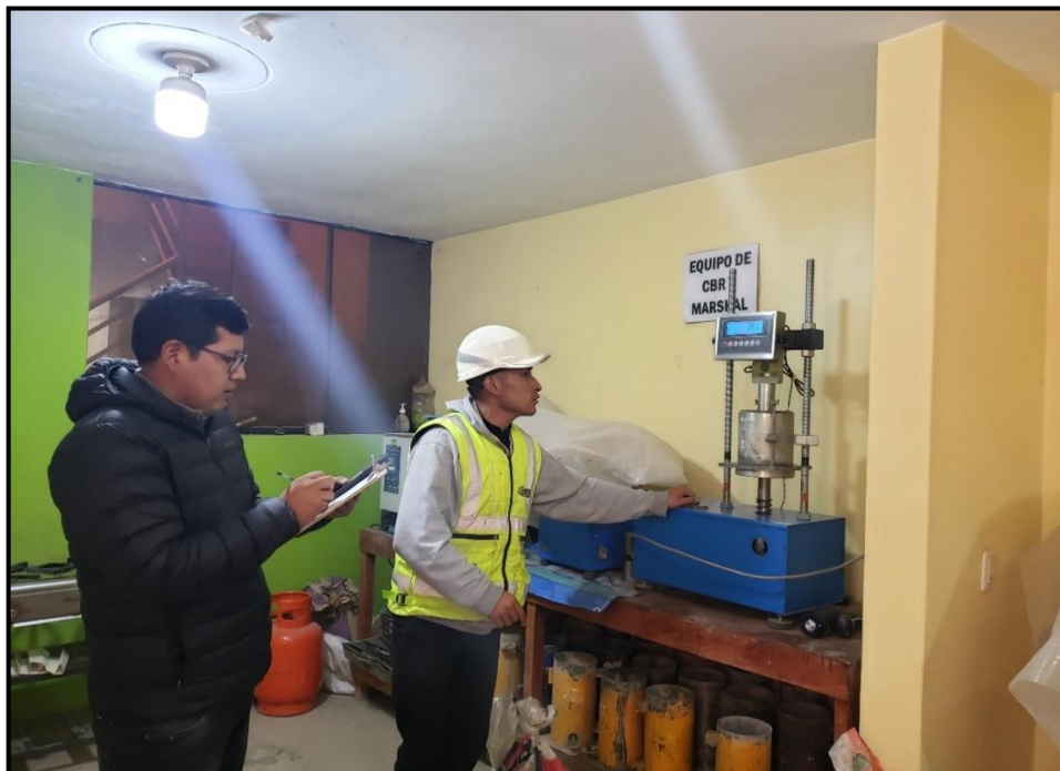
Figura 22: Lectura de penetración CBR del suelo mejorado con CTQ. Fuente: Elaboración propia.
