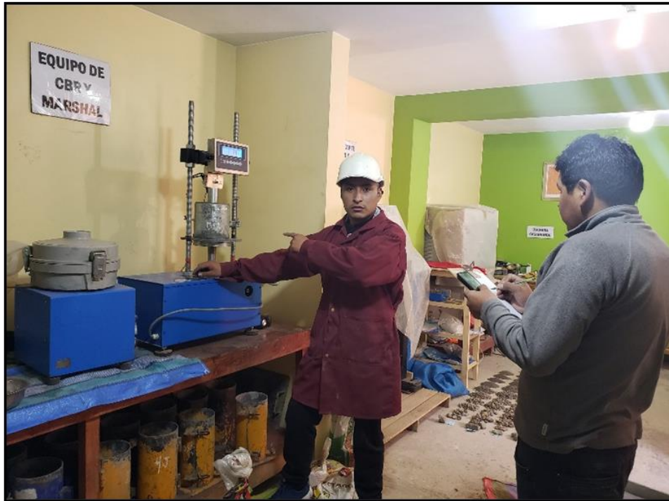
Figura 21: Lectura de penetración CBR. Fuente: Elaboración propia.
