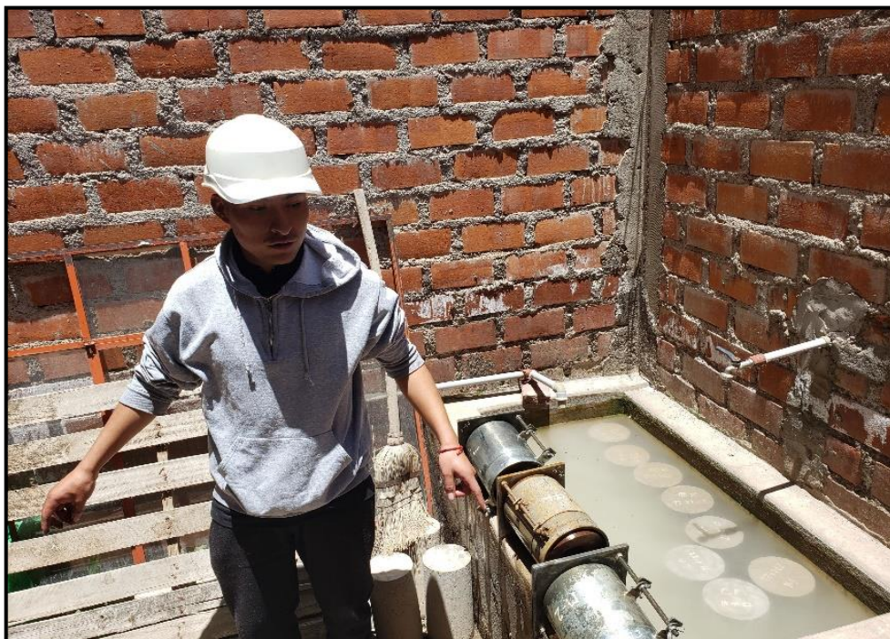
Figura 25: Retirado de sumergido para penetración CBR. Fuente: Elaboración propia.
