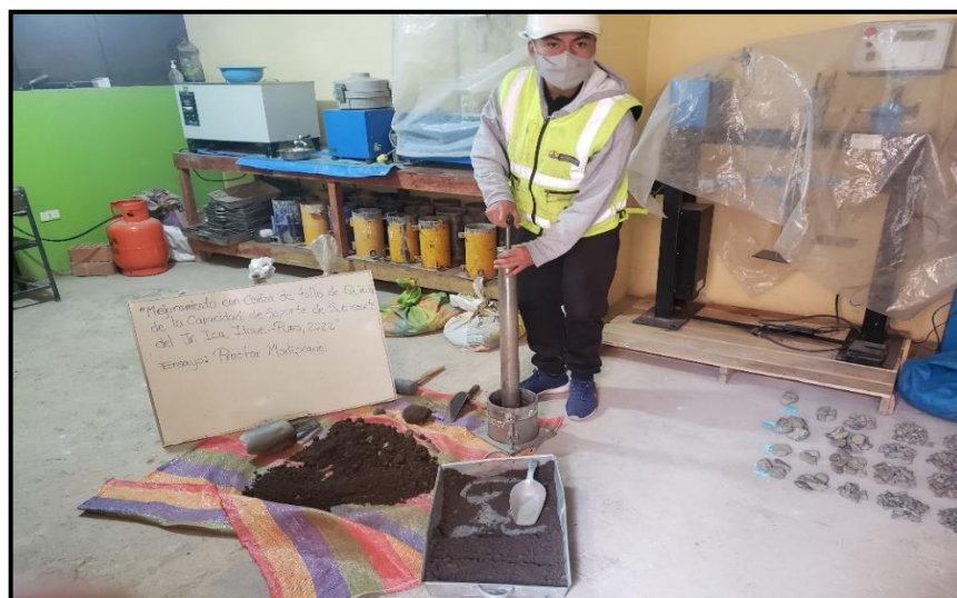
Figura 14: Ensayo de Proctor Modificado del suelo natural + aditivo. Fuente: Elaboración propia.
