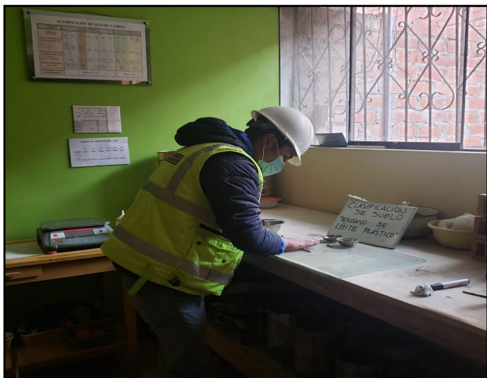
Figura 28: Ensayo de Límite plástico. Fuente: Elaboración propia.
