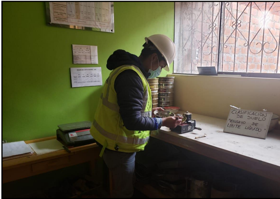
Figura 27: Ensayo de cuchara de Casagrande (Límite líquido). Fuente: Elaboración propia.
