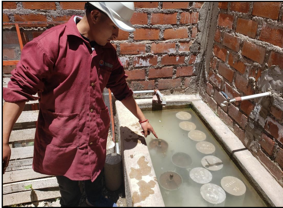
Figura 24: Sumergido para posterior lectura de expansión del suelo. Fuente: Elaboración propia.
