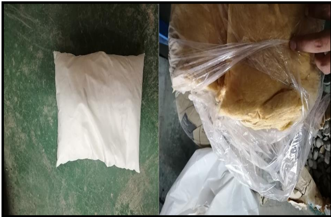
Figura 41. Cal hidratada y Fibra de vidrio empleados para el desarrollo del proyecto.
