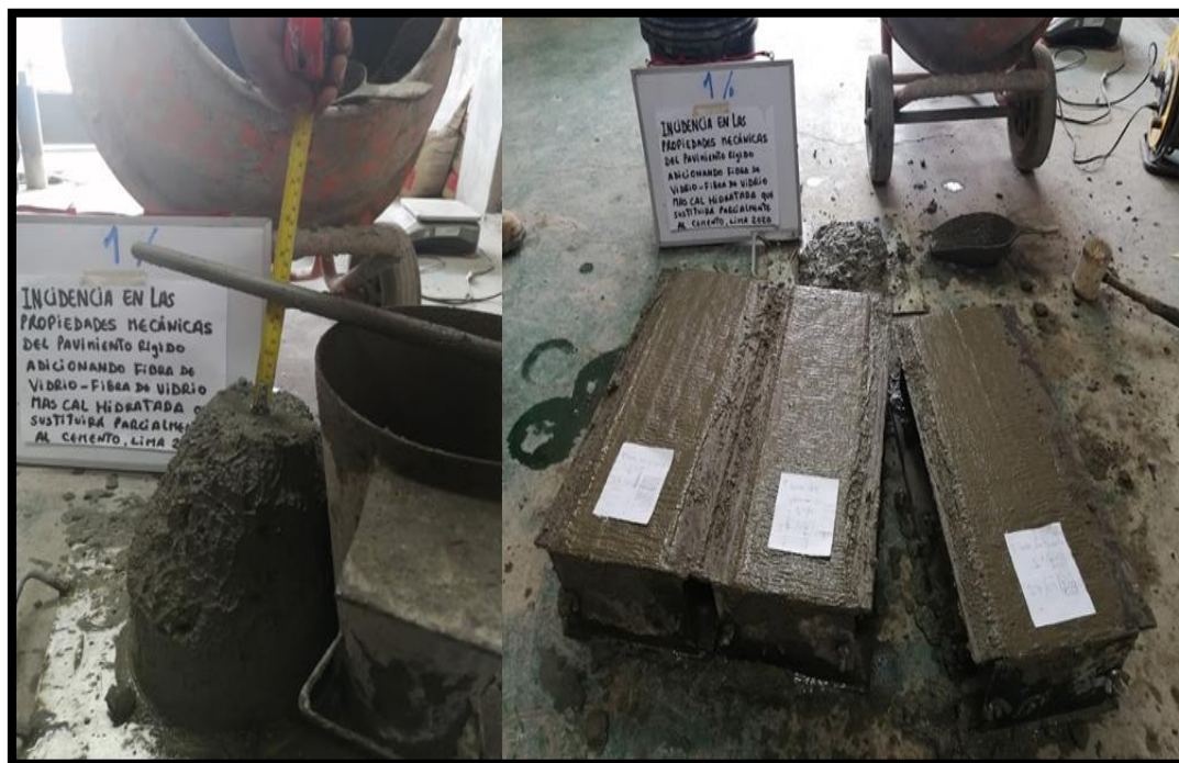
Figura 52. Procesos de medición del asentamiento del concreto en la adición del 1% de fibra de vidrio y vaciado en el molde de viga de concreto para las edades de 7, 14 y 28 días.
