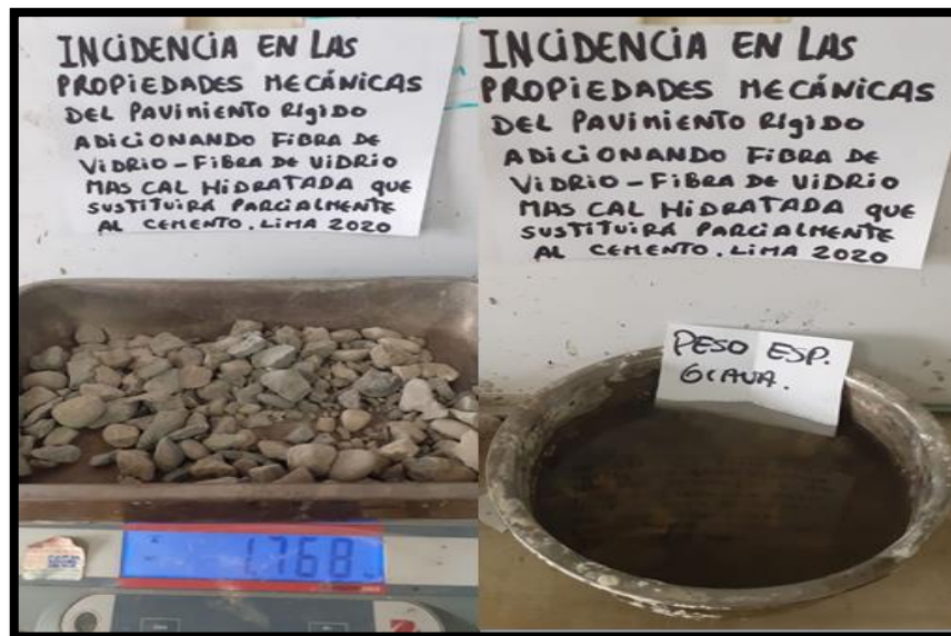
Figura 8. Procedimiento para obtener el peso específico y absorción del agregado grueso.
