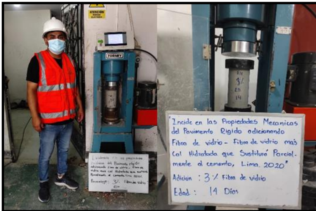
Figura 64. Rotura de la probeta de la muestra patrón y con la adición del 3% de fibra de vidrio en la edad de 7 días.
