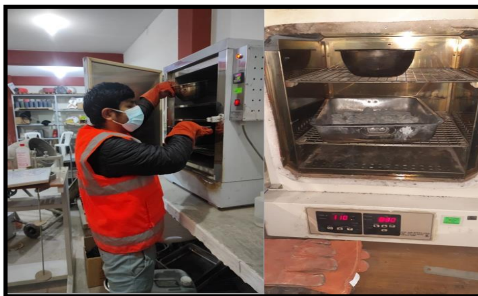
Figura 5. Proceso de secado, para obtener el contenido de humedad.
