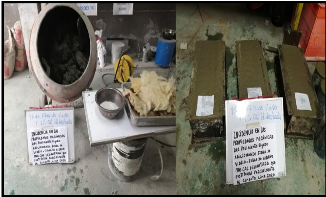
Figura 55. Procesos de medición del asentamiento del concreto en la adición del 1% de fibra de vidrio más el 1% de cal hidratada y el vaciado en el molde de viga de concreto para las edades de 7, 14 y 28 días.
