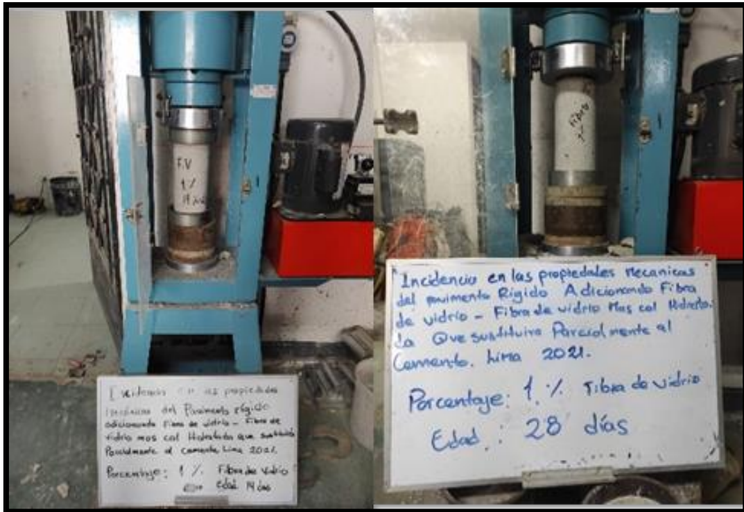
Figura 61. Rotura de las probetas con la adición del 1% de fibra de vidrio en las edades de 14 y 28 días.
