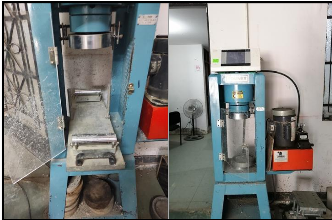
Figura 44. Máquina de compresión y flexión empleada para el desarrollo del proyecto.
