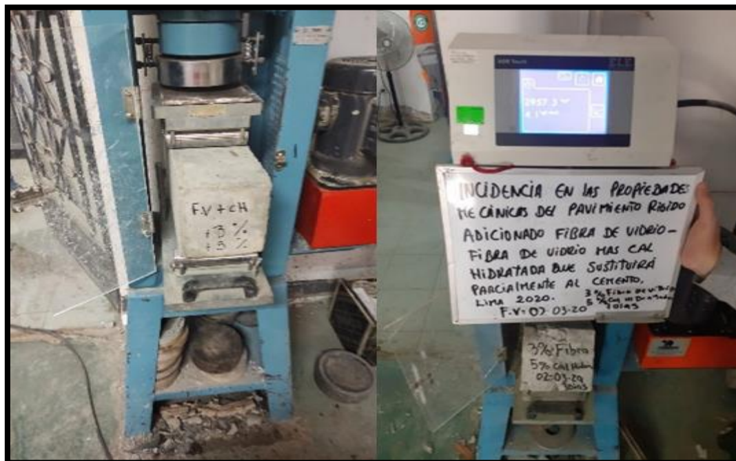
Figura 74. Rotura de las vigas patrón y además de las adiciones del 3% de fibra de vidrio más el 5% de cal hidratada el cual sustituye parcialmente el cemento en la edad de 7 días.
