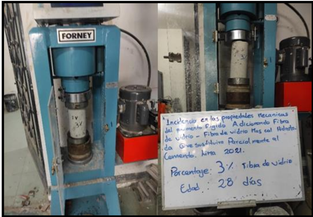
Figura 65. Rotura de las probetas con la adición del 3% de fibra de vidrio en las edades de 14 y 28 días.
