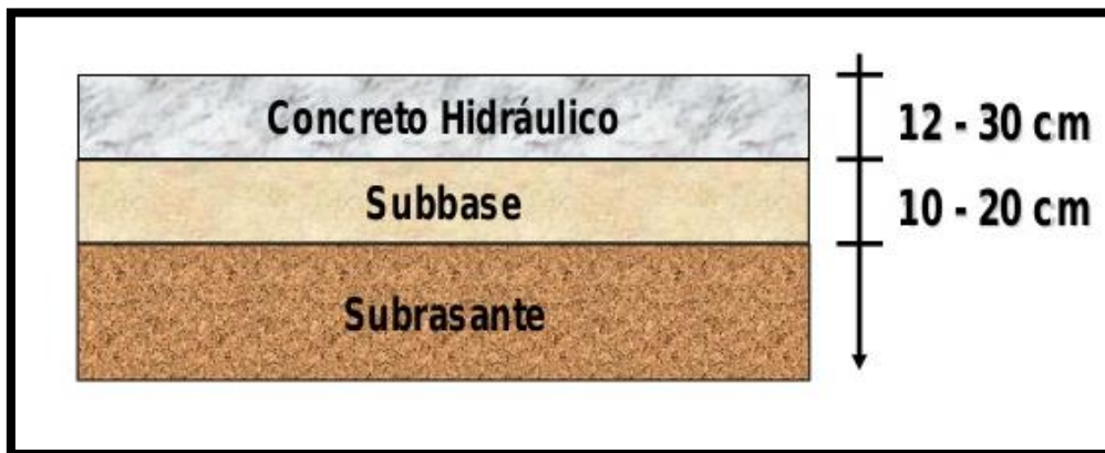
Figura 25. Corte transversal de un pavimento rígido.
