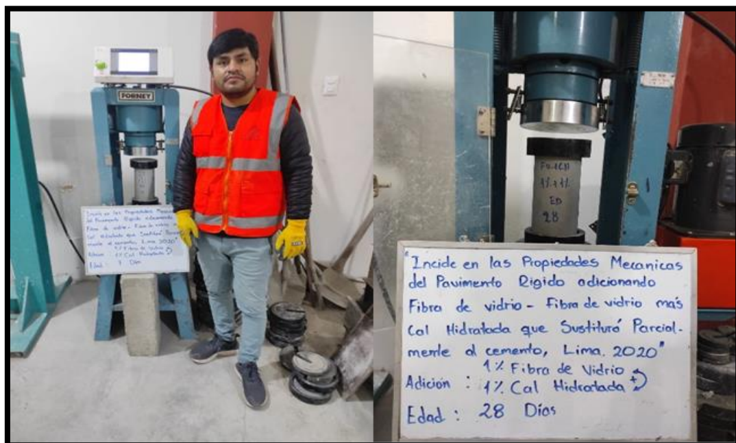
Figura 72. Rotura de las probetas con la adición del 1% de fibra de vidrio más 1% de cal hidratada el cual sustituye parcial mente al cemento en las edades de 7 y 28 días.
