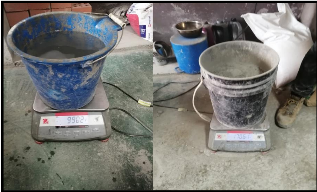
Figura 47. Peso de las cantidades de agua y cemento estipulados en el diseño de mezcla.
