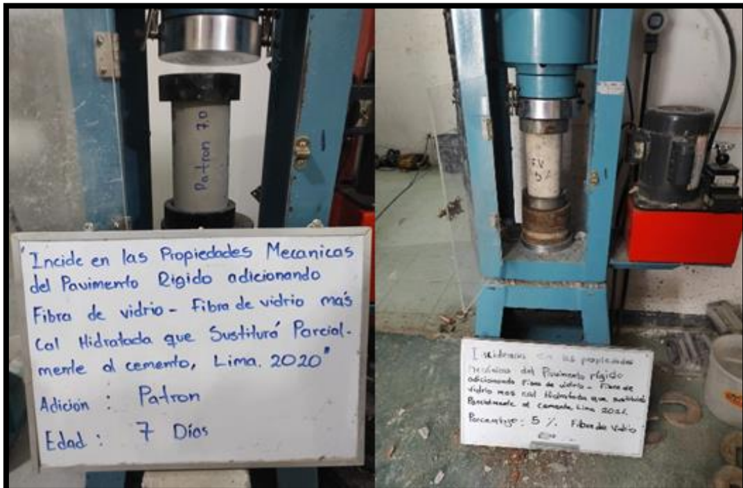
Figura 68. Rotura de la probeta de la muestra patrón y con la adición del 5% de fibra de vidrio en la edad de 7 días.
