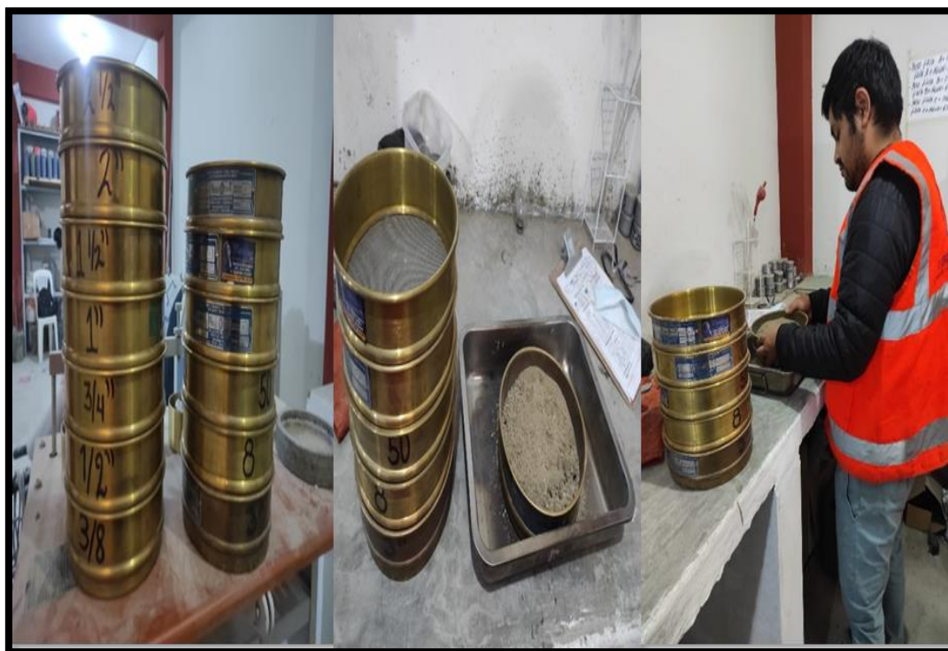
Figura 33. Proceso del ensayo de los análisis granulométricos de los agregados finos y gruesos.
