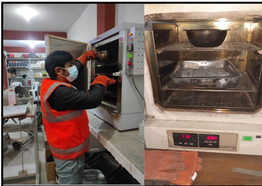
Figura 35. Proceso de secado, para obtener el contenido de humedad de la grava y arena.
