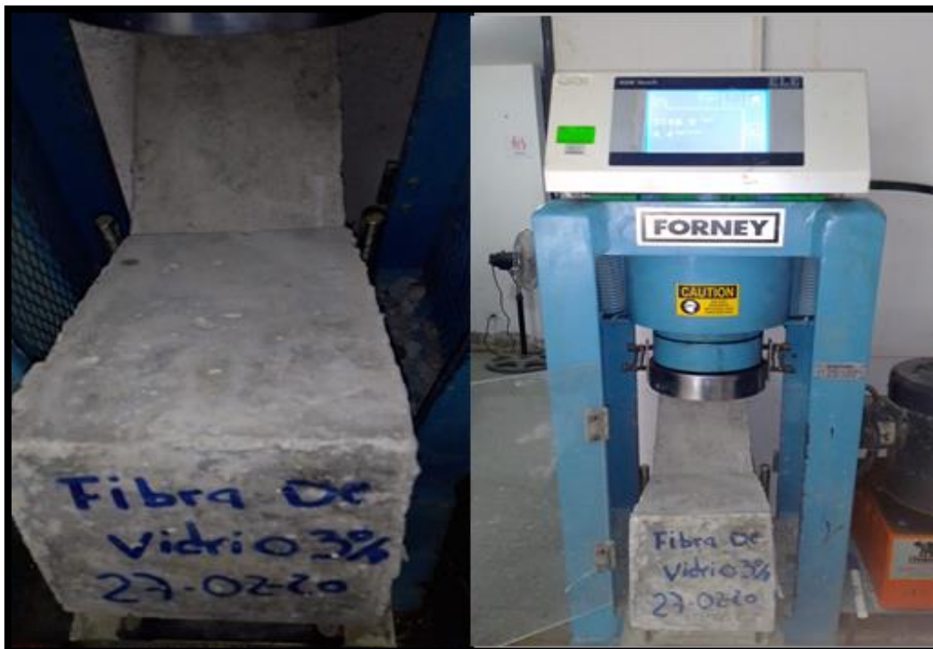
Figura 62. Rotura de la viga de la muestra patrón y con la adición del 3% de fibra de vidrio en la edad de 7 días.
