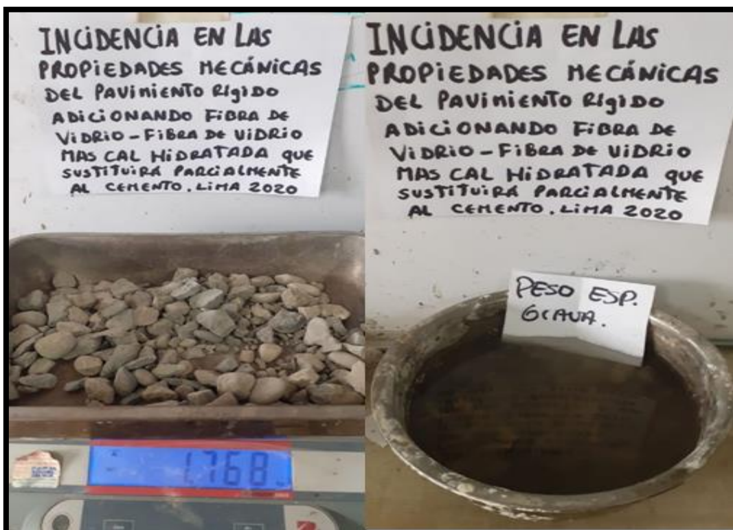
Figura 36. Peso específico y absorción del agregado grueso.
