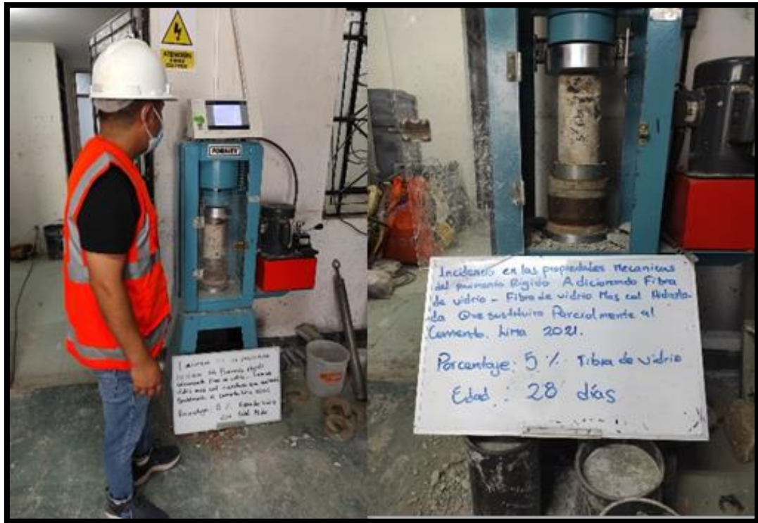
Figura 69. Rotura de las probetas con la adición del 5% de fibra de vidrio en las edades de 14 y 28 días.
