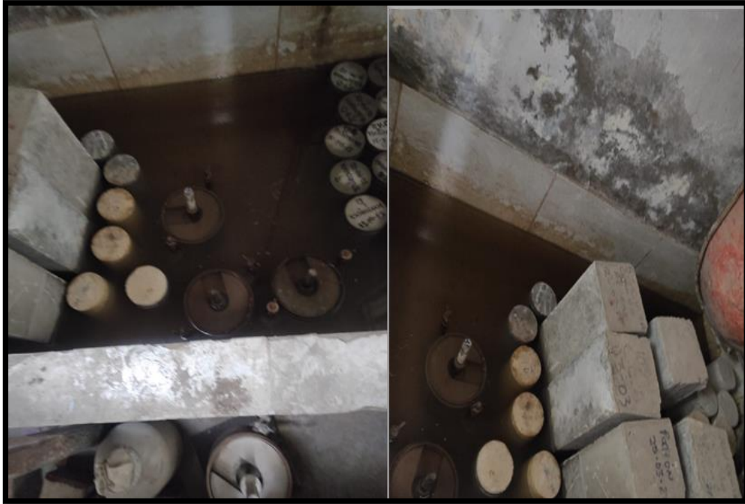
Figura 57. Proceso de curado para las probetas y vigas de concreto para las edades de 7,14 y 28 días.
