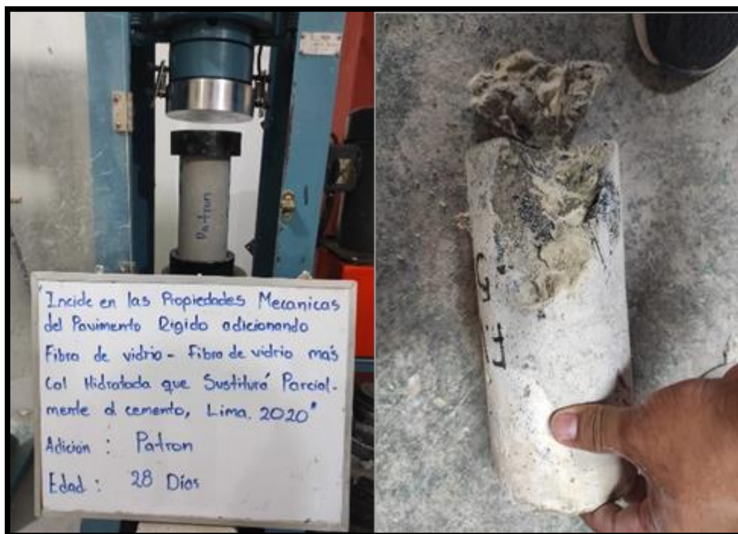
Figura 81. Rotura de las probetas de las muestras patrón y con la adición del 5% de fibra de vidrio más 10% de cal hidratada el cual sustituye parcialmente el cemento en la edad de 28 días.
