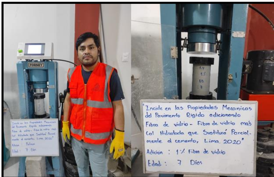
Figura 60. Rotura de la probeta de la muestra patrón y con la adición del 1% de fibra de vidrio en la edad de 7 días.
