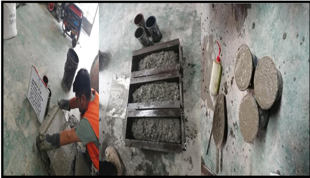
Figura 49. Proceso de chazado y vaciado en las probetas y moldes de vigas para las diferentes edades y adiciones de la fibra de vidrio- vibra de vidrio más cal hidratada.
