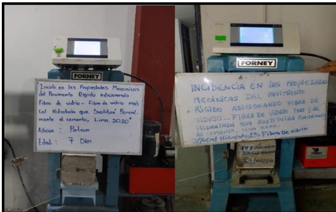
Figura 70. Rotura de las vigas patrón y además con la adición del 1% de fibra de vidrio más el 1% de cal hidratada el cual sustituye parcial mente al cemento en las edades de 7 días.
