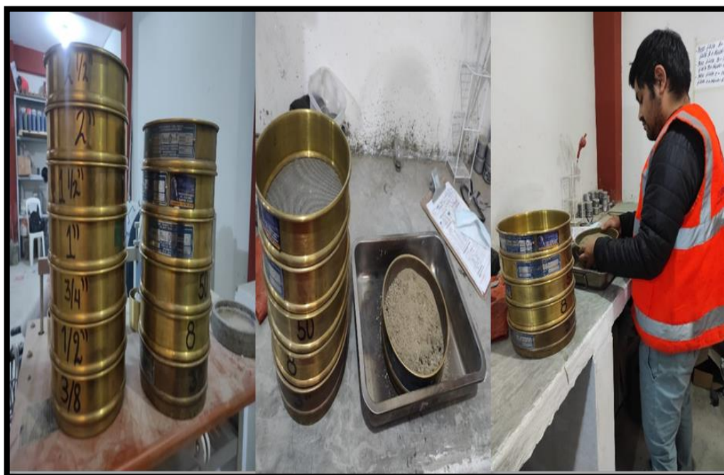
Figura 3. Ensayo de granulometría.
