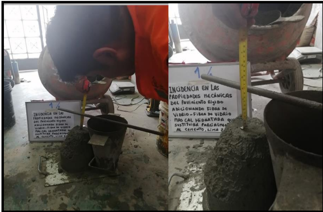
Figura 51. Procesos de medición del asentamiento del concreto en la adición del 1% de fibra de vidrio.
