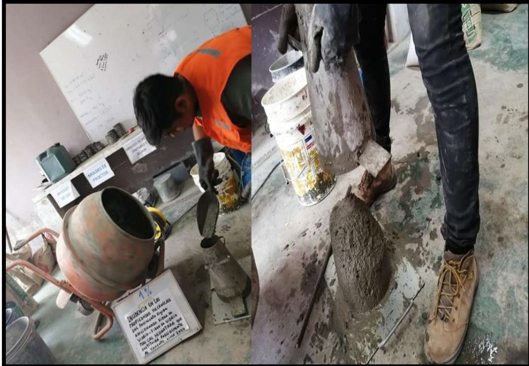
Figura 50. Procesos del ensayo de cono de habrâma para determinar el asentamiento del concreto en la adición del 1% de fibra de vidrio.
