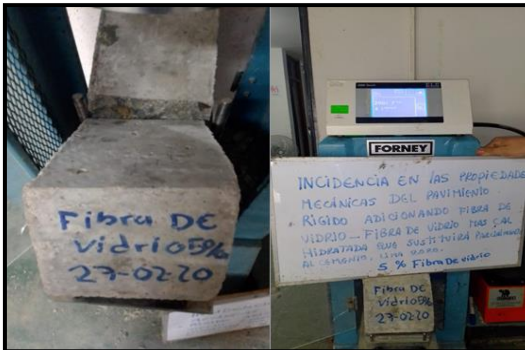
Figura 66. Rotura de la viga de la muestra patrón y con la adición del 5% de fibra de vidrio en la edad de 7 días.
