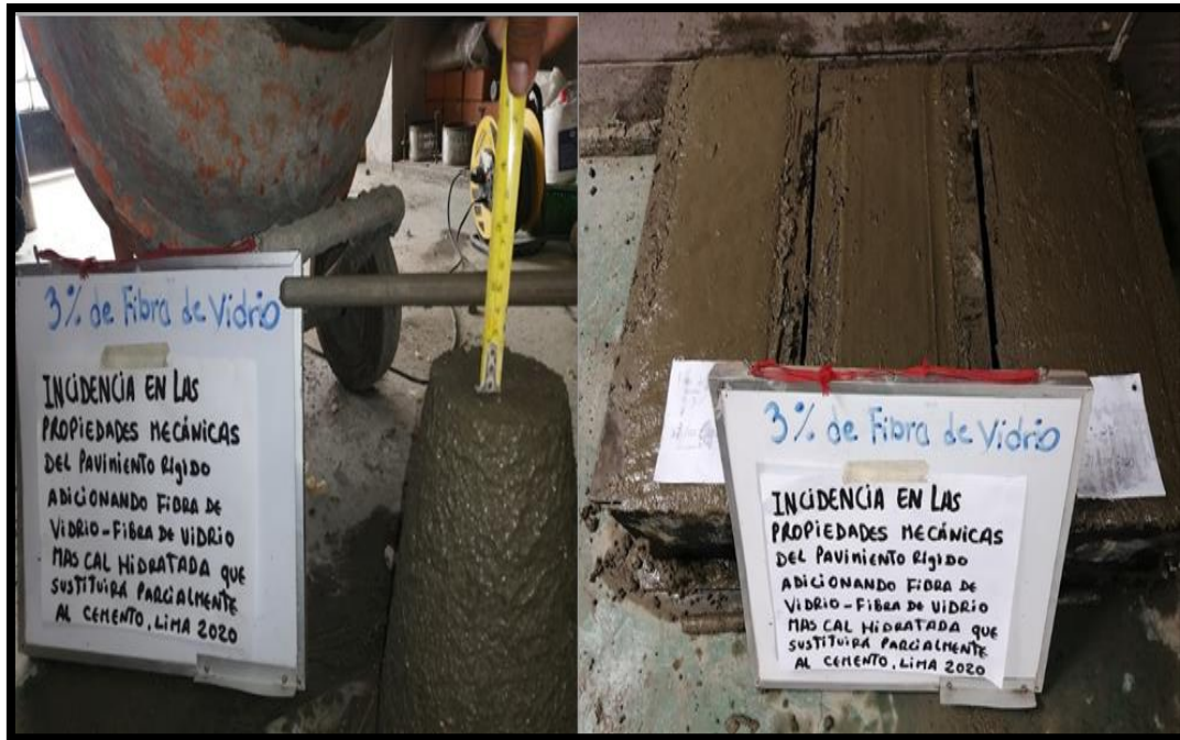
Figura 53. Procesos de medición del asentamiento del concreto en la adición del 3% de fibra de vidrio y vaciado en el molde de viga de concreto para las edades de 7, 14 y 28 días.
