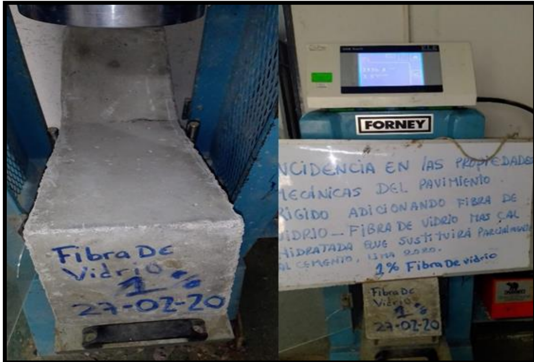
Figura 58. Rotura de la viga de la muestra patrón y con la adición del 1% de fibra de vidrio en la edad de 7 días.
