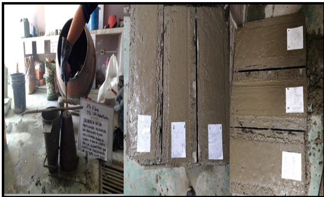
Figura 56. Procesos de medición del asentamiento del concreto en la adición del 3% de fibra de vidrio más el 5% cal hidratada, como también la adición del 5% y 10% y el vaciado en los moldes de viga de concreto para las edades de 7, 14 y 28 días.
