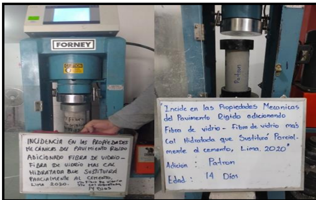
Figura 73. Rotura de las probetas de las muestras patrón y con la adición del 1% de fibra de vidrio más 1% de cal hidratada el cual sustituye parcialmente el cemento en las edades de 14 días.
