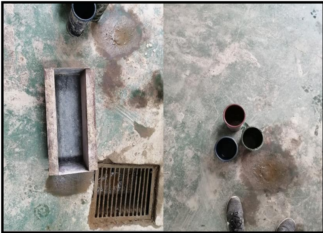
Figura 38. Molde del probetas y viga empleados en el desarrollo del proyecto.
