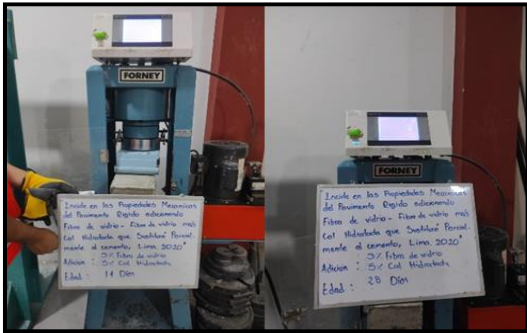
Figura 75. Rotura de las vigas con la adición del 3% de fibra de vidrio más el 5% de cal hidratada el cual sustituye parcialmente al cemento en las edades de 14 y 28 días.
