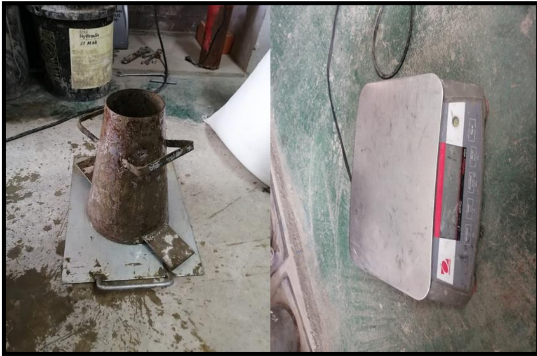
Figura 43. Cono de abramos y balanza empleados para el desarrollo del proyecto.
