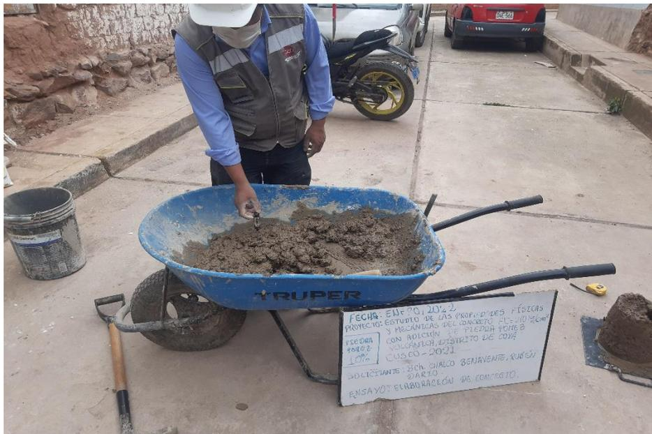
Anexo 09 Fotos de ensayo de medición del slump en concreto fresco con adición de piedra pómez volcánica
