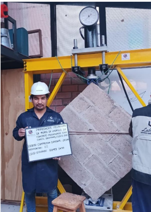
Figura 5. Colocación de murete
