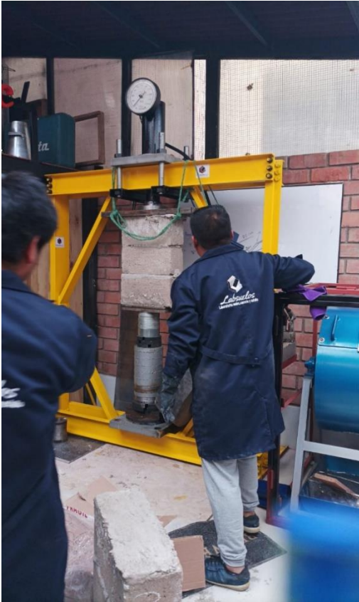
Figura 3. Colocación de pilas
