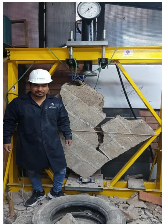
figura 6. Falla por resistencia al corte
