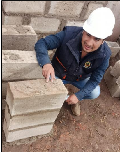
Figura 6 Pila elaborada con ladrillo de concreto modificado
