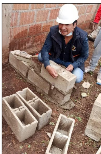
Figura 5 Espécimen de ladrillo de concreto
