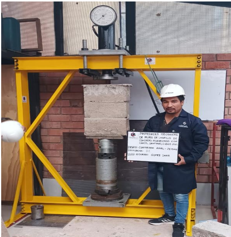
Figura 2. Ensayo a compresión axial en pilas
