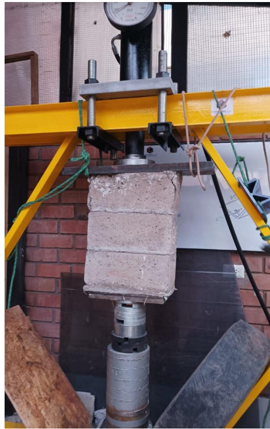
figura 4. Rotura de pilas a compresión axial
