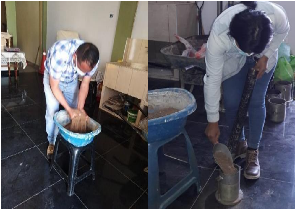
Fotografía 18: Ensayo proctor modificado (máxima densidad seca y el óptimo contenido de humedad).
