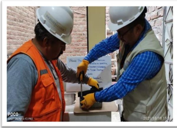
Alabeo en ladrillos de concreto ladrillo f' b
