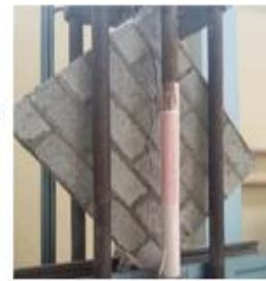
✓ Resistencia al corte diagonal Kg/ cm<sup>2</sup>
