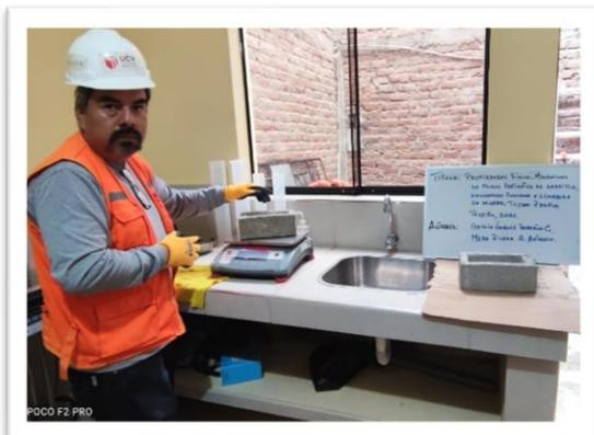
Ensayo de densidad y absorción
