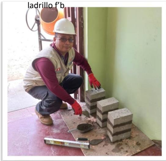
Fabricación de pilas de ladrillos
