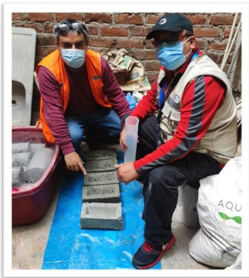
Curado de ladrillos de concreto ensayarlos
