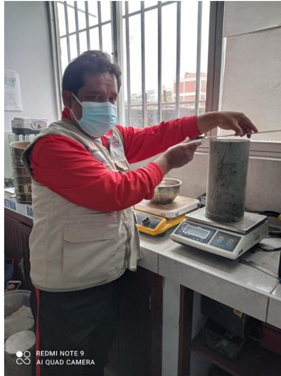
FIG 21. PESADO DE PROBETAS
