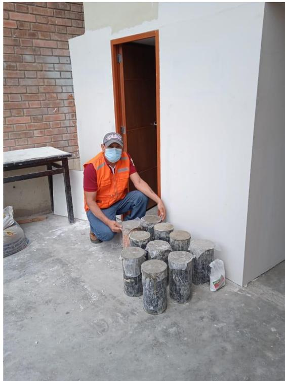
FIG 18. PROBETAS LISTAS PARA EL SECADO Y CURADO
