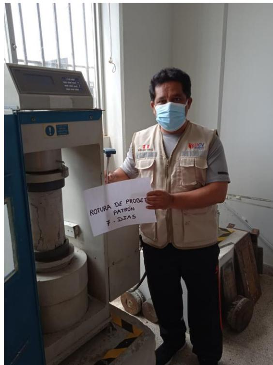
FIG 22. ENSAYO DE RESISTENCIA A LA COMPRESION A 7 DIAS
