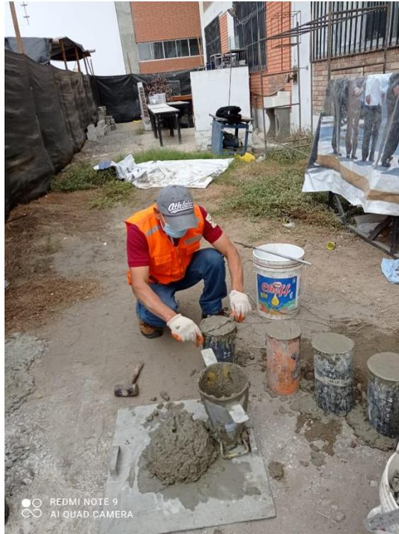
FIG 17. LLENAD DE PROBETAS
