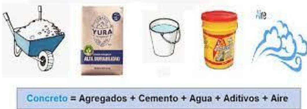
Figura 4. Elementos del concreto
