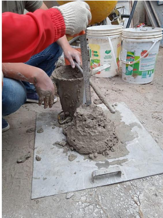
FIG 15. ENSAYO DE ASENTAMIENTO
