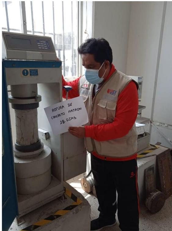
FIG 24. ENSAYO DE LA RESISTENCIA A LA COMPRESIÓN A 28 DIAS
