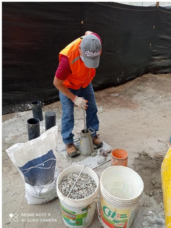
FIG 12. PRIMERA CAPA PARA ENSAYO DE SLUMP
