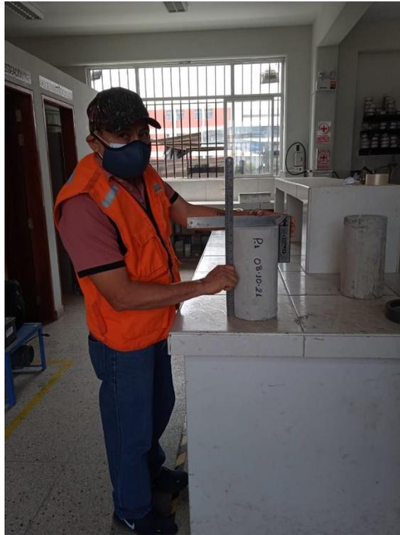
FIG 19. TOMA DE MEDIDAS DE PROBETAS
