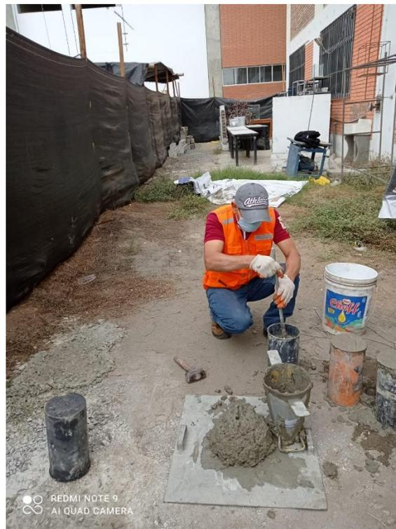
FIG 16. CHUZEANDO LA MEZCLA PARA EL LLENADO DE PROBETAS
