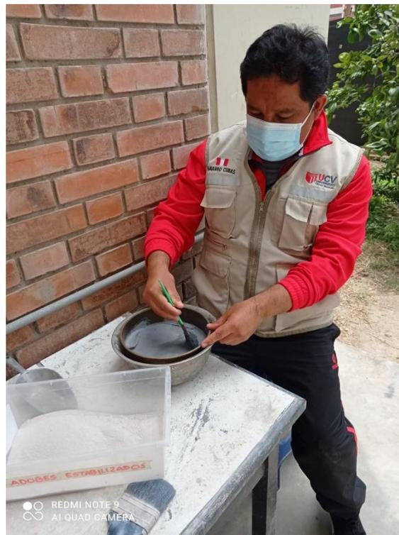
FIG 6. TAMIZADO DEL POLVO DE MÁRMOL
