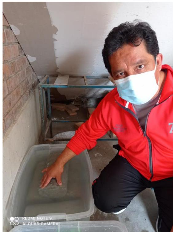
FIG 20. CURADO DE PROBETAS DE CONCRETO
