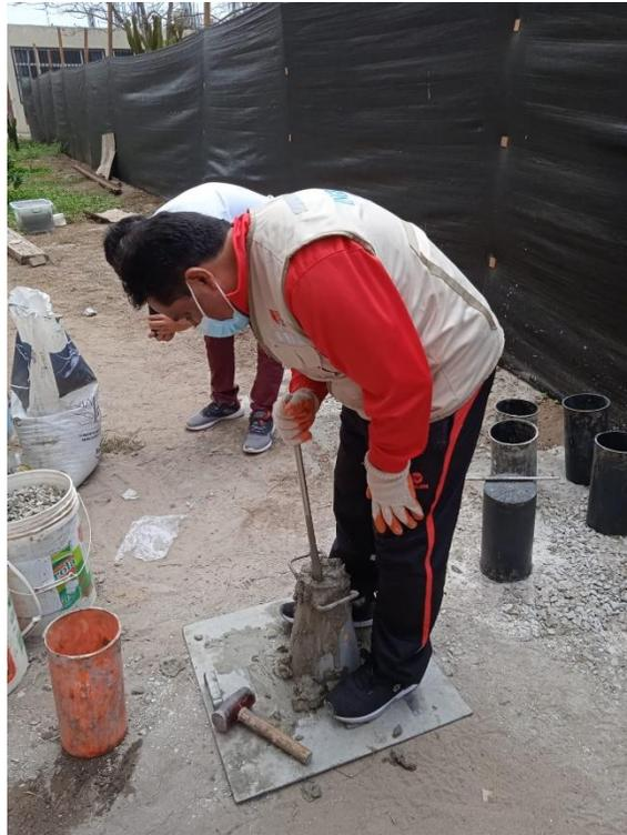
FIG 13. CHUZEANDO LA MEZCLA PARA EL ENSAYO DE ASENTAMIENTO
