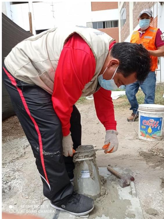
FIG 14. ENRAZANDO LA MEZCLA EN EL CONO
