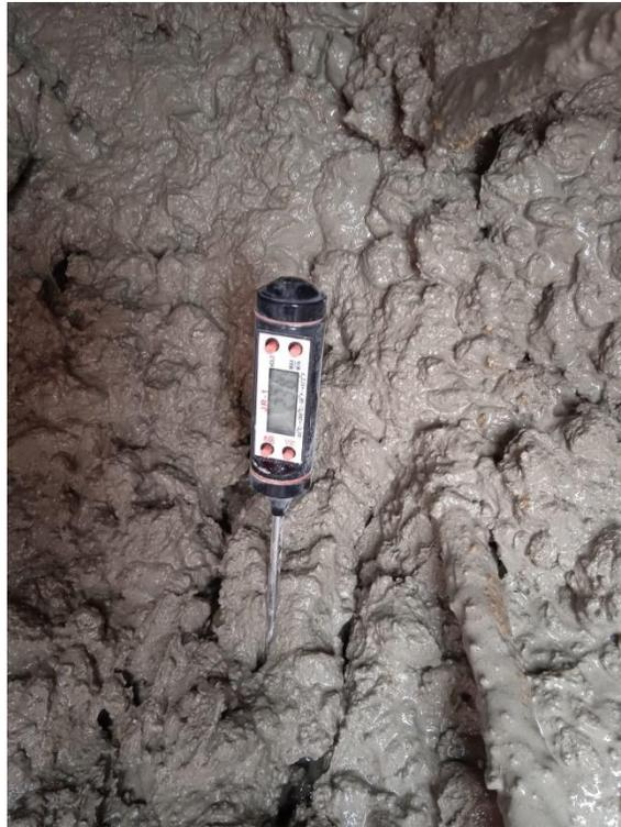
FIG 11. TEMPERATURA DE MEZCLA
