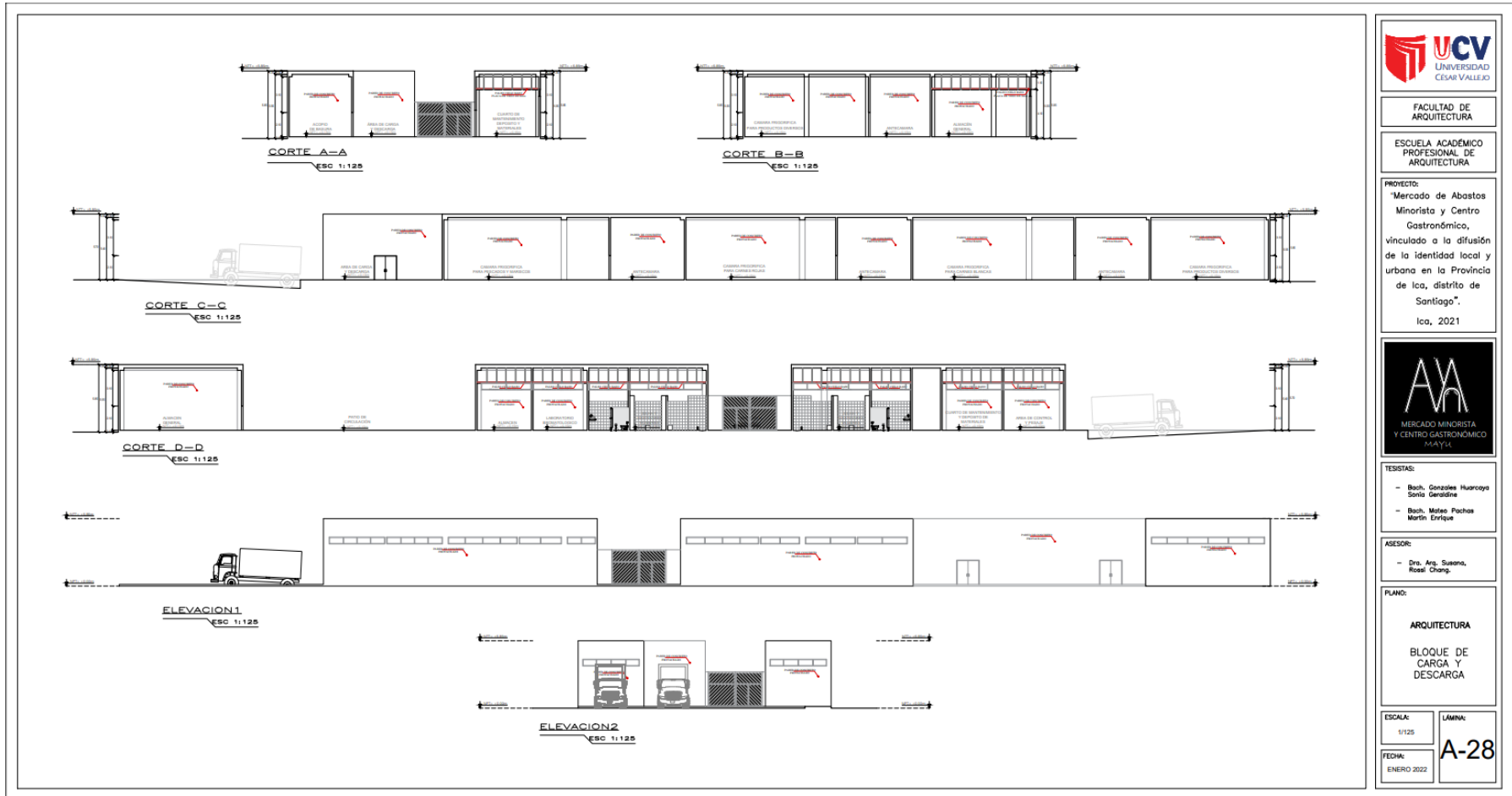
Gráfico 30: Bloque almacén y servicios – Elevaciones y cortes.
