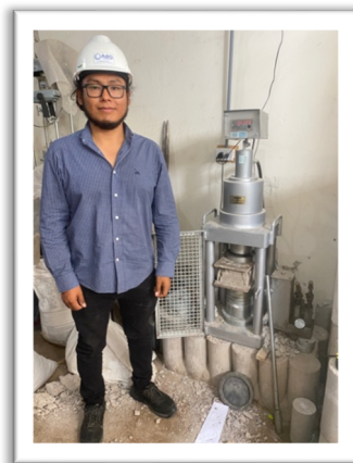
Figura 30: Ensayo de Compresión simple
