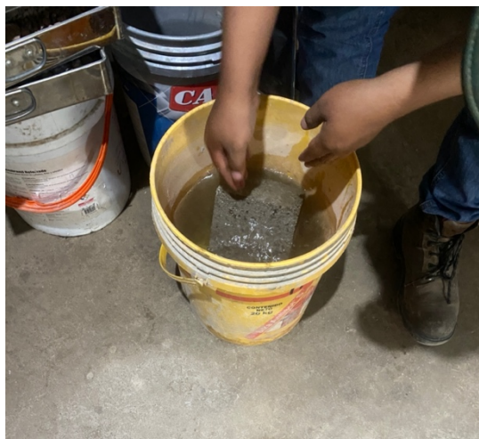
Figura 60: Absorción del ladrillo
