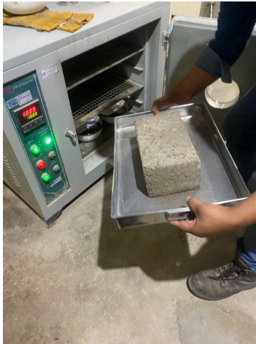
Figura 61: Absorción del ladrillo - secado
