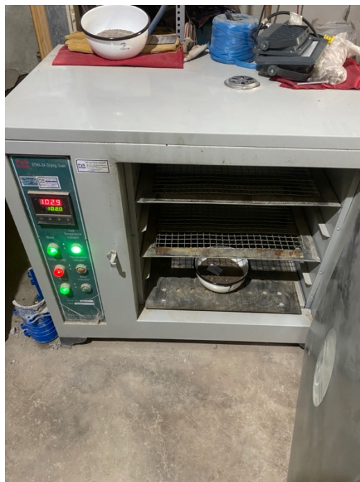
Figura 54: Horno - Analisis granulometrico de agregados
