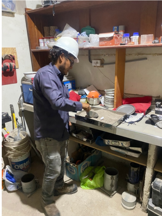
Figura 55: Analisis granulometrico de agregados
