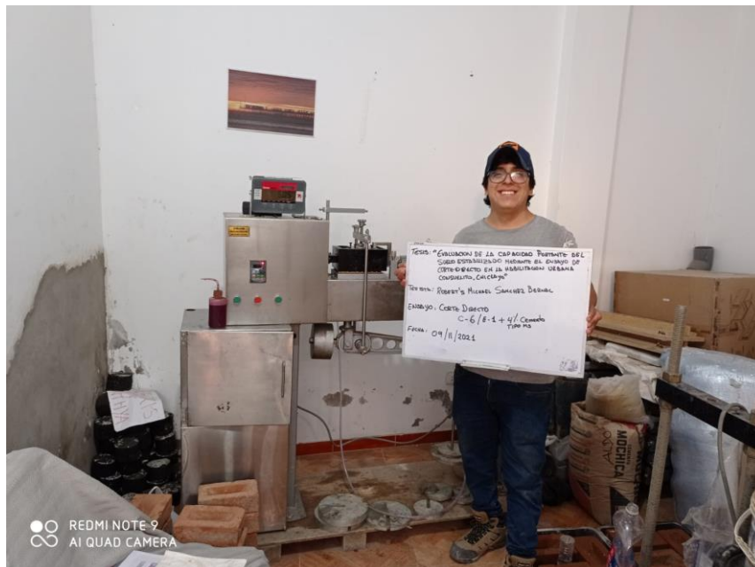
Foto 4: Ensayo de corte directo C6 – E1 + 4% cemento tipo MS Fuente: Elaboración propia
