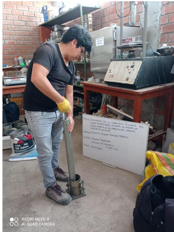
Foto 3: Ensayo de Proctor modificado C4 – E1 + 8% cal Fuente: Elaboración propia
