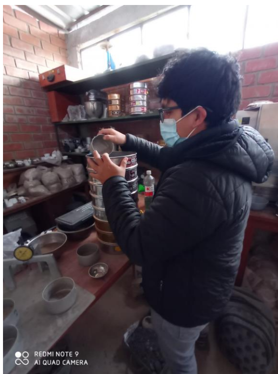
Foto 2: Análisis granulométrico (tamizando muestras) Fuente: Elaboración propia
