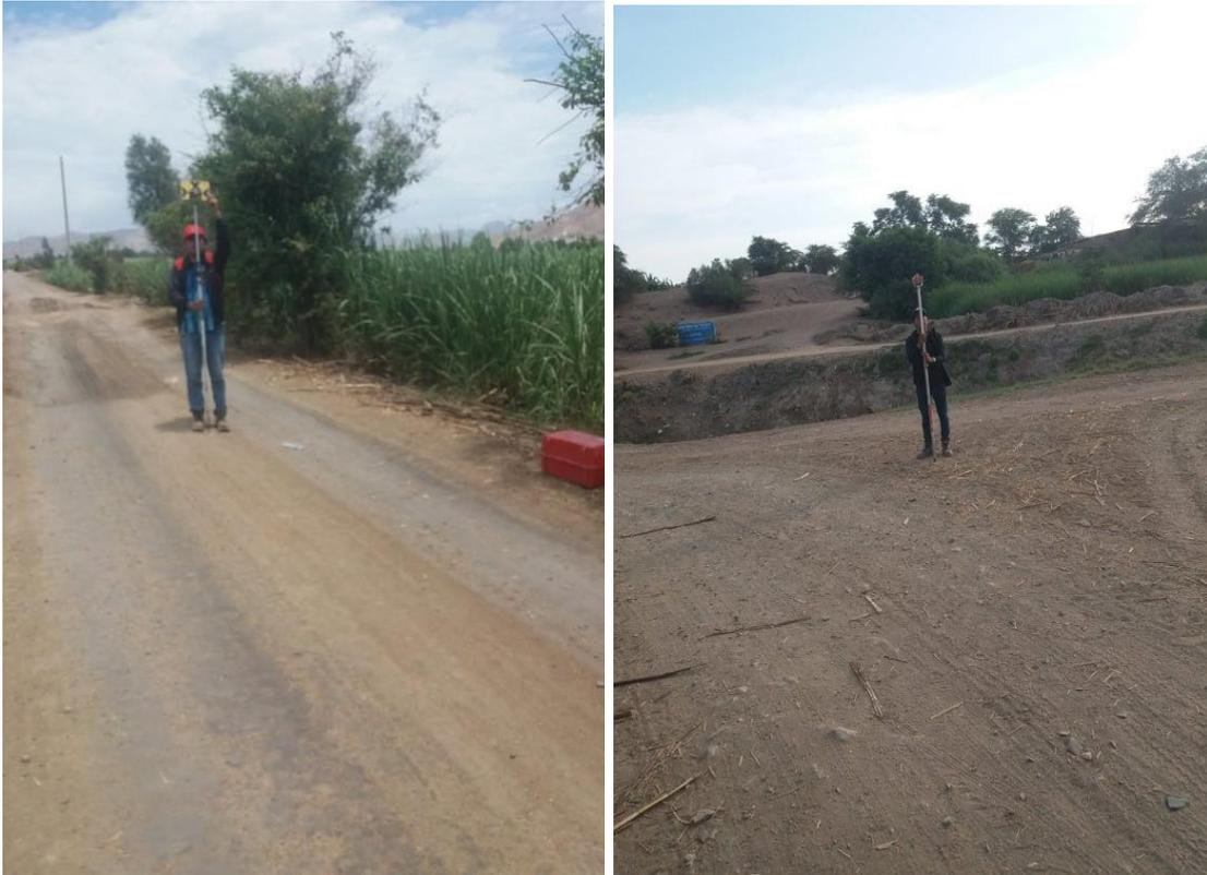
*Figura 16.* Colocación del prisma para el levantamiento topográfico
