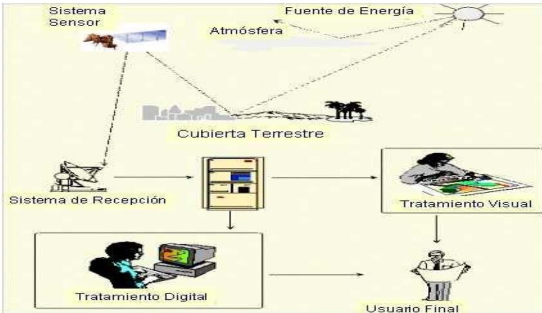
**Figura 2.** Componentes de un sistema de teledetección. (CHUVIECO, 2000).
