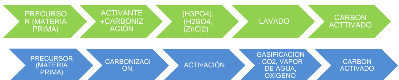
Figura 1. Métodos de Activación de elaboración de Carbón Activado Fuente: Elaboración Propia
