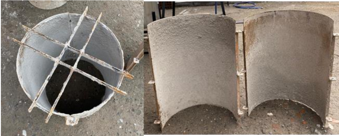
Figura 4. Moldes para la elaboración de las briquetas.
