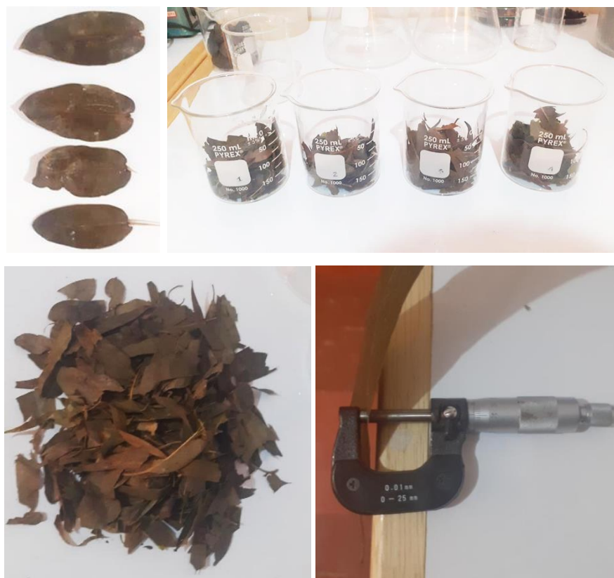
Figura 2. Muestras para la medición de características organolépticas y físicas de los residuos de eucalipto.
