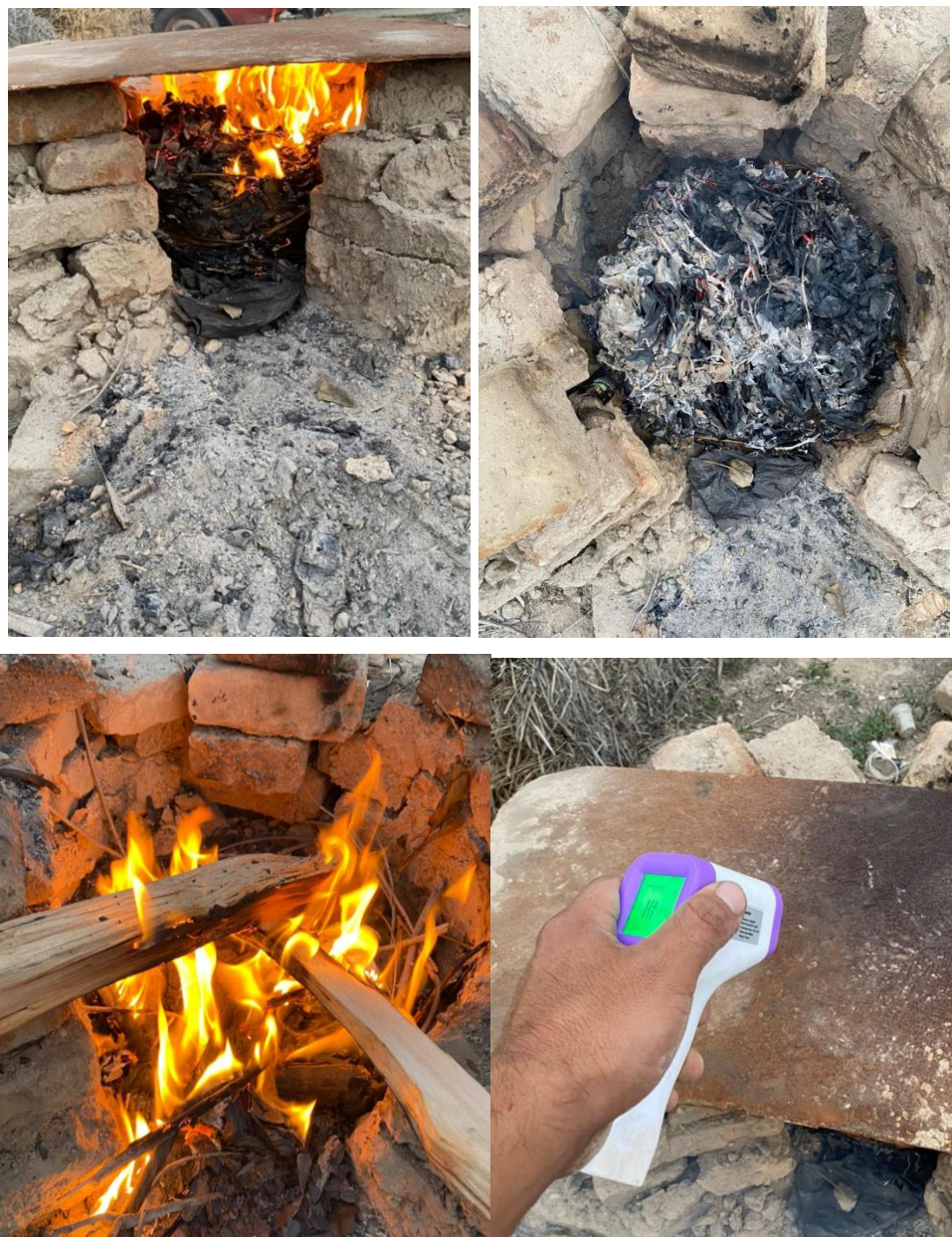
Figura 8. Análisis del tiempo y temperatura de combustión de las briquetas.
