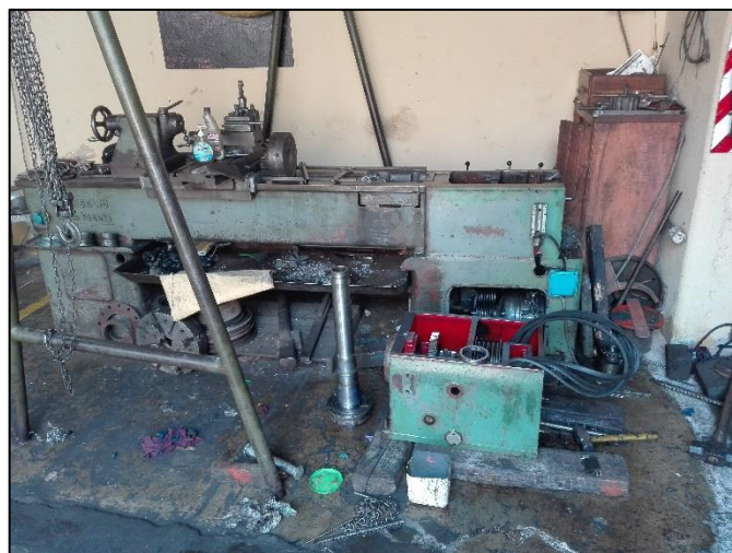
Figura 14. Reparación del torno
