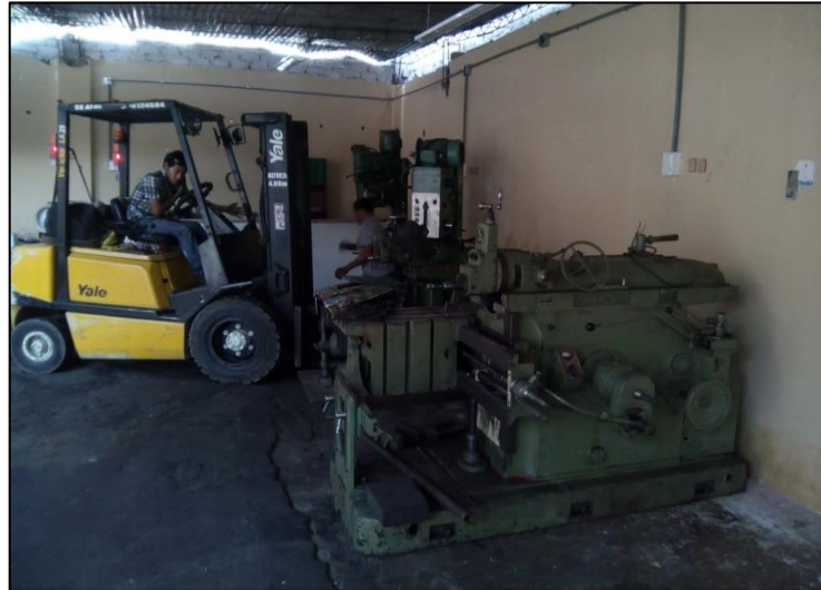
Figura 9. Operario de montacargas sin el uso de Epp's.
