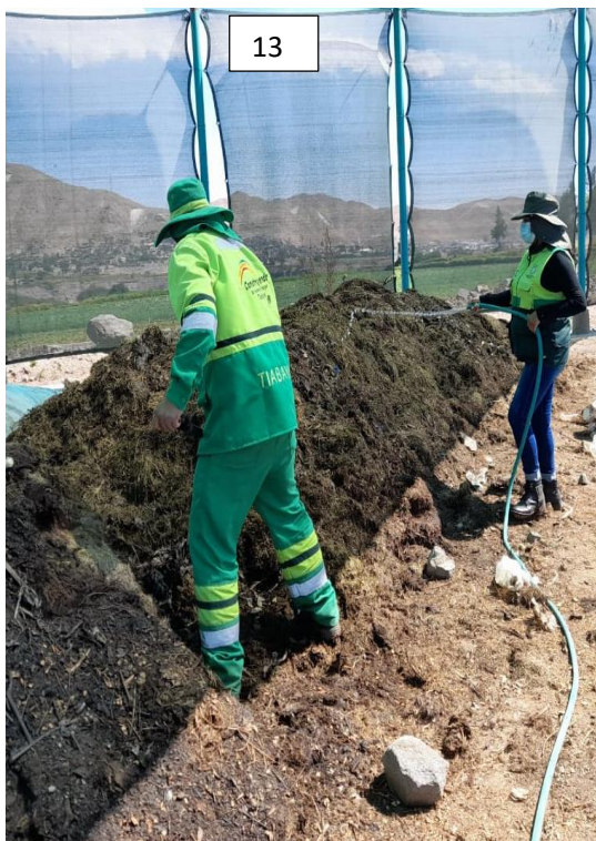
Imagen 13 y 14: Volteo manual de pilas de en proceso de compostaje
