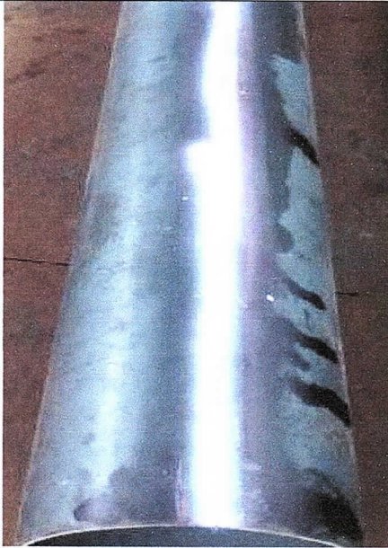
Tubería ciega con el líquido penetrante.
