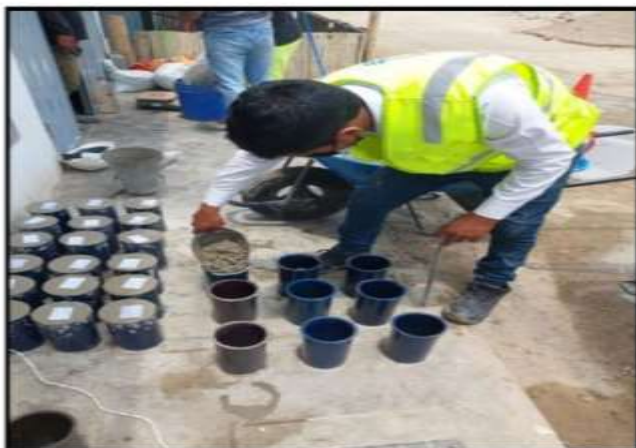
Figura N° 8: Preparación de probetas 4"x8" de concreto. Norma ASTM C 39
