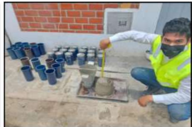
Figura N° 7: Asentamiento correcto 3 3/4", dentro del rango Plastico (3"- 4")
