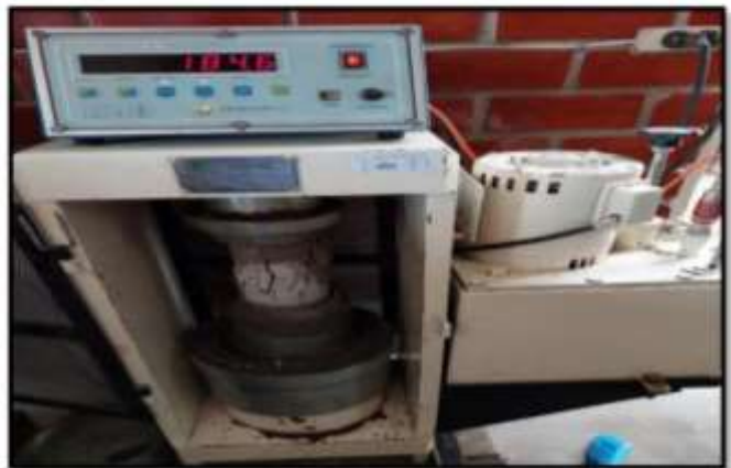
Figura N° 15: Rotura de Probeta a los 14 días, de la Propuesta I. FALLA TIPO 3 (GRIETAS ACOLUMNADO VERTICAL)
