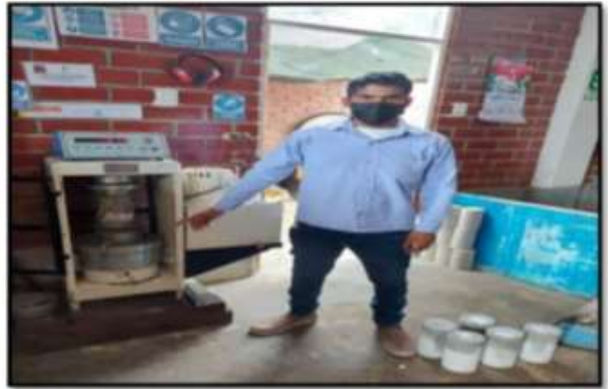
Figura N° 21: Rotura de Probeta a los 14 días, de la Propuesta III. FALLA TIPO 3 (GRIETAS ACOLUMNADO VERTICAL)
