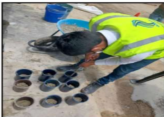
Figura N° 10: Chuseo con varilla de 5/8" en 3 capas de 25 golpes
