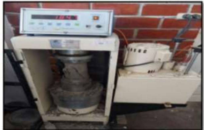
Figura N° 23: Rotura de Probeta a los 7 días, de la Propuesta IV. FALLA TIPO 3 (GRIETAS ACOLUMNADO VERTICAL)
