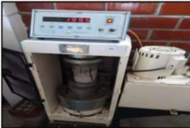
Figura N° 22: Rotura de Probeta a los 28 días, de la Propuesta III. FALLA TIPO 3 (GRIETAS ACOLUMNADO VERTICAL)
