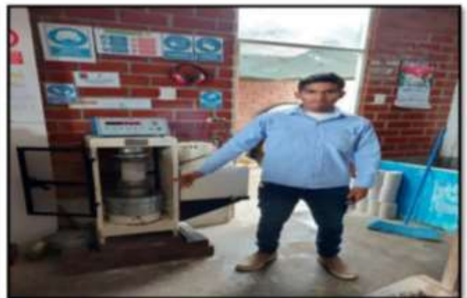
Figura N° 25: Rotura de Probeta a los 14 días, de la Propuesta IV. FALLA TIPO 2 (GRIETAS VERTICALES)
