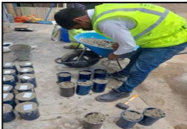
Figura N° 11: Chuseo de tercera capa en las probetas 4"x8" de concreto
