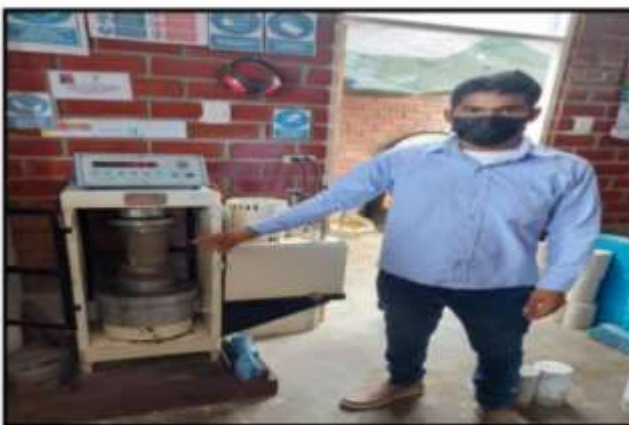
Figura N° 18: Rotura de Probeta a los 14 días, de la Propuesta II. TIPO 4 (FRACTURA DIAGONAL SIN AGRIETARSE)
