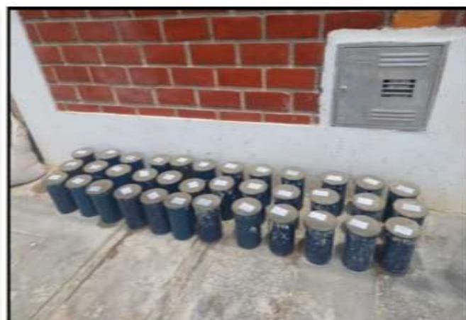
Figura N° 13: Preparación de 36 Probetas de concreto, para propuestas I, II, III, IV
