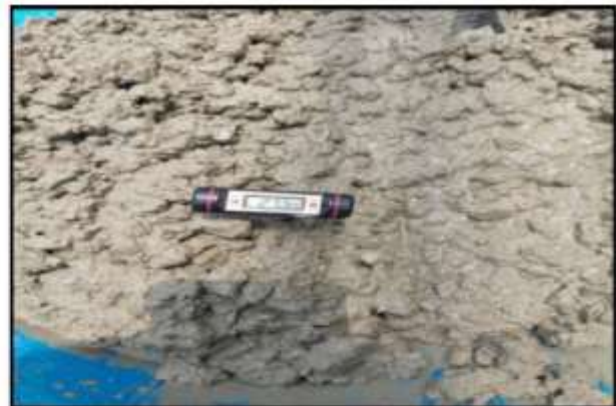
Figura N° 5: Control de Temperatura del Concreto en estado fresco.
