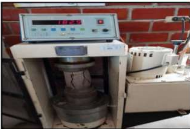
Figura N° 16: Rotura de Probeta a los 14 días, de la Propuesta I. FALLA TIPO 3 (GRIETAS ACOLUMNADO VERTICAL)
