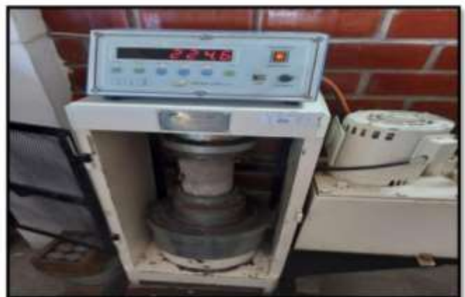
Figura N° 19: Rotura de Probeta a los 28 días, de la Propuesta II. FALLA TIPO 5 (FRACTURAS LATERALES EN LA PARTE FONDO)
