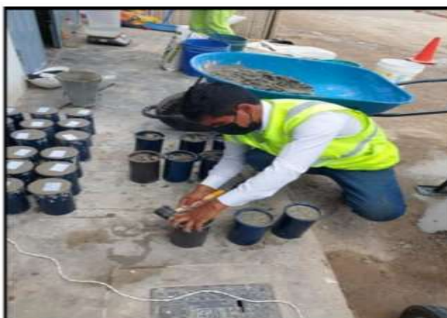
Figura N° 12: Eliminación de aire en la tercera capa de las probetas 4"x8"
