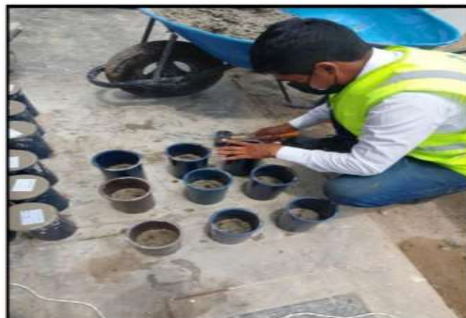
Figura N° 9: Eliminación de aire en la preparación de probetas 4"x8"
