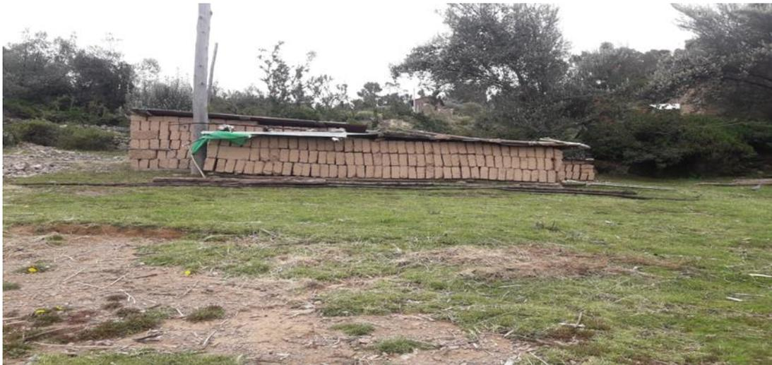
FOTOGRAFÍA N° 04: Bloques de adobe utilizados en la construcción de las viviendas de dos niveles en la parcialidad de Japisse del centro poblado Mallco- Puno.
