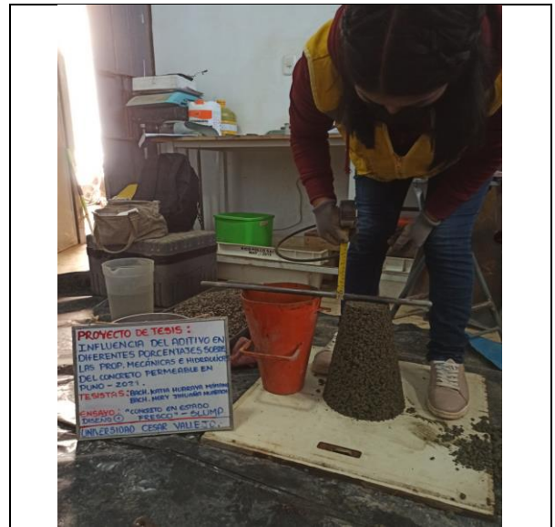
FOTO N°02: Procedimiento para la verificación de la consistencia de la mezcla (slump)
