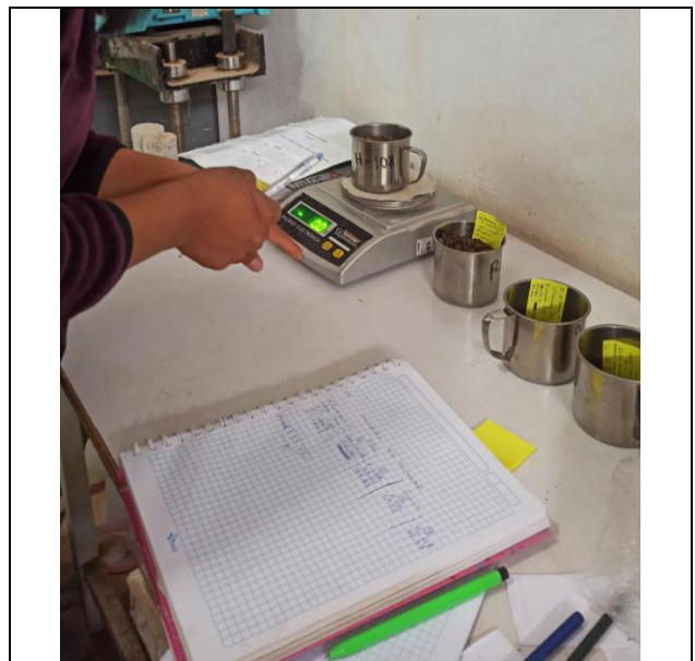
FOTO N°04: Se registro los pesos de cada tara y de la muestra+tara
