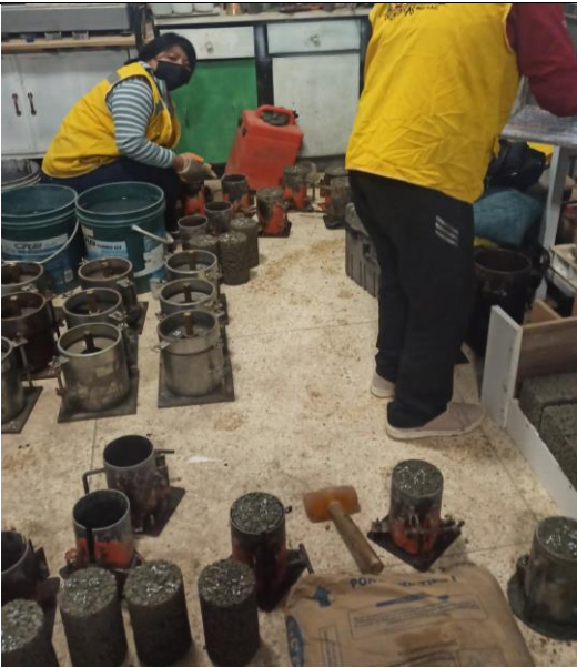
FOTO N°07: Procedimiento de Codificación de especímenes según diseño
