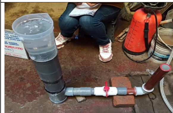
FOTO N°05: Permeámetro cargado de agua hasta la altura h1 para realizar el ensayo.
