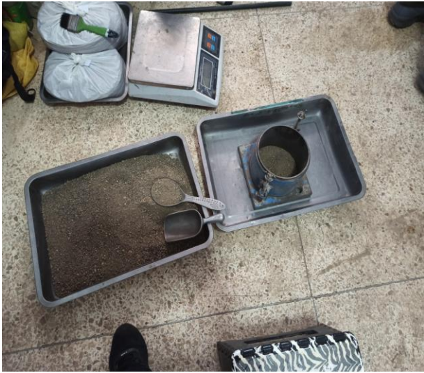
FOTO N°01: Introducimos la mezcla del concreto permeable en tres capas iguales, se compacta con la varilla lisa de 5/8" 20 veces por capa.
