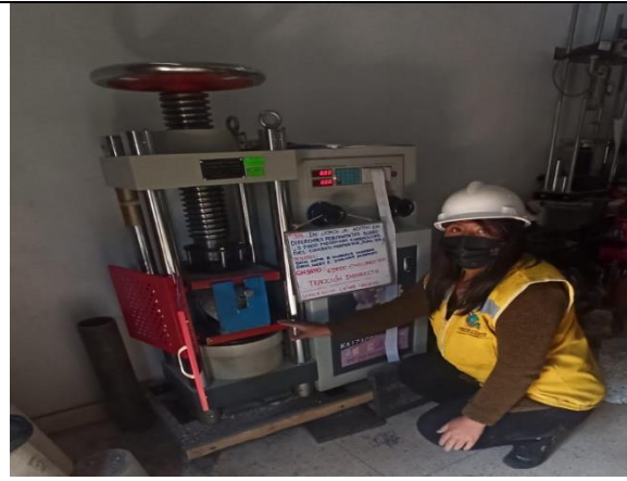
FOTO N°02: Colocar el cilindro en el equipo de tracción indirecta
