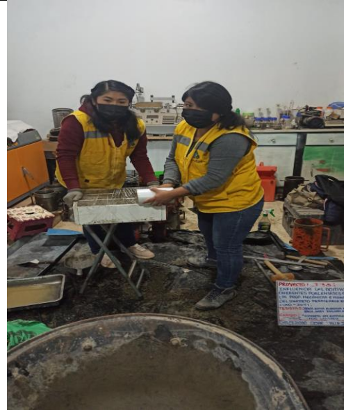
FOTO N°06: procedimiento de nivelación el borde de la viga con la varilla y cubrimos con plástico film, para evitar pérdida de agua.
