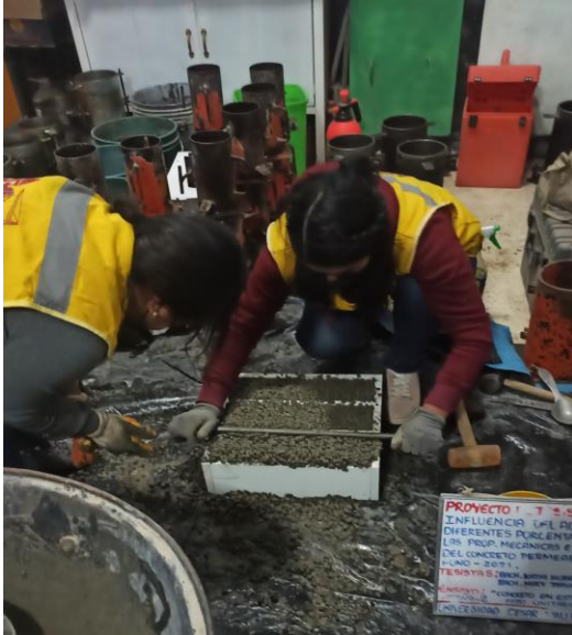
FOTO N°05: verter las mezclas hasta la mitad del molde y compactar con la varilla 28 veces en toda el área del molde
