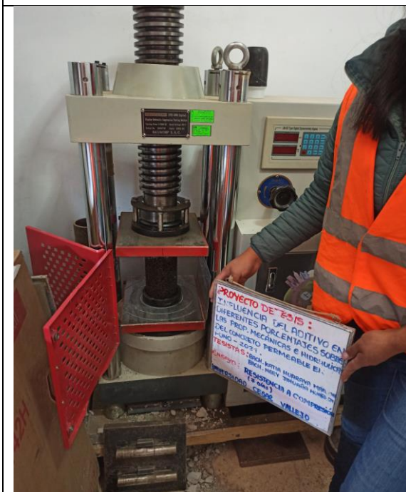
FOTO N°03: Introducimos los cilindros en la prensa hidráulica alineándolo al eje central.
