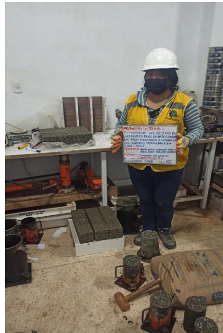
FOTO N°02: Los especímenes para flexion se procedió a colocarlo en baldes cubriéndolo totalmente para su curado
