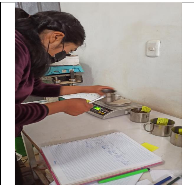
FOTO N°03: Se procedió a pesar la muestra y posterior llevarla al horno del laboratorio
