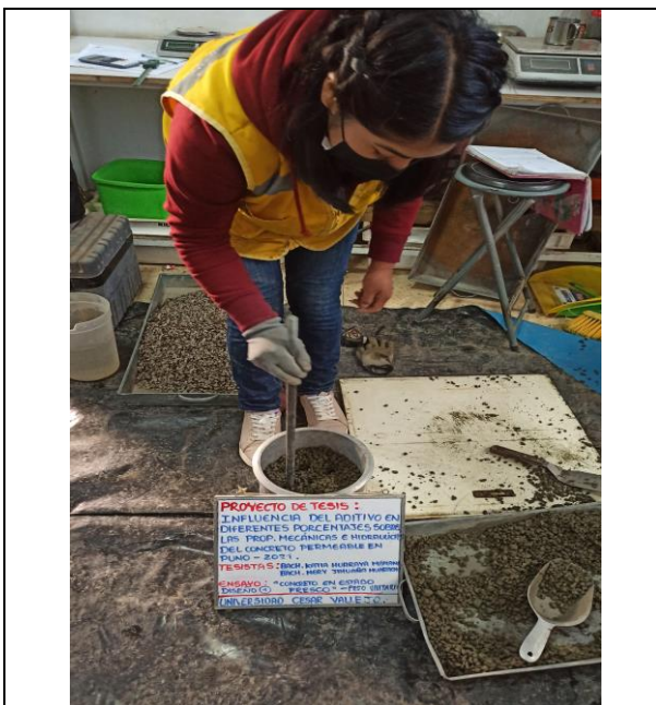
FOTO N°03: Para el P.U de la mezcla se realiza en tres capas iguales, se compacta con la varilla lisa de 5/8" 20 veces por capa
