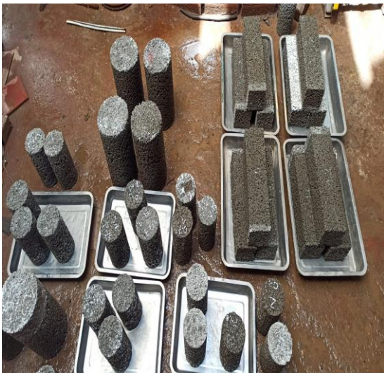
FOTO N°03: Especímenes de ensayo después de los 28 días de curado
