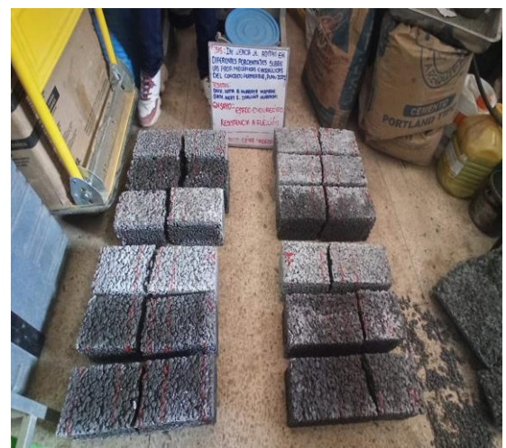
FOTO N°04: Rotura de vigas de los 04 diseños
