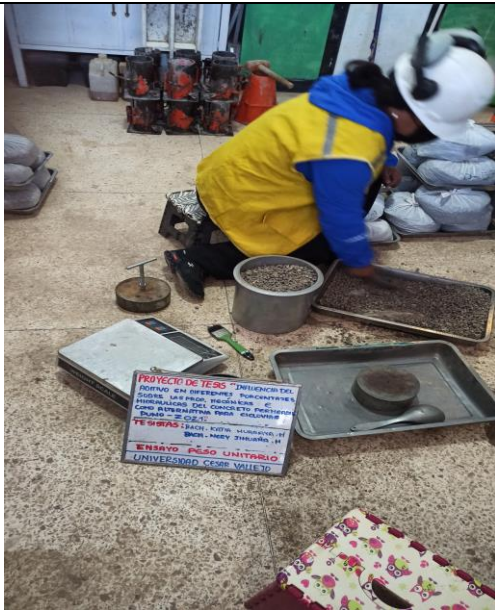
FOTO N°03: Al llenar la última capa se deberá exceder en 3 mm sobre el borde de la olla y se procede a compactar
