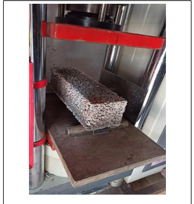
FOTO N°02: Seguidamente se procedió a marcar los tercios de la viga.
