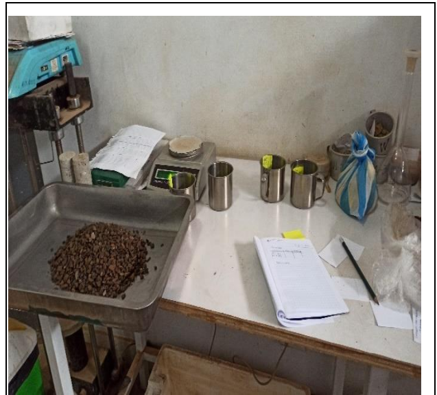
FOTO N°02: Se colocaron las muestras de agregado grueso en los recipientes – rotulando cada uno.
