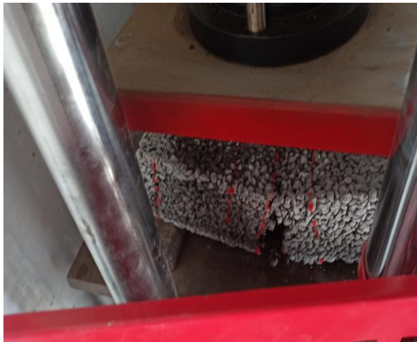
FOTO N°03: Identificación donde ocurrió la fractura
