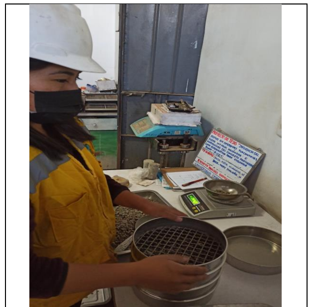
FOTO N°04: Con los datos se procedió a determinar el porcentaje pasante en cada tamiz.
