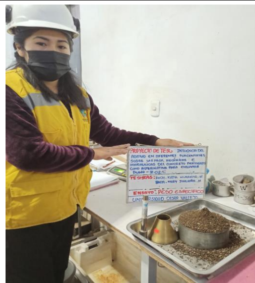
FOTO N°02: Usamos el molde cónico, se toma el material y se rellena en tres capas de igual altura en el cono, con 25 número de golpes en total
