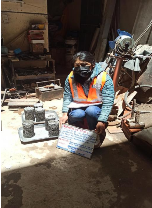
FOTO N°01: Los especímenes para compresión se procedió a colocarlo en baldes cubriéndolo totalmente para su curado
