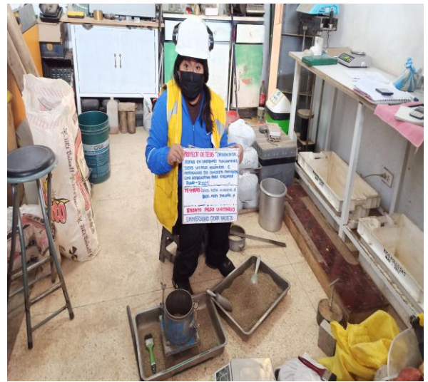
FOTO N°02: Al llenar la última capa se deberá exceder en 3 mm sobre el borde de la olla y se procede a compactar
