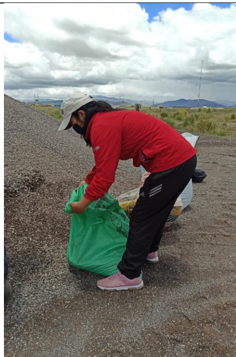
FOTO N°04: Acumulación en sacos de cantidades del agregado grueso.
