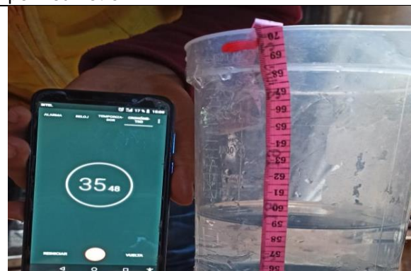
FOTO N°06: Tomando el tiempo que transcurre en pasar el agua de h1 a h2 por el medio poroso.
