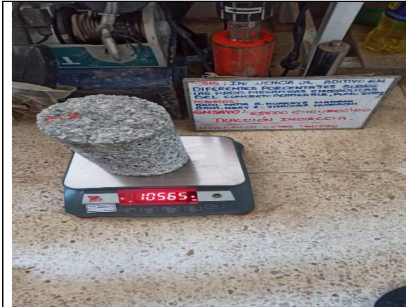
FOTO N°01: Tomando el peso a las muestras cilíndricas de 15x30cm
