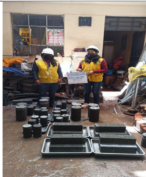
FOTO N°04: Se procedió a sacar los especímenes para poder empezar con los ensayos de rotura y permeabilidad
