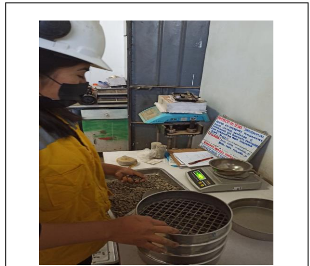
FOTO N°02: Luego se pasó en una serie de tamices de orden descendiente para después pesar lo retenido en cada malla.
