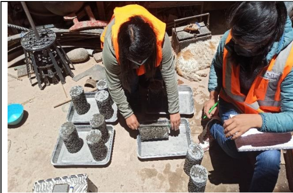
FOTO N°01: Tomando las medidas a las muestras como diámetro y altura.
