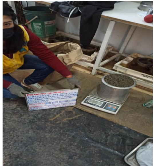
FOTO N°04: Por último, con una brocha se limpia los excesos y se lleva a la balanza para registrar su peso
