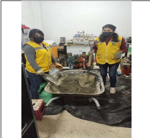
FOTO N°01: Se realiza la mezcla en una carretilla añadiendo los componentes por cada diseño se realizo tanda.
