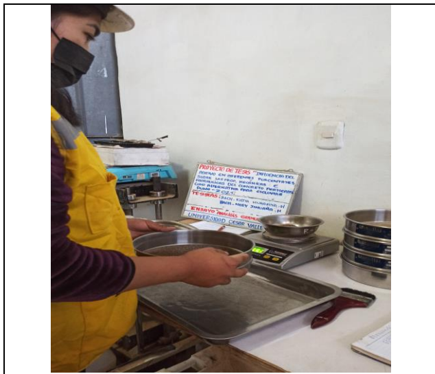
FOTO N°01: Para el ensayo se utilizó 500 gr de agregado fino y 3500gr de agregado grueso.
