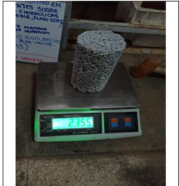
FOTO N°02: Procedimos a tomar el peso del espécimen.
