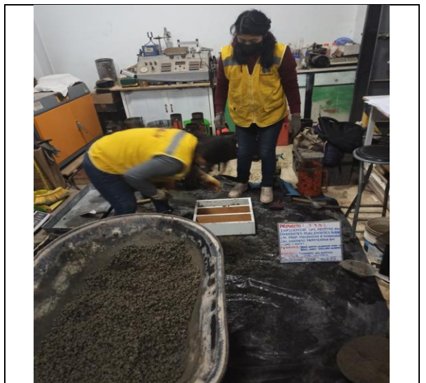
FOTO N°04: Procedimiento de invertir al molde de viguetas con dimensiones 10cm de ancho por 10cm de altura por 36cm de largo.
