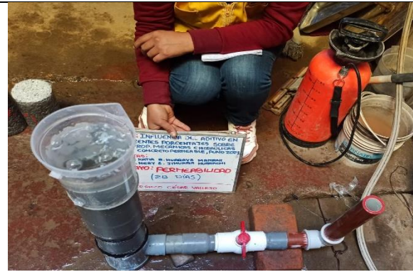
FOTO N°02: Muestras envueltas con plástico film para el ensayo de permeabilidad.
