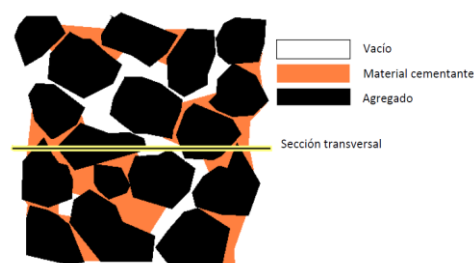
Figura 1: Estructura interna de un c° permeable.
