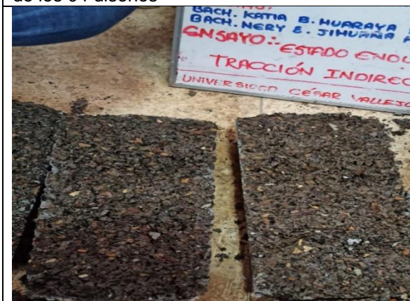
FOTO N°05: Comparación del diseño 03 y 04 en el porcentaje de partículas fracturadas que indica adherencia del espécimen
