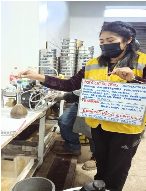
FOTO N°03: Se introdujo en una fiola de volumen conocido para determinar su peso sumergido sacando todos los espacios vacíos de la muestra
