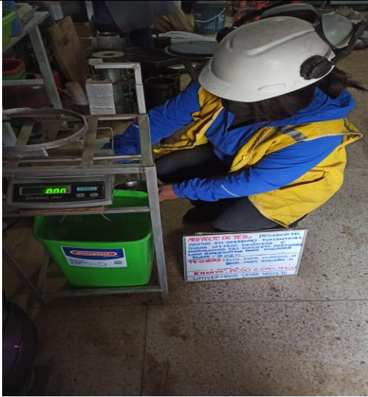
FOTO N°01: Se tomo una muestra de 800 gr en la condición sss. Luego inmediatamente se sumergió la muestra en agua para determinar su peso sumergido dentro de una canastilla de metal
