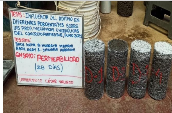
FOTO N°02: Muestras envueltas con plástico film para el ensayo de permeabilidad.
