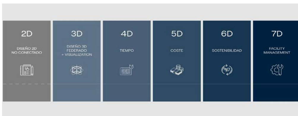
Figura 6. Las 7 dimensiones del BIM.
