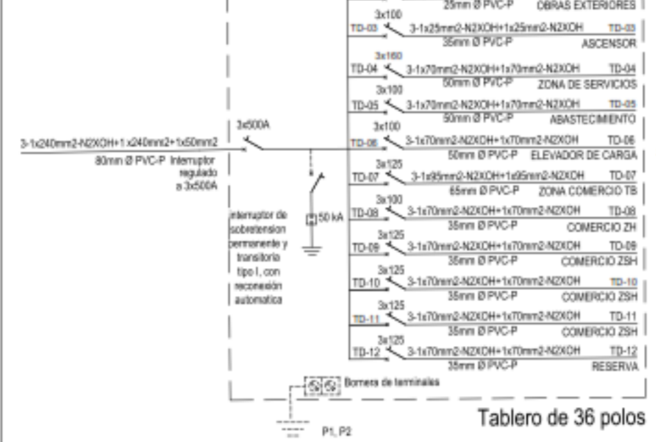
DIAGRAMA UNIFILAR PRIMER NIVEL TABLERO TG-01
