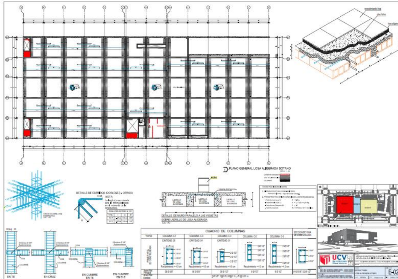
Figura 60 Planos de estructura de losas y techos
