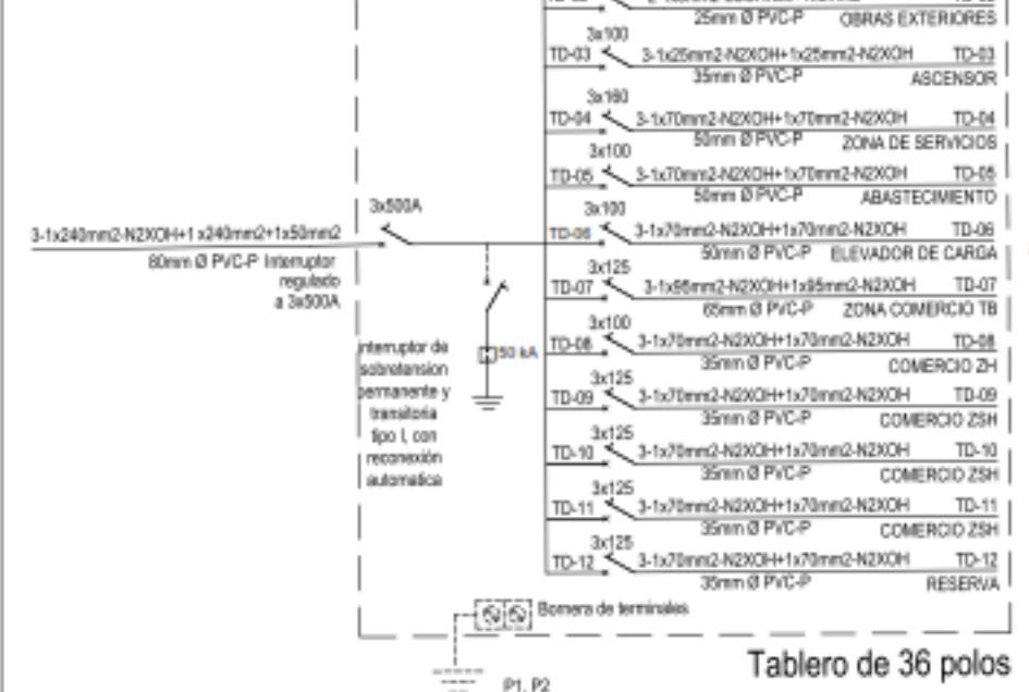
DIAGRAMA UNIFILAR PRIMER NIVEL TABLERO TG-01
