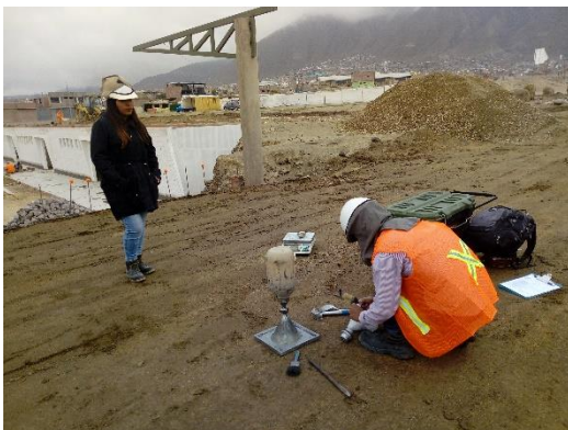
Pruebas de densidad para comprobación de cumplimiento de humedad
