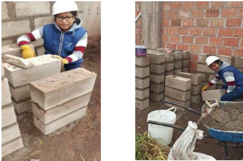
Figura 24: Preparación de pilas
