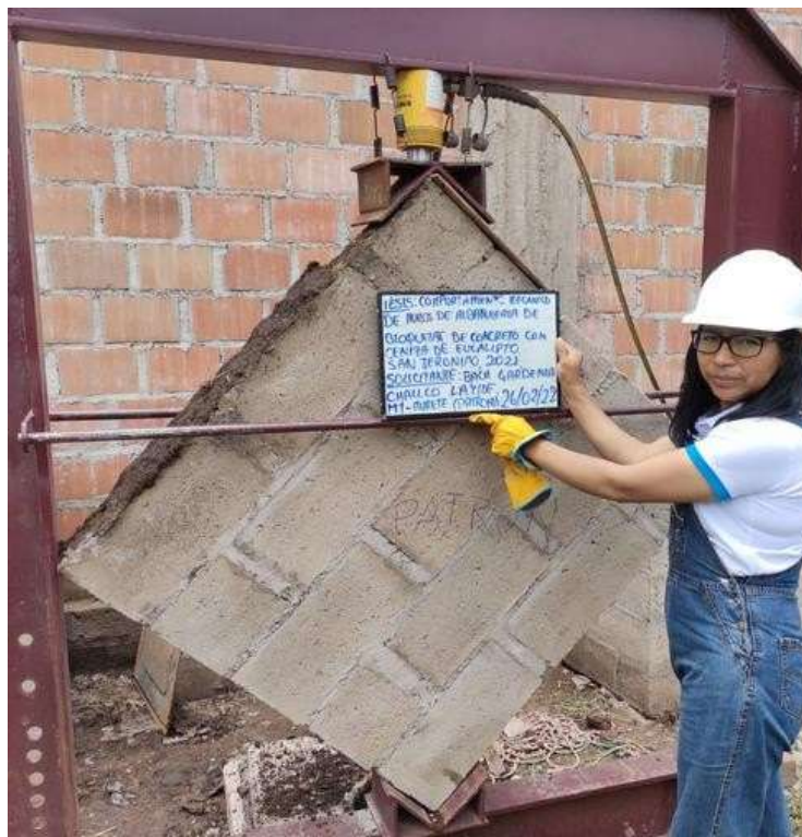
Figura 26: Ensayo de compresión diagonal
