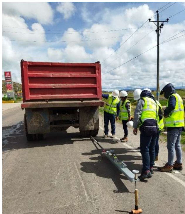
Fotografía 06. Instalación de la viga Benkelman
