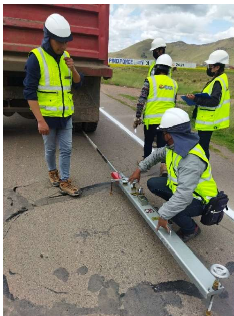
Figura 32: Medición de la deflexión
