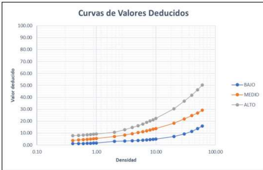
Figura 23: Valor deducido grieta de borde
