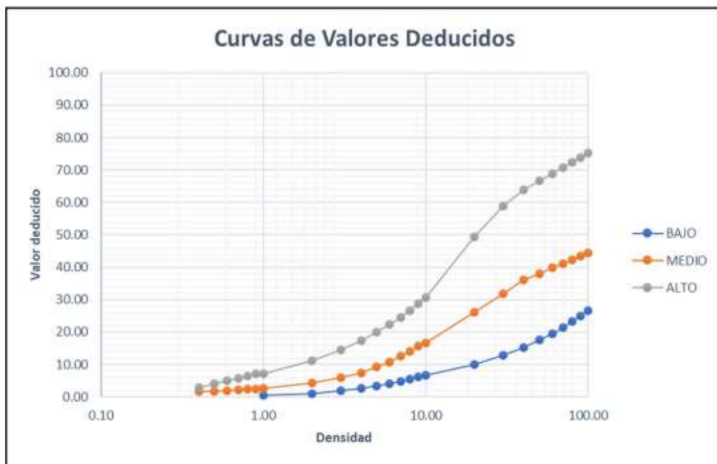
Figura 24: Valor deducido grieta de deflexión de junta
