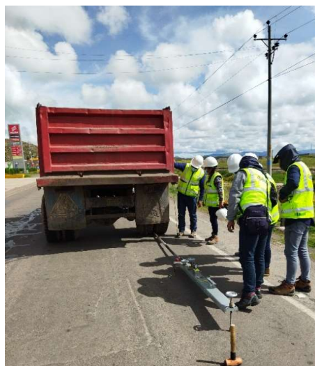
Figura 31: Colocación la viga Benkelman al eje de rueda
