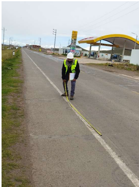
Fotografía 04. Identificación de Daños grieta longitudinal y transversal
