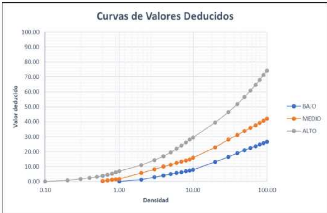
Figura 21: Valor deducido Agrietamiento en bloque.
