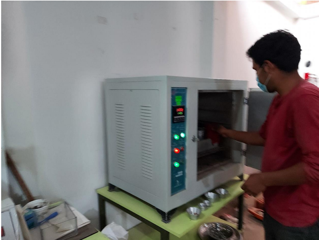
Acondicionamiento del cemento asfáltico para ser utilizado
