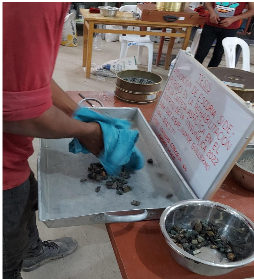
Secado de agregado grueso para hallar la gravedad especifica
