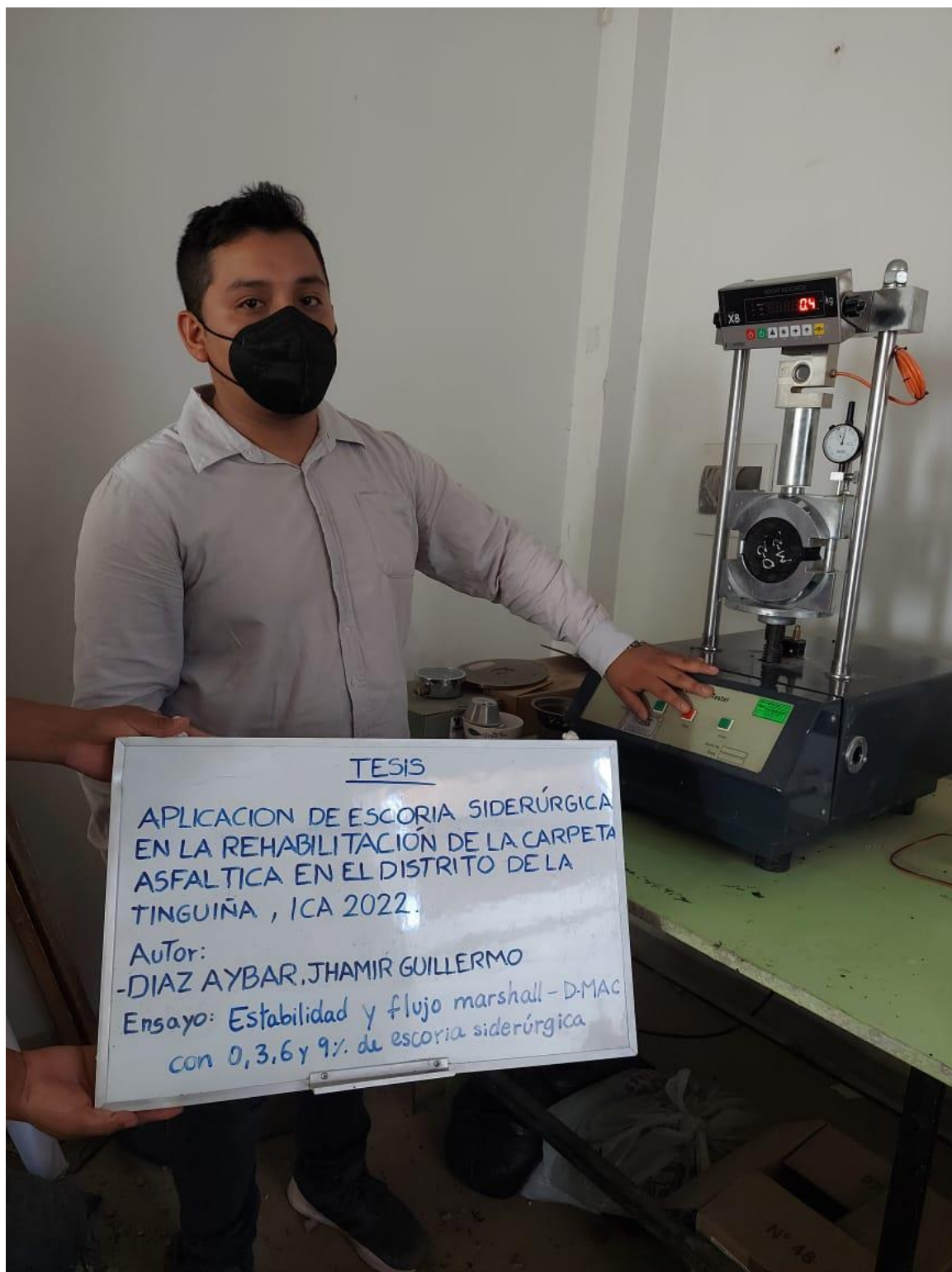
Ensayos de briquetas con adición de escoria para hallar la estabilidad y el flujo en cada diseño
