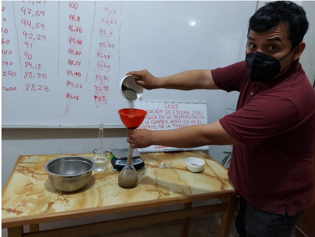
Procesamiento de agregado fino para obtencion de gravedad especifica
