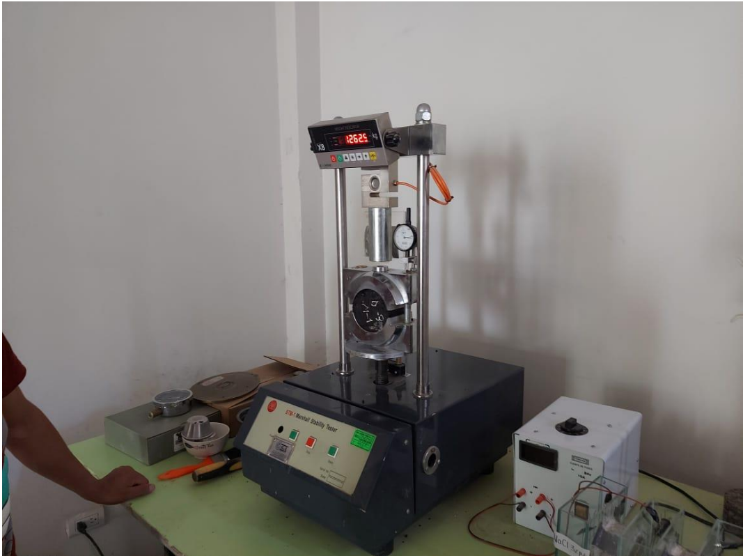
Preparación de briquetas en el instrumento de ensayo marshall listas para ser ensayadas
