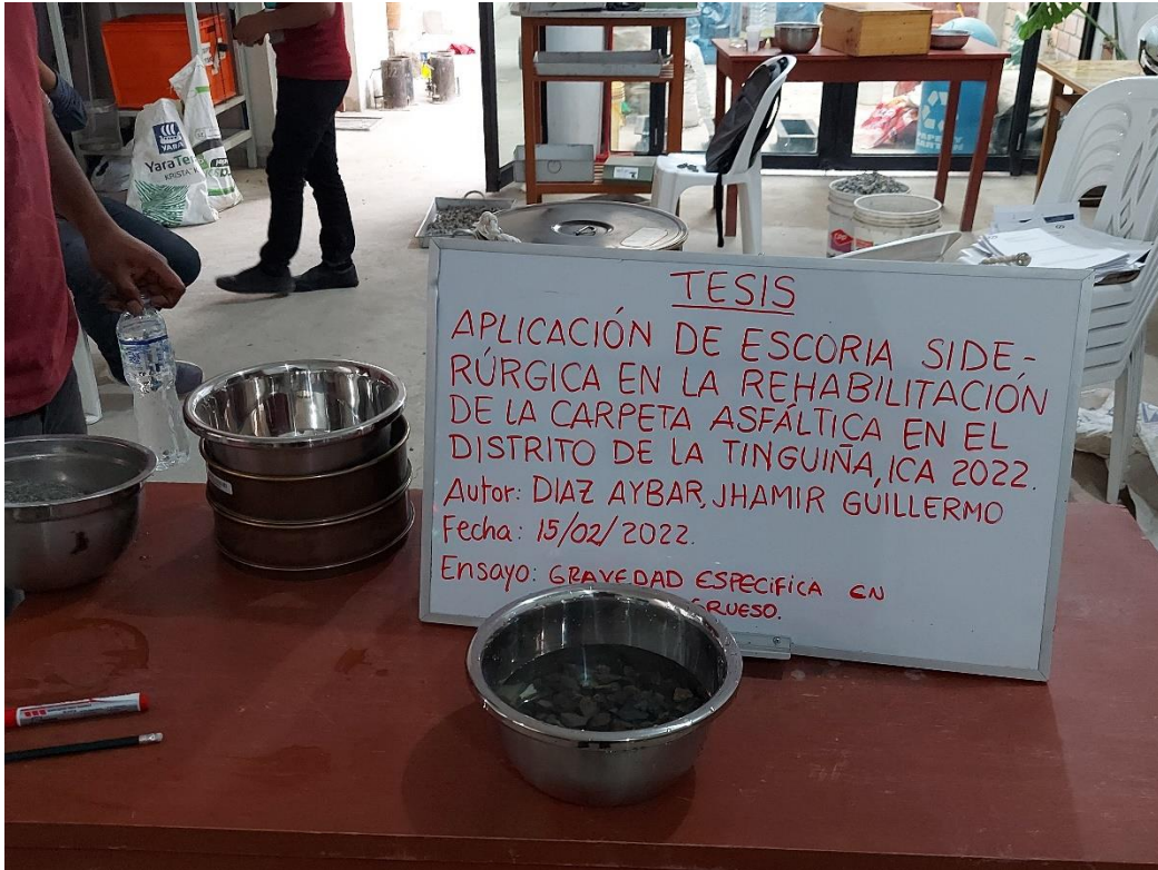
Saturacion de agregado grueso para hallar la gravedad especifica
