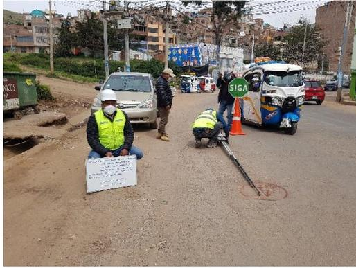
Figura 38. Instalacion de Viga Benkelman
