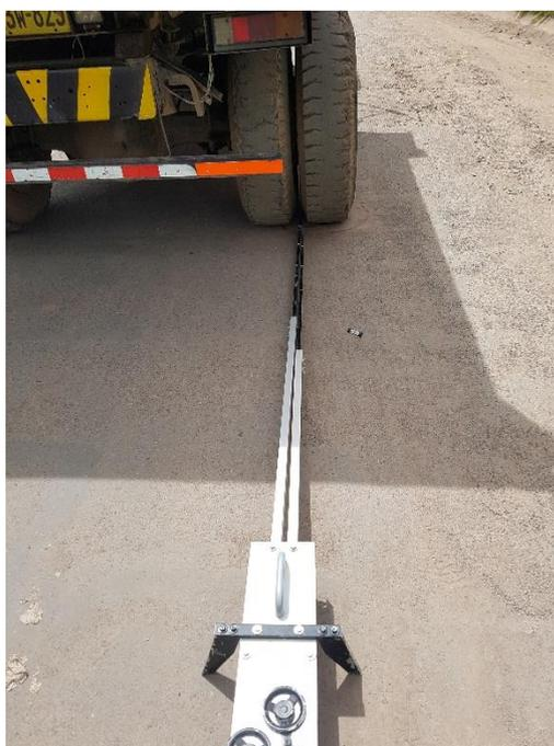
Figura 20. Armado de la Viga para el ensayo
