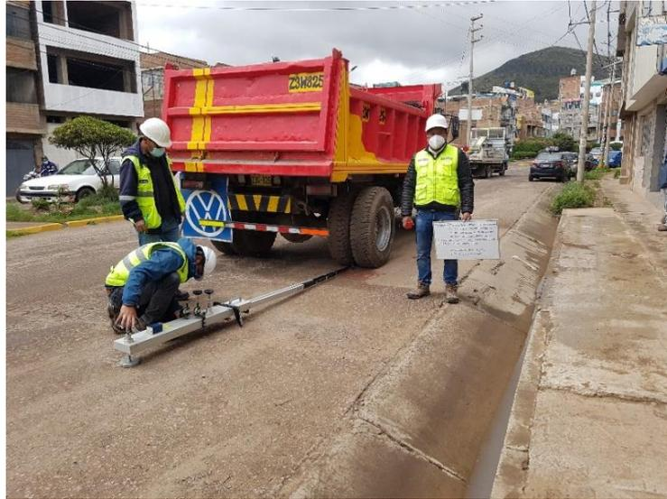
Figura 25. Ensayo de la Viga Benkelman Progresiva k1+200 CI
