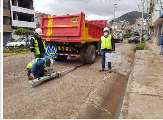
Figura39. Ensayo Viga Benkelman
