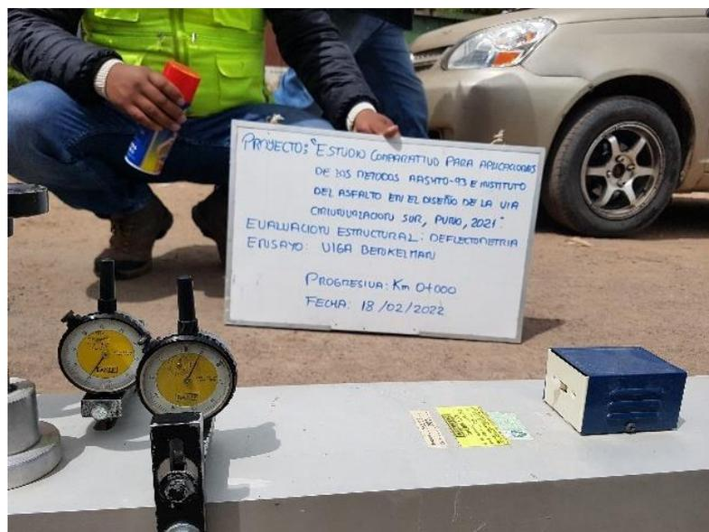
Figura 17. Viga Benkelman
