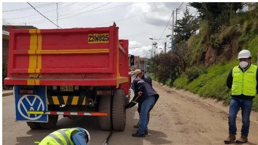
Figura 18. Camión para ensayo de la Viga Benkelman
