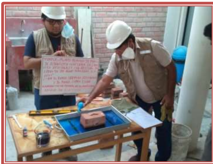
Figura 26: Mesa nivelada, mampuesto apoyado en tubos, el agua se mantiene a 3 mm sobre los tubos. (previo secado al horno para pesar la unidad.)
