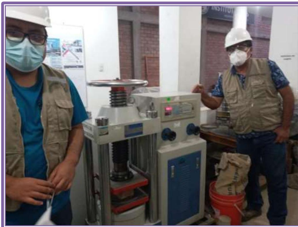
Figura 21: Realizando el ensayo de resistencia a la Compresión de la unidad de mampuesto.
