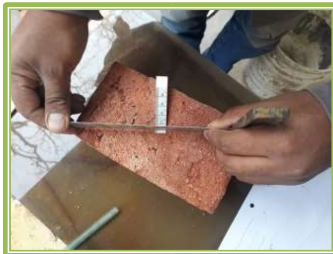
Figura 19: Verificando medidas con la cuña y la regla metálica.
