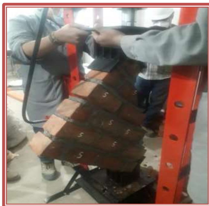
Figura 25: Ensayo de compresión diagonal.
