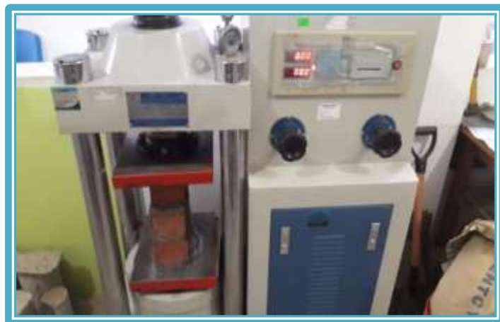
Figura 23: Ensayo de compresión axial.
