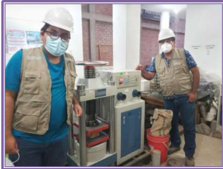
Figura 20: Realizando el ensayo de resistencia a la Compresión de la unidad de mampuesto.
