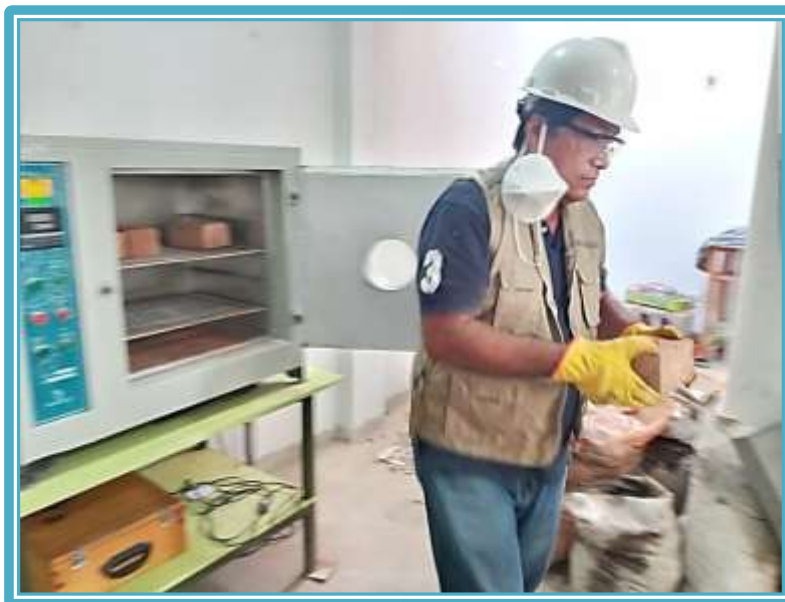
Figura 28: Secado al horno durante 24 horas y 4 horas para que enfríe.
