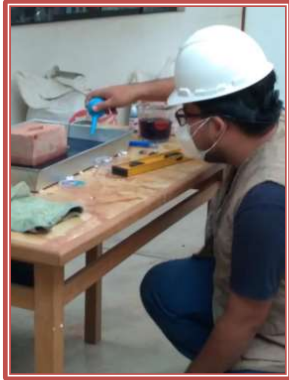
Figura 27: Conservando la altura de 3mm en el agua durante 01 minuto, luego se pesa.
