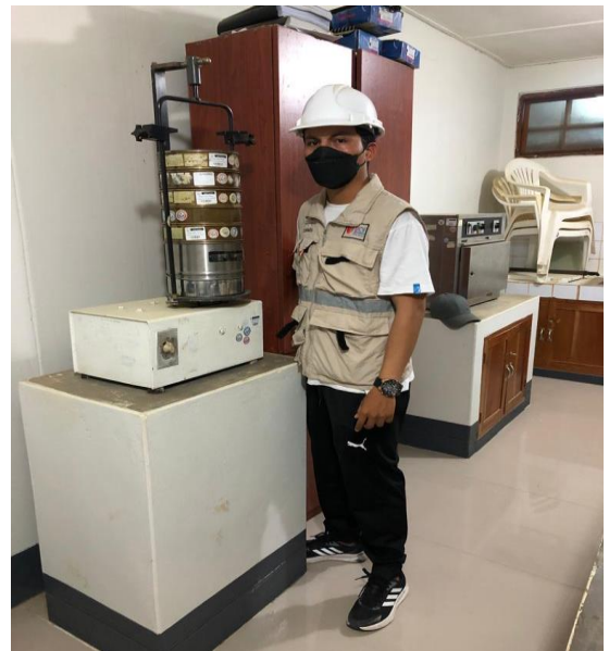
Figura 29 y 30: En las imágenes podemos observar la realización del ensayo granulometría en el laboratorio de suelos.
