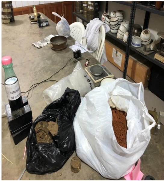
Figura 31 y 32: En las imágenes podemos apreciar el pesado de material para el ensayo de límites de atterberg en el laboratorio de suelos.
