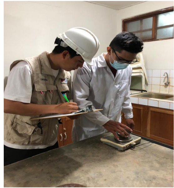
Figura 31 y 32: En las imágenes podemos apreciar el pesado de material para el ensayo de límites de atterberg en el laboratorio de suelos.
