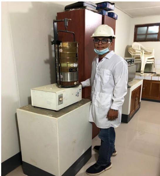
Figura 29 y 30: En las imágenes podemos observar la realización del ensayo granulometría en el laboratorio de suelos.
