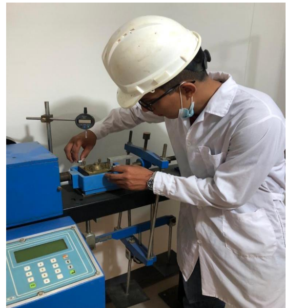
Figura 33 y 34: En las imágenes podemos apreciar la realización del ensayo de corte directo en el laboratorio de suelos.
