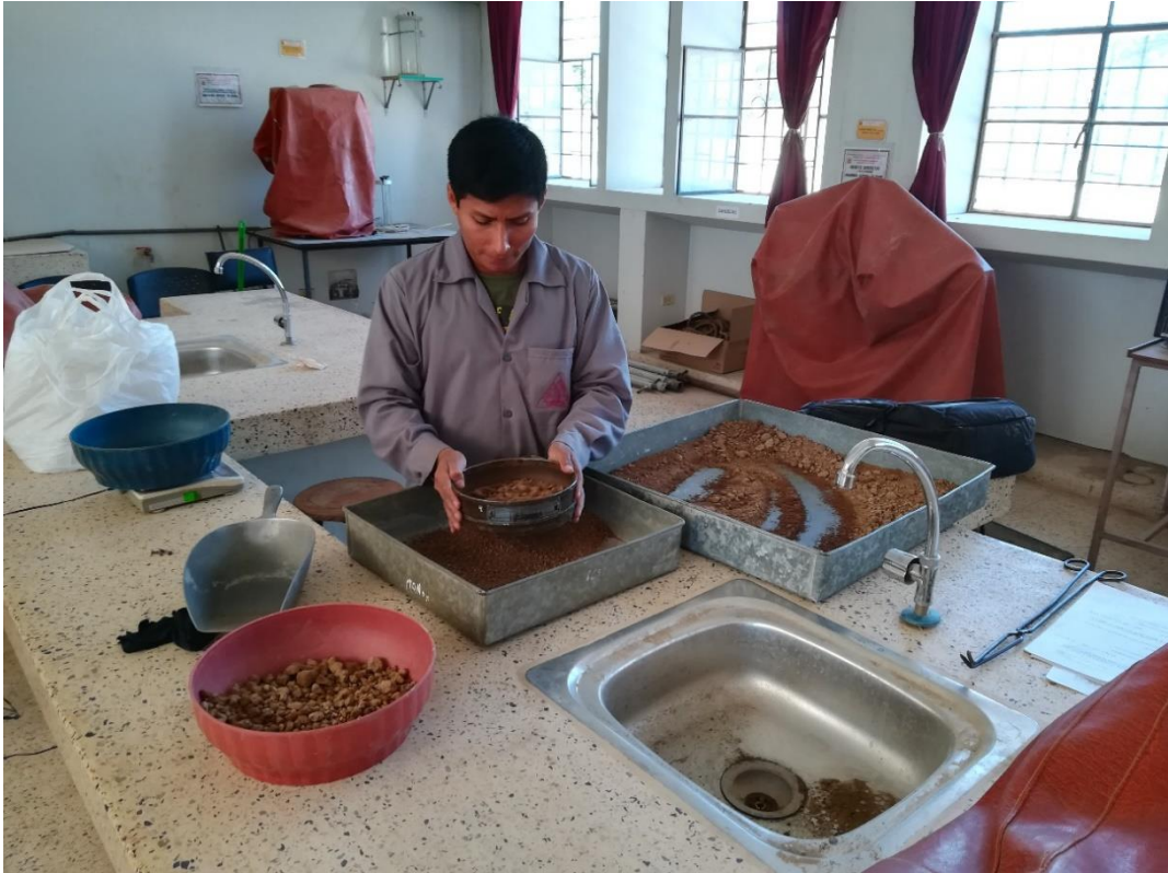
Tamizando la muestra para realizar el ensayo de proctor modificado.
