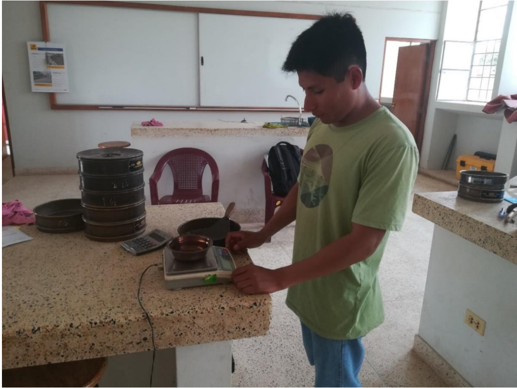
Realizando el ensayo de contenido de humedad.
