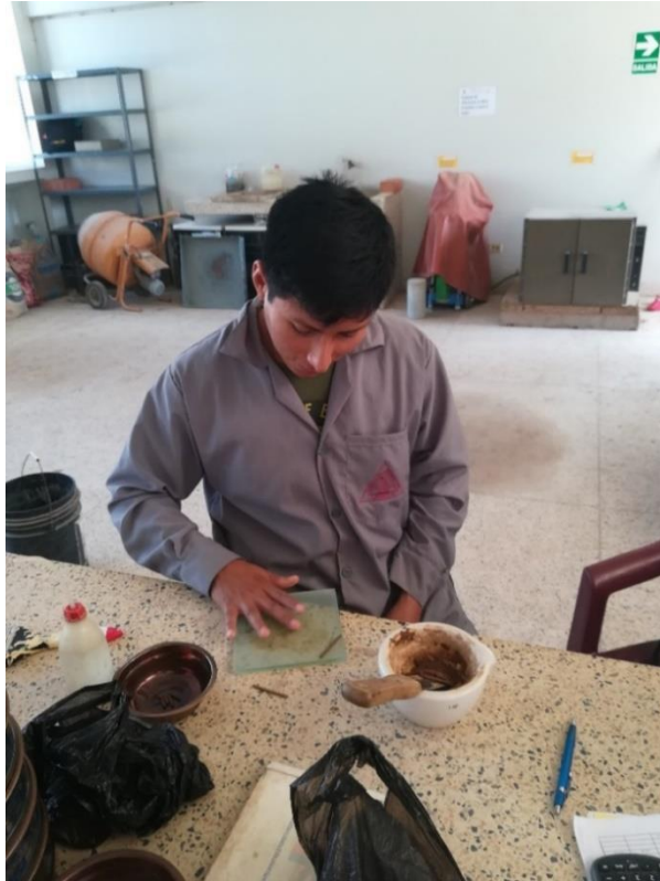
Realizando el ensayo de límite plástico.
