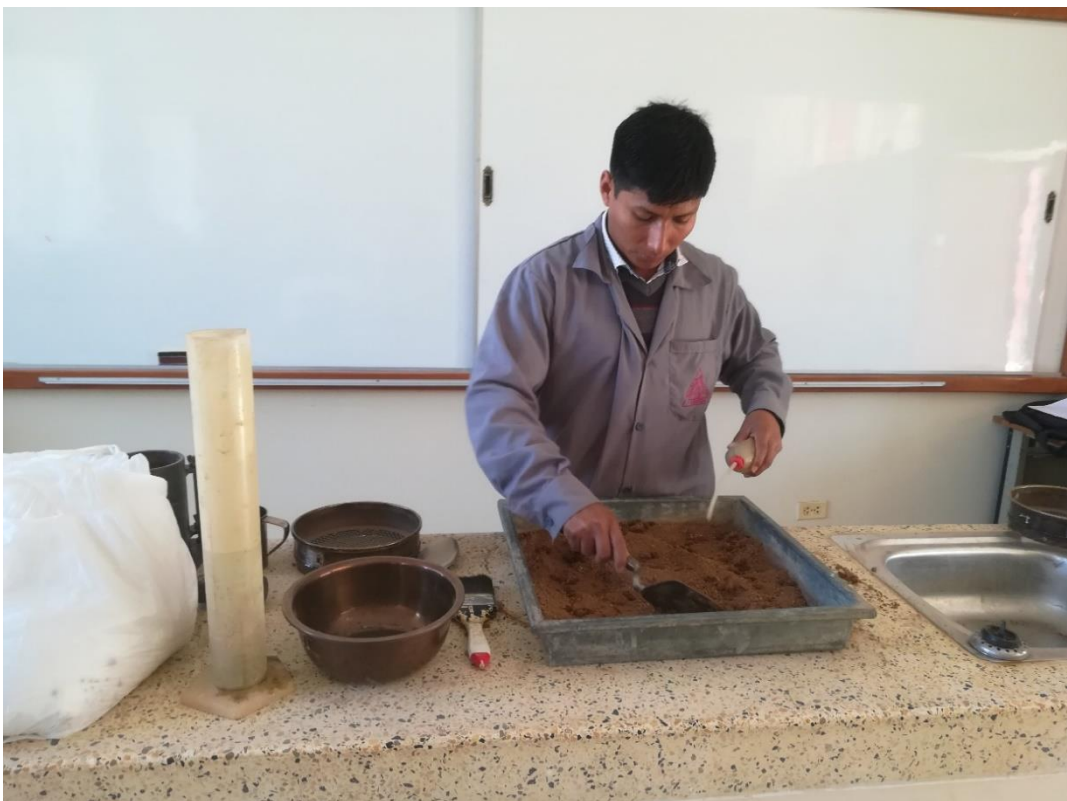
Agregándole agua a la muestra para calcular el contenido de humedad óptima.
