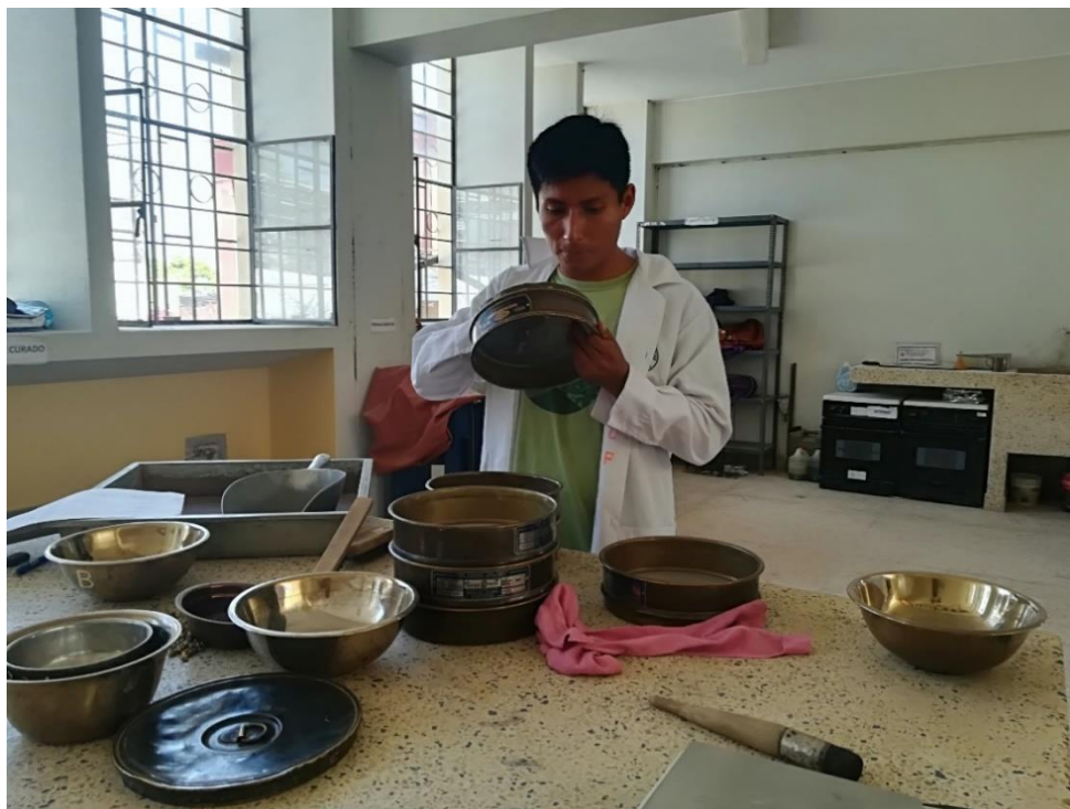
Pesando la muestra retenida en las mallas.
