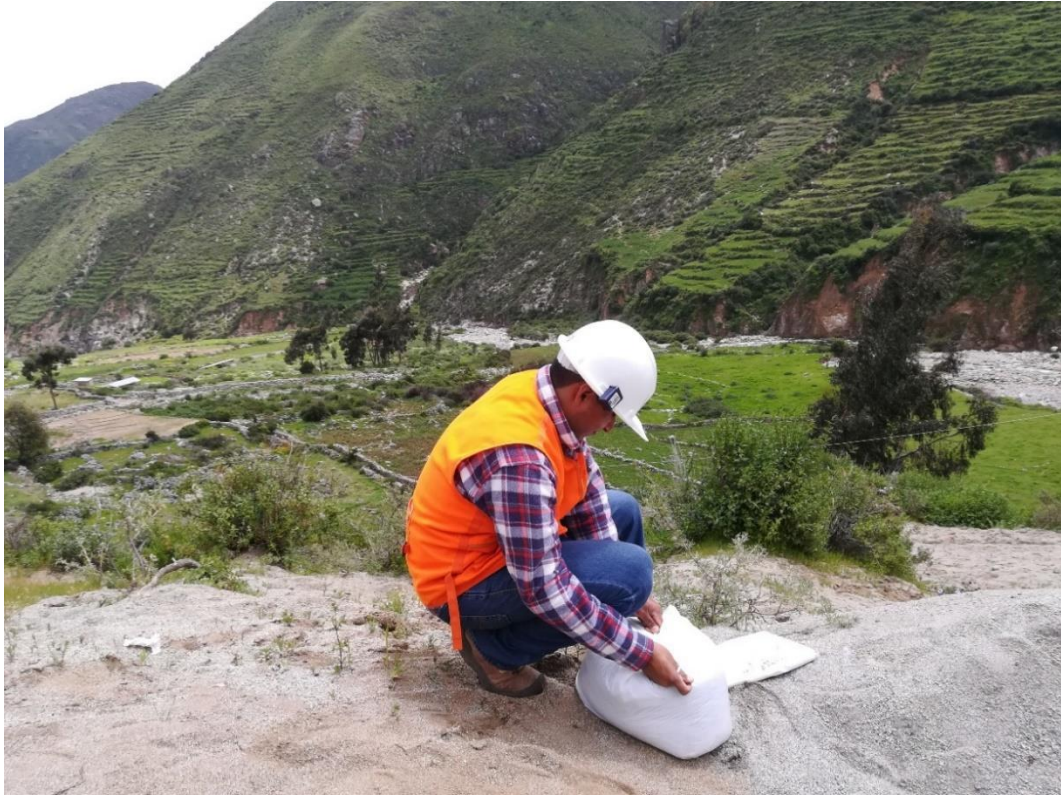
Obtención de muestra de calicata N° 1.
