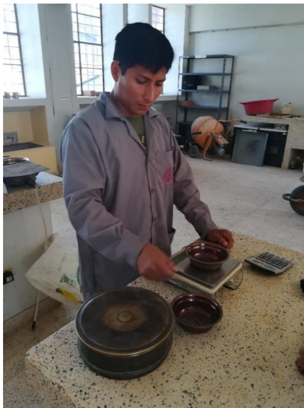
Pesando las muestras para calcular el contenido de humedad.
