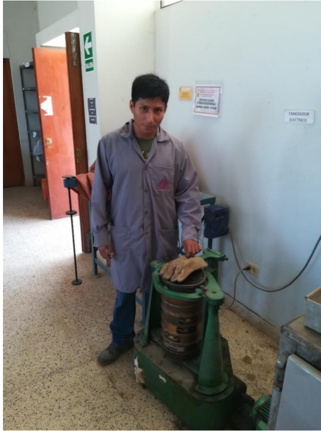
Realizando el ensayo de análisis granulométrico.
