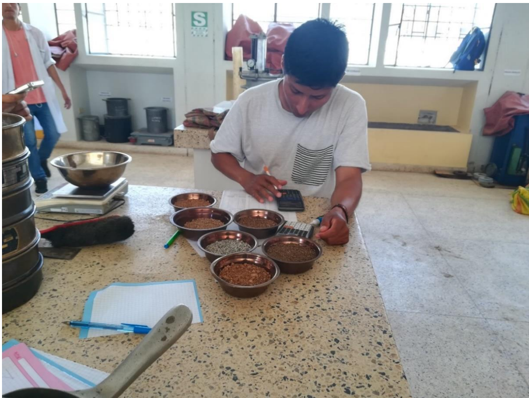
Pesando las muestras para calcular el contenido de humedad.
