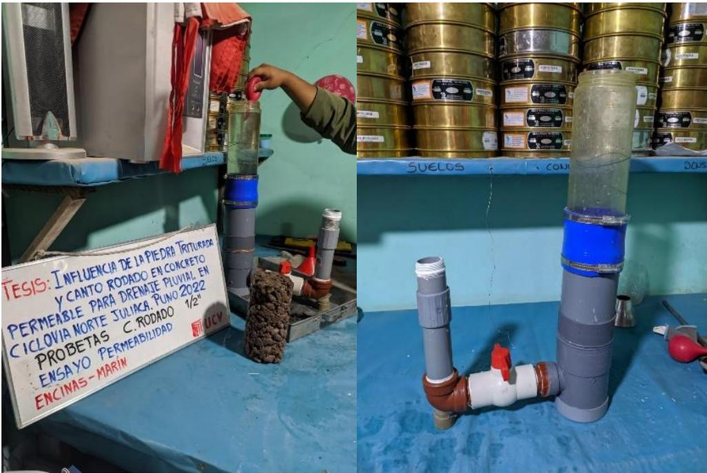
Figura 29: Ensayo capacidad de infiltración del concreto
