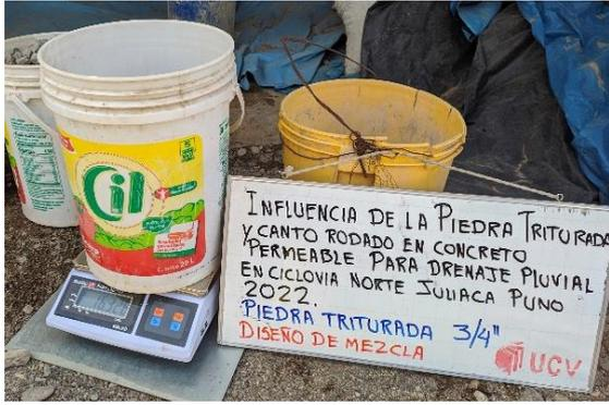
Peso de los agregados para el diseño de mezcla
