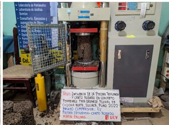
Probeta luego del ensayo 3/8" P.T.
