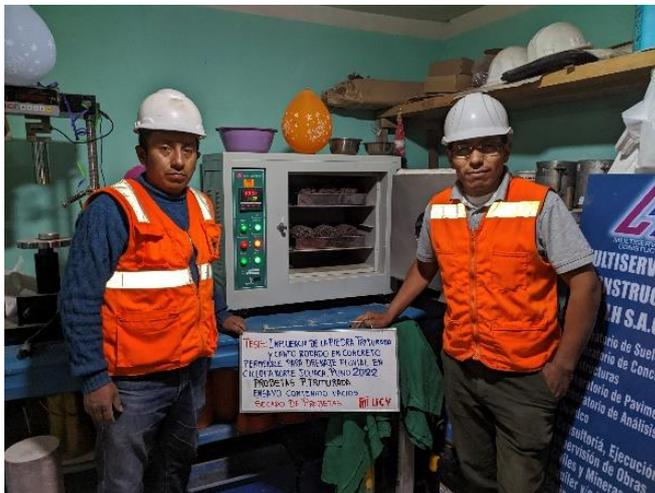
Secado de las probetas cilíndricas para ensayo de % contenido de vacíos.
