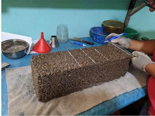
Trazado de los tercios para ensayo a flexión
