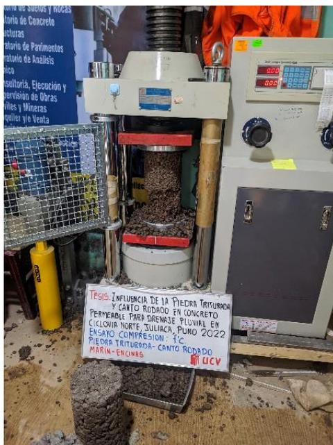
Probeta luego del ensayo 3/4" P.T.
