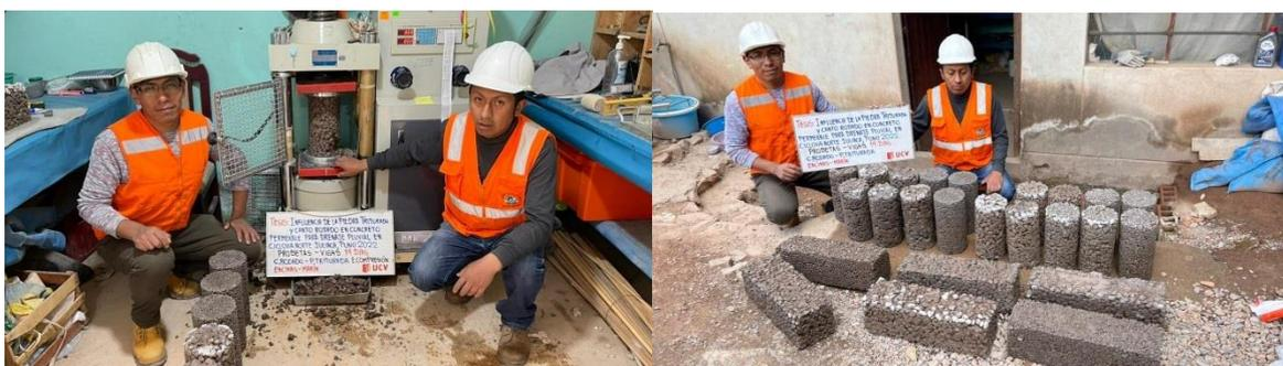
Figura N° 17: Ensayo de resistencia a la compresión del concreto
