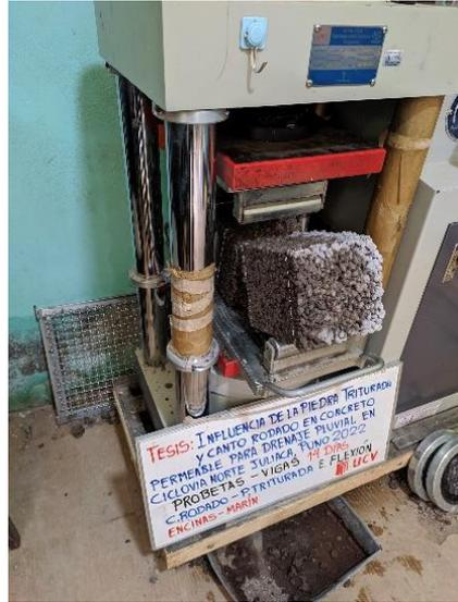
Rotura de la Viga Prismática
