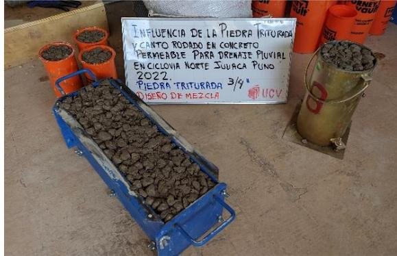
Probetas de concreto permeable
