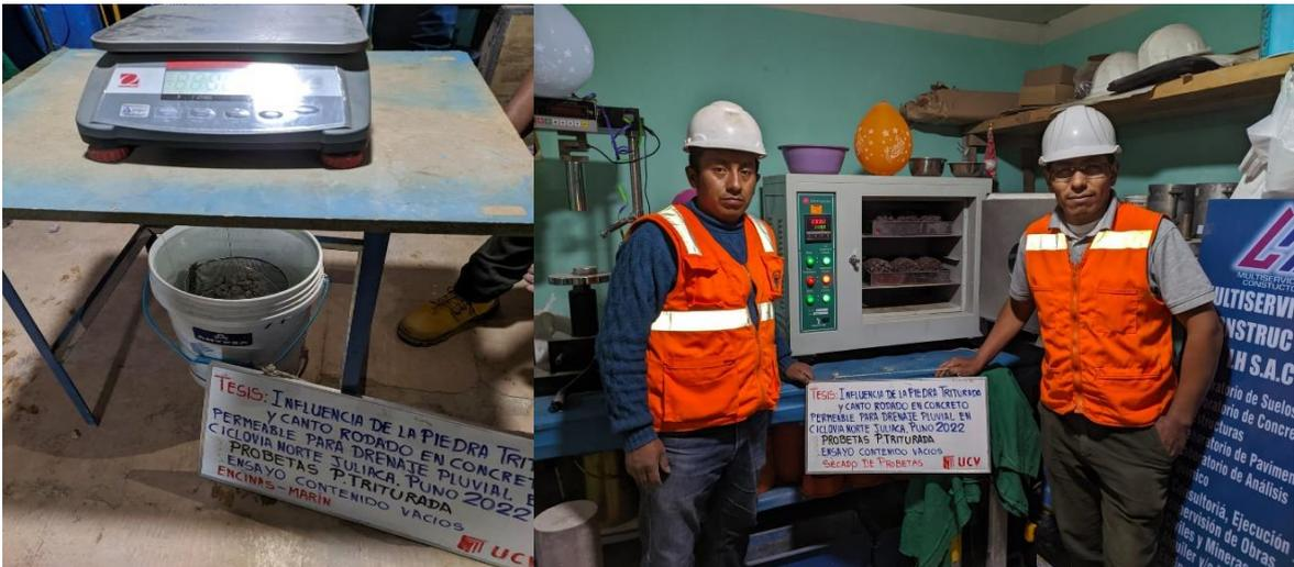
Figura N° 25: Peso de la probeta de concreto – secado al horno.
