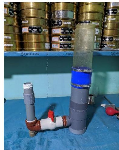
Instrumento para el ensayo de Permeabilidad
