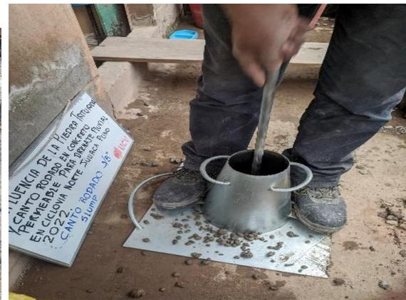
Prueba de consistencia del concreto permeable canto rodado 3/8"
