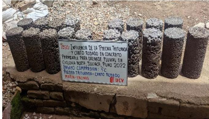
Probetas cilíndricas de concreto permeable para ensayo a la compresión
