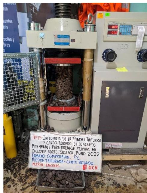
Probeta luego del ensayo 3/8" C.R.
