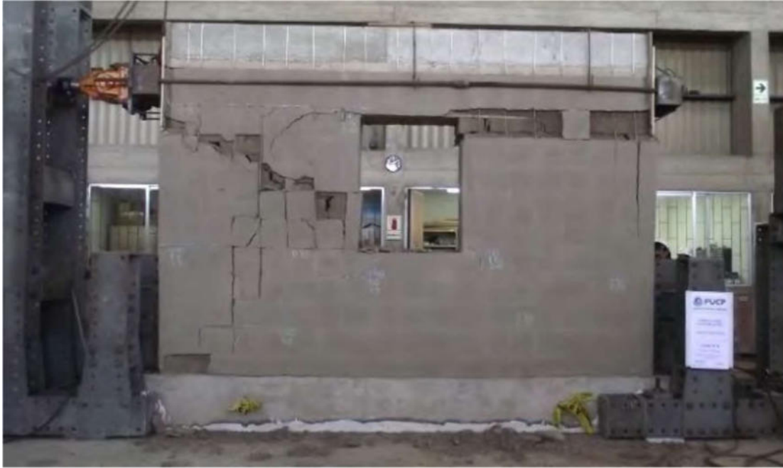
Foto 11: Ensayo carga cíclica lateral, se aprecia el final del muro MCR D N después de la fase 8, fin del ensayo.
