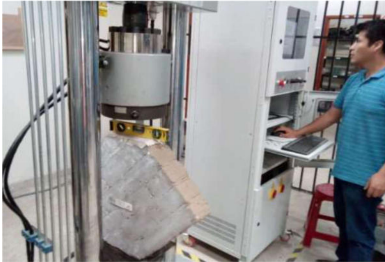
Foto 03: Ensayo de compresión diagonal de muretes, se puede apreciar el espécimen antes del ensayo nivelado y recordado según la recomendación de Garrocho (2017) cortados 16cm de las esquinas.
