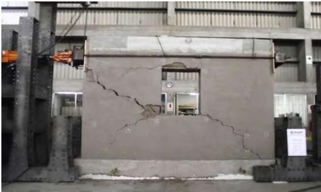
Foto 10: Ensayo carga cíclica lateral, se aprecia el final del muro MSR D N después de la fase 8, fin del ensayo.
