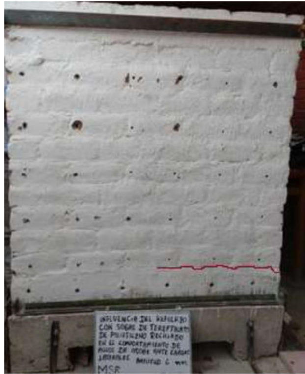
Foto 05: resultado de la fase 2 del MSR P E, se aprecia comienza con la fisuración del espécimen.
