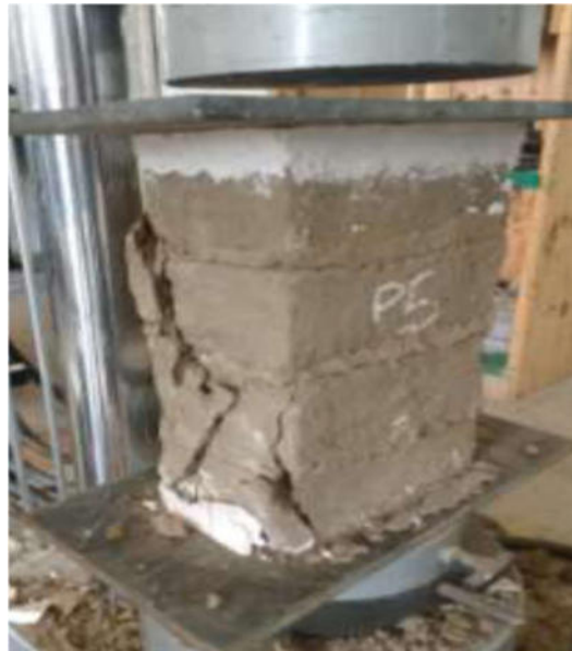
Foto 02: Ensayo de compresión de pilas, tiene como finalidad medir el comportamiento de la albañilería a compresión.
