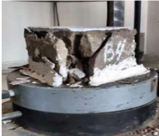
Foto 01: Ensayo de compresión de cubos de 10cm de arista, en la foto se aprecia la rotura de la probeta después de haber sido sometido a compresión.
