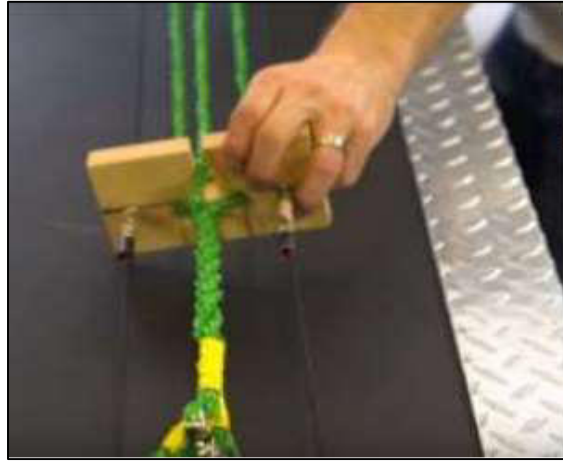
Figura 19. Elaboración de sogas PET como refuerzo
