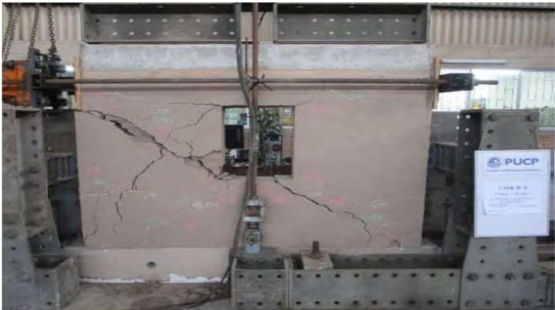
Foto 12: Ensayo carga cíclica lateral, se aprecia el final del muro MSR D E después de la fase 10, fin del ensayo.
