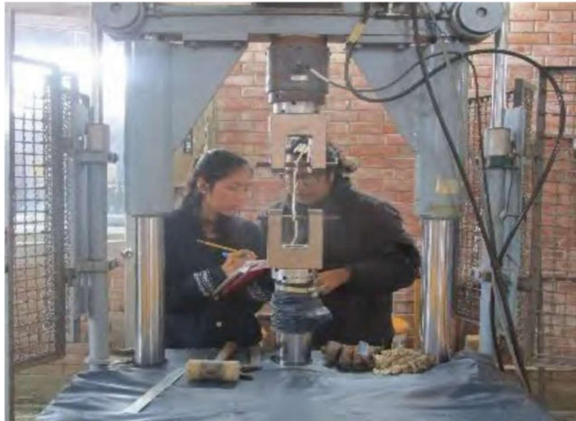
Foto 09: Ensayo Tracción en drizas, en este ensayo se verifica propiedades mecánicas de las drizas a usar, su elongación máxima y su rotura cuando es sometido a tensión.
