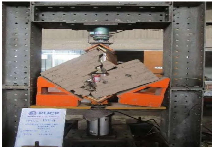
Foto 08: Ensayo de compresión diagonal, en este ensayo se verifica las características que presenta la albañilería cuando es sometido a corte.
