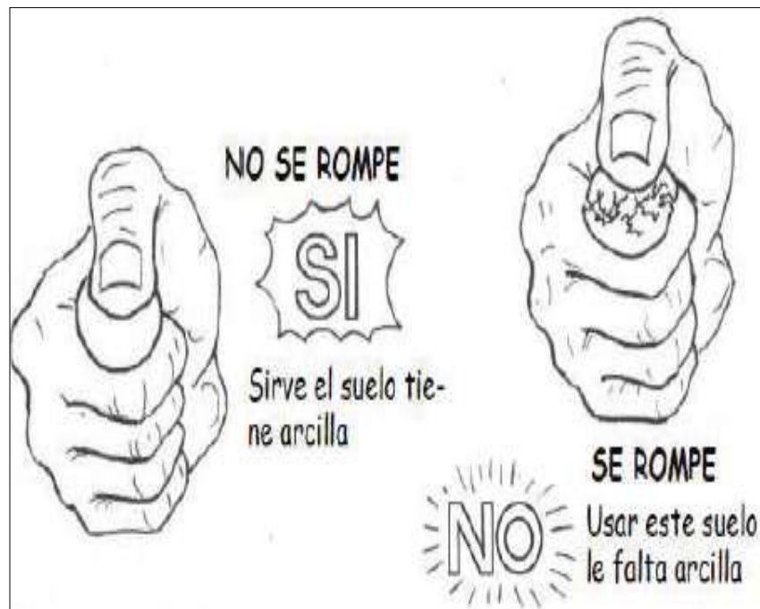
Figura 11. Procedimiento prueba "Resistencia seca"
