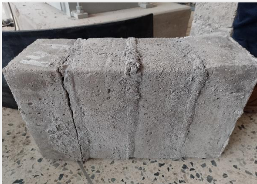
Figura 3. 49 Muestra de tipo de rotura en mortero
