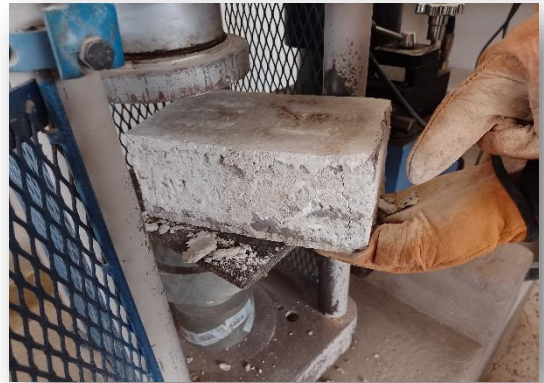
Figura 4. 64 Falla de los ladrillos a la resistencia a compresión Fuente : Propia
