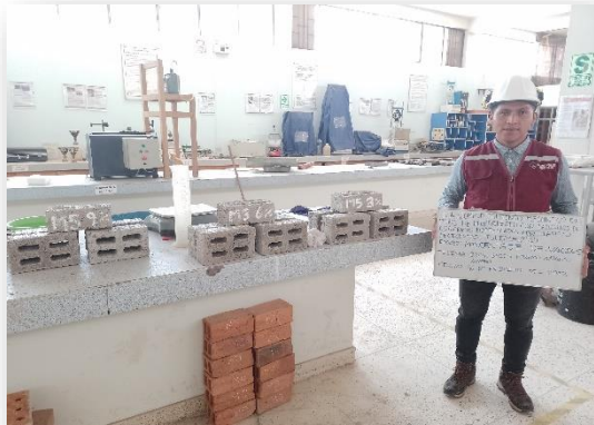
Figura 3. 28 Muestras de LC con plástico PET (0%, 3%, 6% y 9%)
