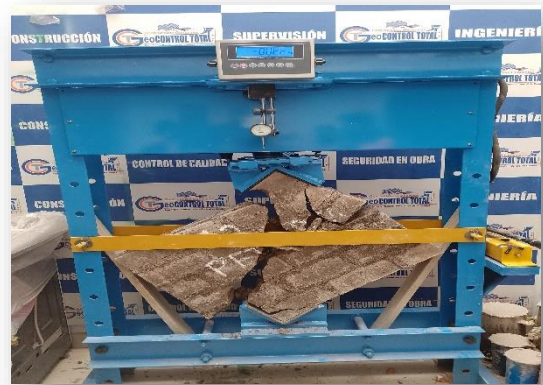
Figura 4. 58 Rotura de los prismas
