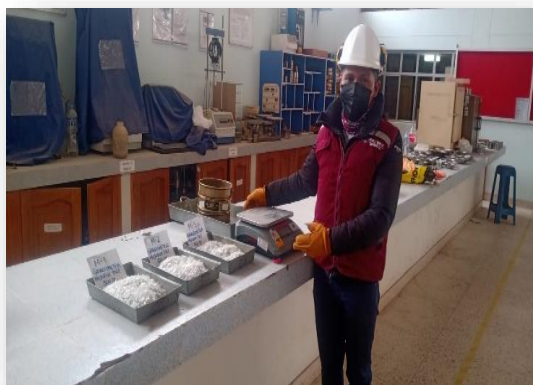
Figura 3. 16 Granulometría del plástico PET reciclado - Laboratorio de suelos UANCV
