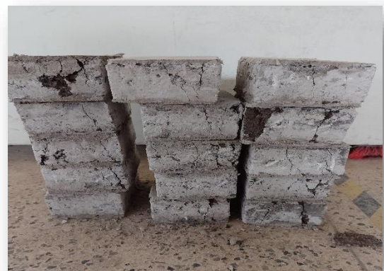
Figura 3. 37 Rotura de los ladrillos mostrando las grietas
