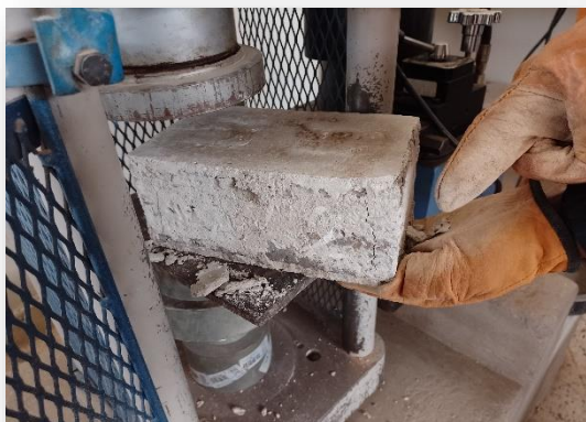
Figura 3. 38 Grieta mostrada en el ladrillo
