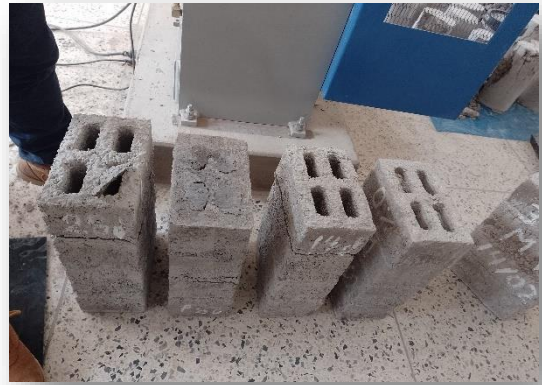
Figura 3. 50 Diferentes tipos de rotura en nuestras muestras
