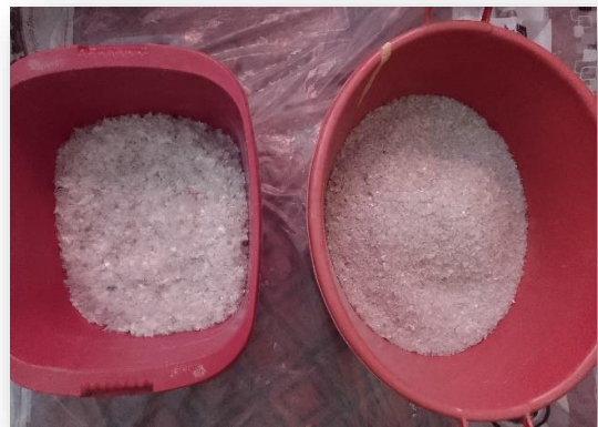
Figura 3. 13 Material PET triturado, tamizado y lavado
