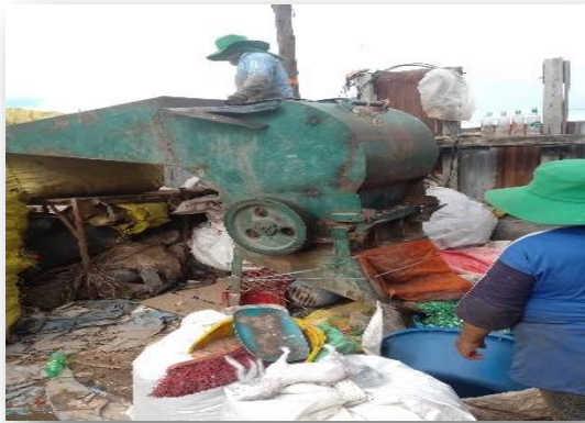
Figura 3. 14 Planta trituradora de botellas de plástico – Juliaca
