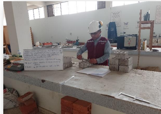
Figura 3. 25 Medidas de diferentes muestras PET (0%, 3%, 6%, 9%)
