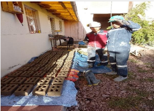
Figura 3. 23 Elaboración de los ladrillos de PET reciclado según porcentajes (0%, 3%, 6% y 9%)
