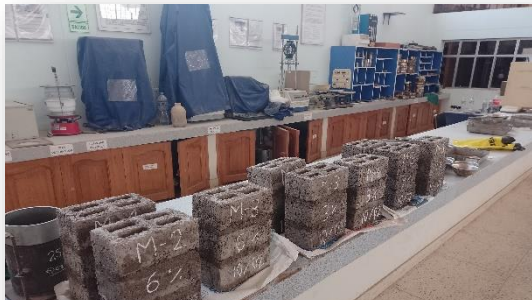
Figura 3. 40 Pilas de LC de plástico PET reciclado con las dosificaciones ( 0%, 3%, 6% y 9%)
