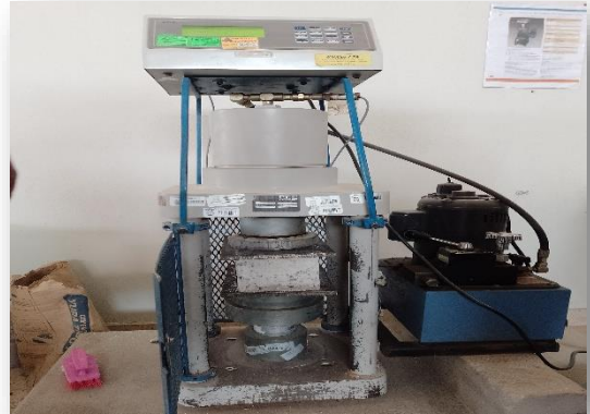
Figura 3. 36 Rotura de LC con PET
