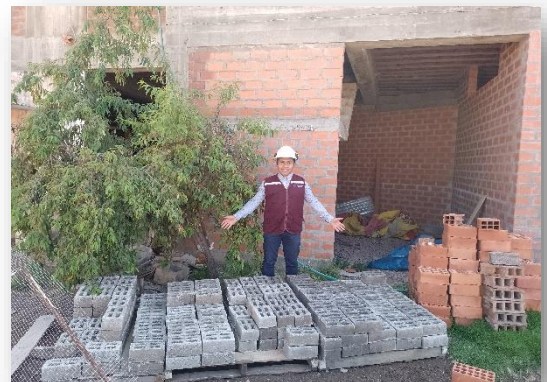
Figura 3. 24 Ladrillos de mortero con porcentajes de PET reciclado (0%, 3%, 6% y 9%) Preparados para su curado
