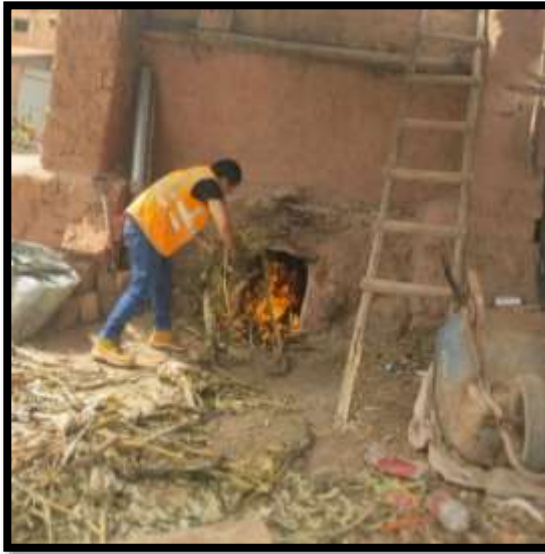
Figura 7. Pre quemado de rastrojo de maíz en horno artesanal Fuente: elaboración propia.
