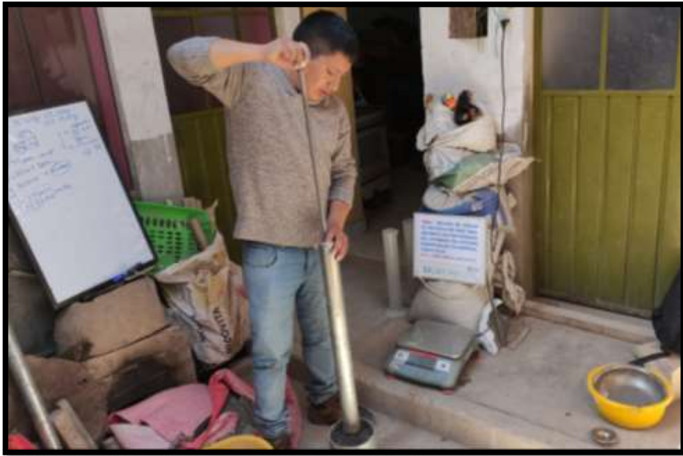
Figura 20. Ensayo de Proctor Modificado
