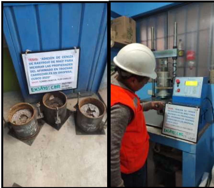
Figura 22. Ensayo de CBR en laboratorio
