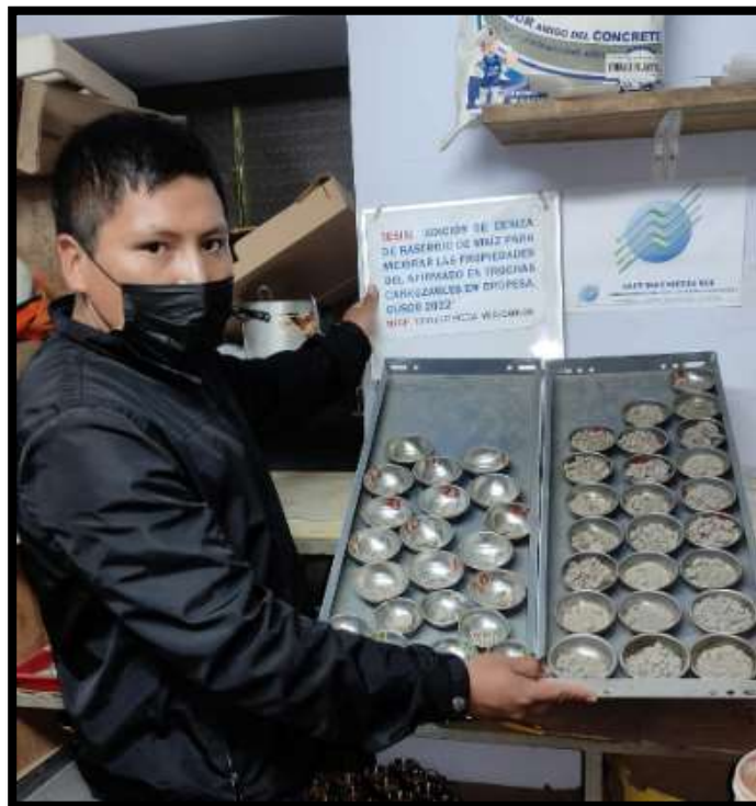
Fotografía 10: Ensayo y obtención de muestras de límites de consistencia de material patrón mas adición de CRM
