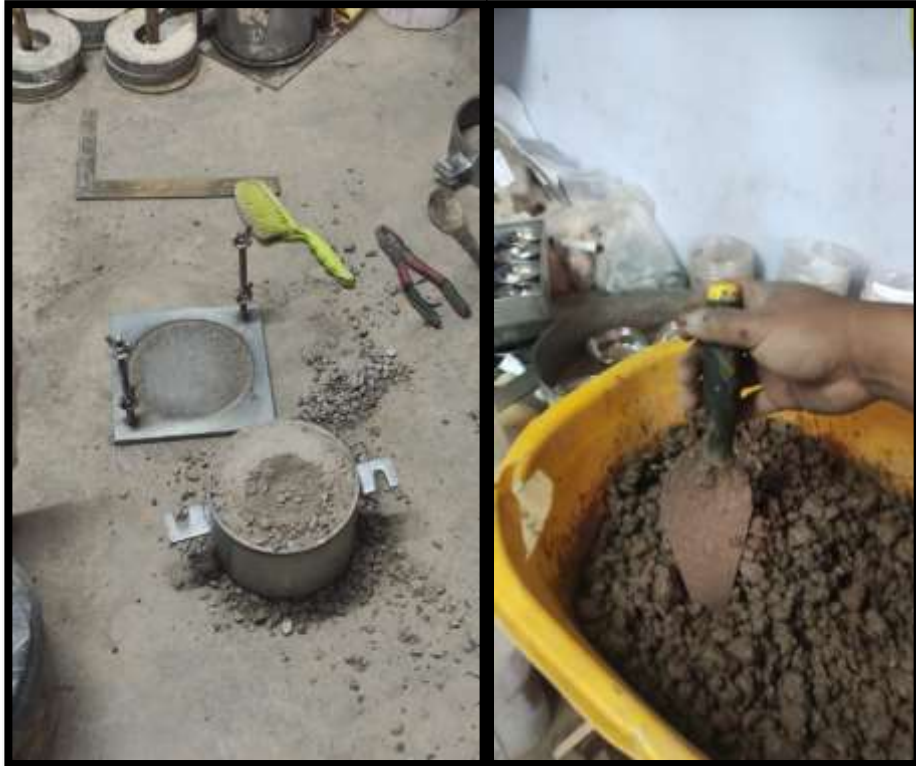
Fotografía 11: Ensayo de Proctor modificado de material de afirmado
