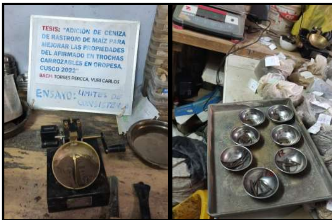
Figura 16. Ensayo de límites de Atterberg
