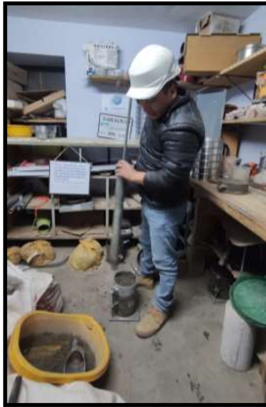
Figura 18. Ensayo de Proctor Modificado
