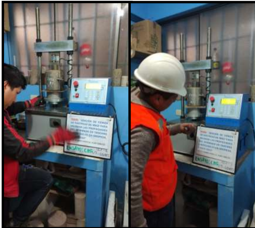
Fotografía 14: Ensayo de resistencia de material de afirmado
