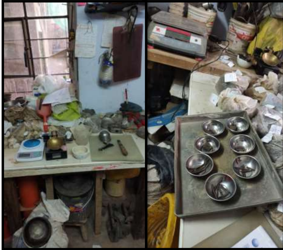
Fotografía 9: Ensayo y obtención de muestras de límites de consistencia de material de afirmado
