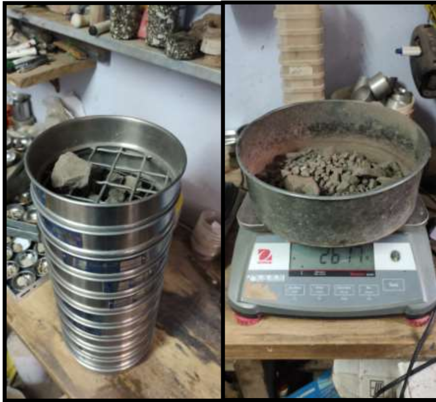
Fotografía 7: Ensayo de análisis granulométrico de material de afirmado
