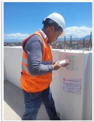
*ENSAYO DE ESCLEROMETRÍA EN VIGAS Y COLUMNAS*
