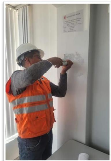
*ENSAYO DE ESCLEROMETRÍA EN VIGAS Y COLUMNAS*
