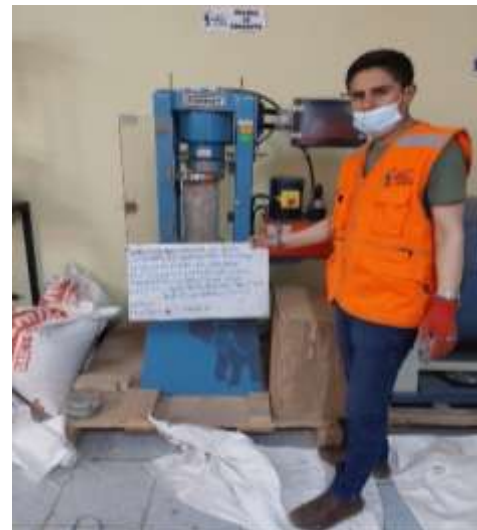
Figura 15. Resistencia a la compresión f'_c = 210\text{kg/cm}^2 de concreto con acero trefilado
