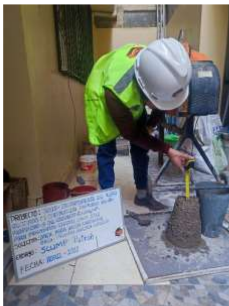
Figura 29. Trabajabilidad del concreto patrón f'c = 210\text{kg/cm}^2 en estado fresco
