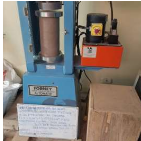
Figura 18. Resistencia a la compresión f'_c = 280\text{kg/cm}^2 de concreto con acero trefilado
