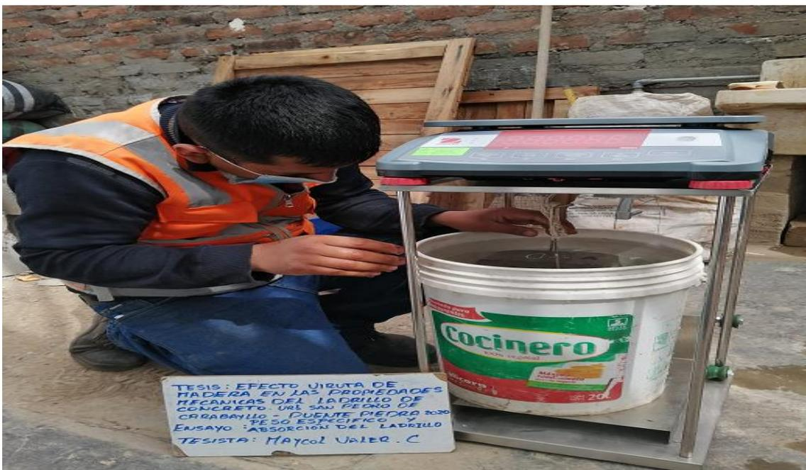
Figura 7. Absorción, se coloca el ladrillo con recipiente de agua.
