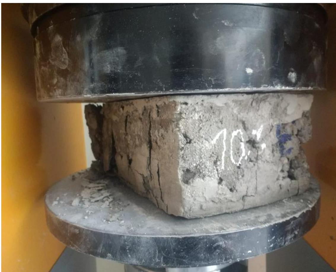
Figura 3. Resistencia a la compresión en laboratorio, NTP 399.601
