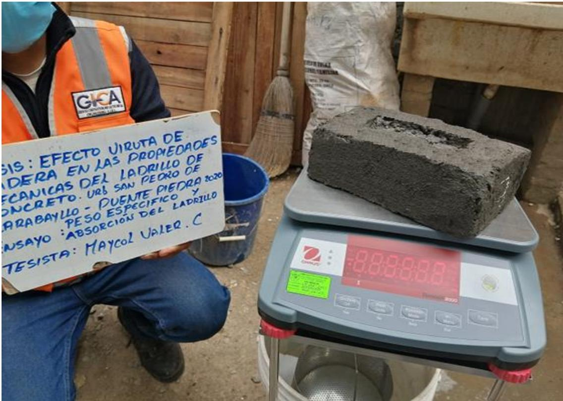
Figura 8. Absorción ladrillo durante 24h y pesaje del ladrillo.
