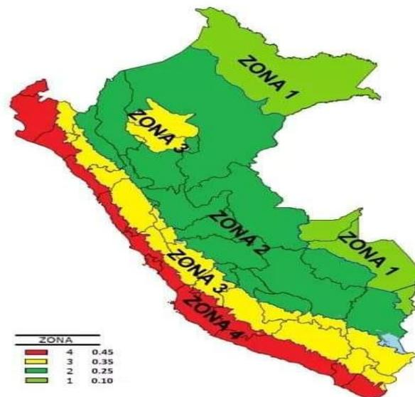
Figura 1. Distribución zona sísmica del Perú.
