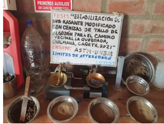
Figura 27: Muestras de ensayo de límite de plasticidad. Figura 28: Instrumentos Casa Grande.
