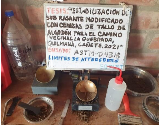
Figura 27: Muestras de ensayo de límite de plasticidad. Figura 28: Instrumentos Casa Grande.
