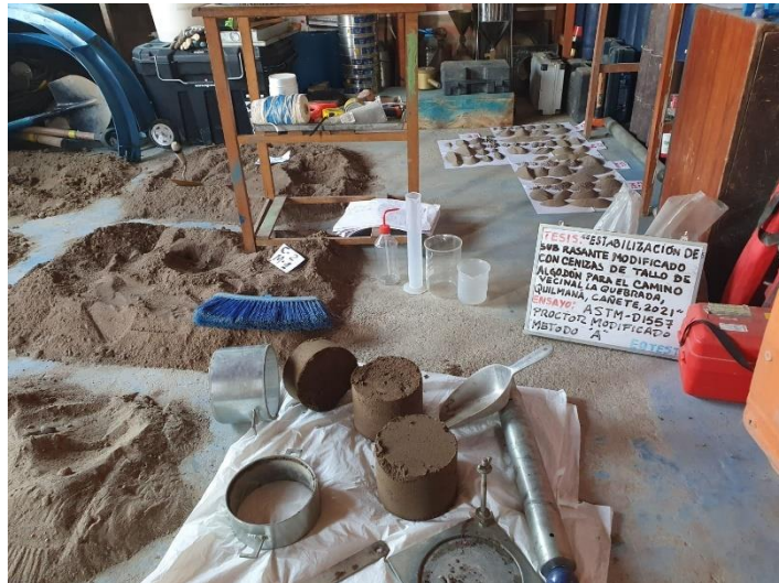
Figura 05: Ensayo de Proctor Modificado
