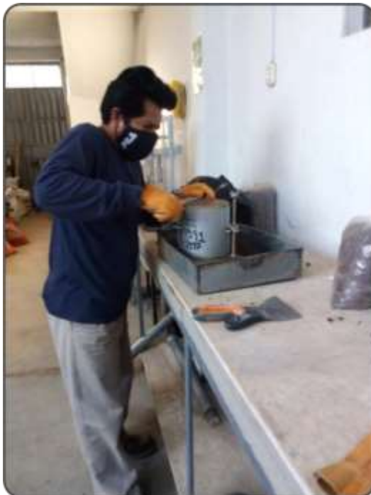
Figura 76. Proceso del nivelado de la muestra que está en el molde usando una regla metálica. Fuente: Elaboración propia.
