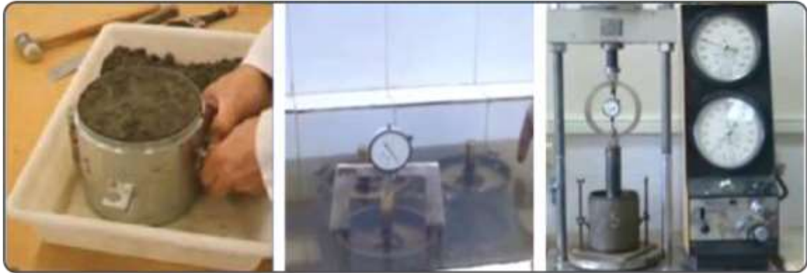
Figura 13. Equipos de ensayos de CBR.
