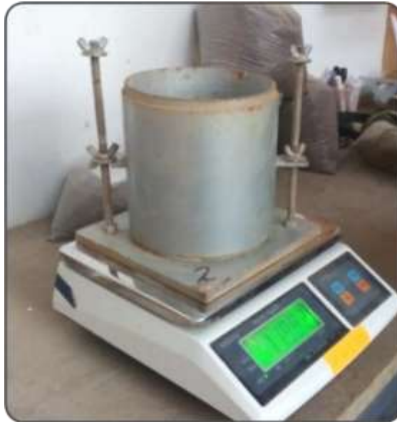
Figura 107. Proceso del pesado del molde de proctor. Fuente: Elaboración propia.
