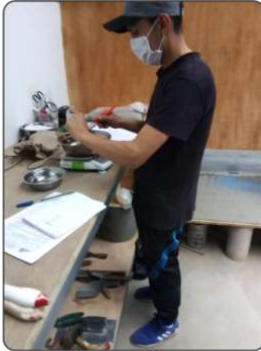
Figura 52. Proceso de pesado de la muestra de suelo húmedo. Fuente: Elaboración propia.
