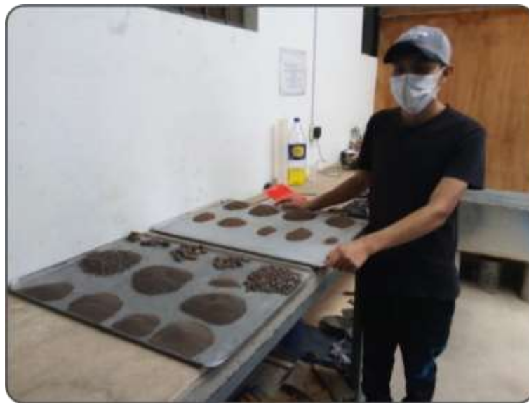
Figura 89. Muestra de suelo ordenadas de cada tamiz. Fuente: Elaboración propia.
