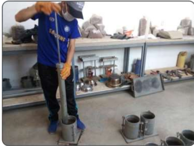
Figura 112. Realizando el proceso de compactado de la muestra de suelo. Fuente: Elaboración propia.
