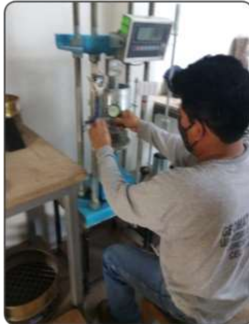
Figura 80. Colocando el medidor de la presión en la prensa hidráulica. Fuente: Elaboración propia.
