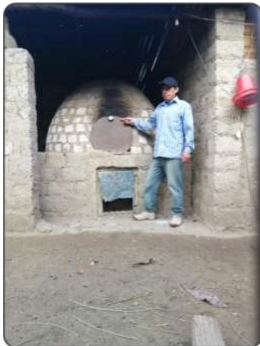
Figura 42. Toma de la temperatura de calcinación del horno artesanal. Fuente: Elaboración propia.
