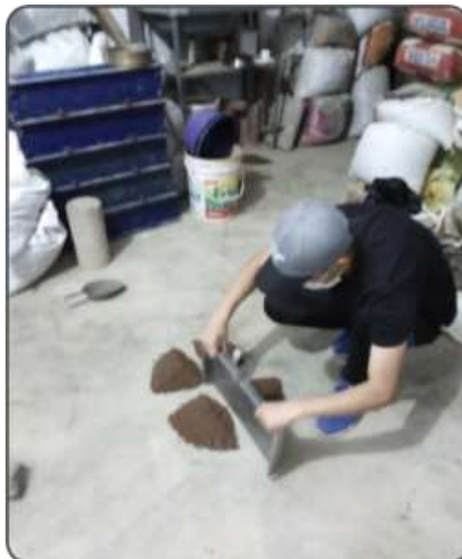
Figura 82. Proceso de cuarteo de la muestra de suelo.
