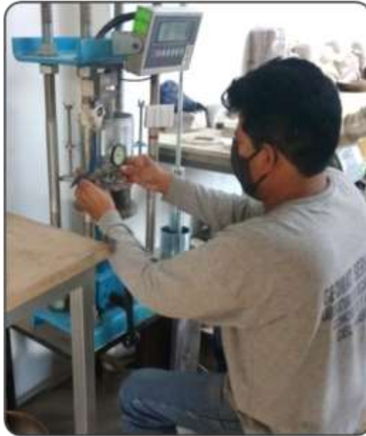
Figura 117. Colocando el medidor de la presión en la prensa hidráulica. Fuente: Elaboración propia.
