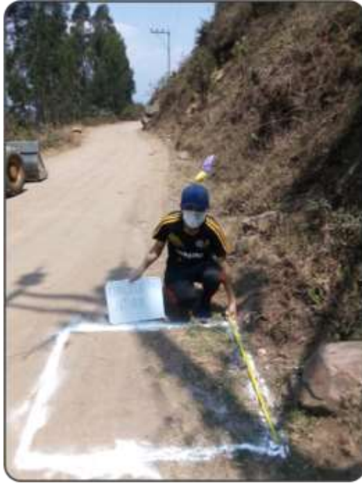
Figura 26. Marcación con yeso de la calicata C-3. Fuente: Elaboración propia.
