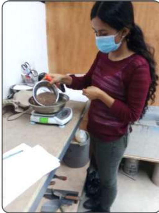
Figura 57. Proceso de pesado de cada tamiz retenido. Fuente: Elaboración propia.
