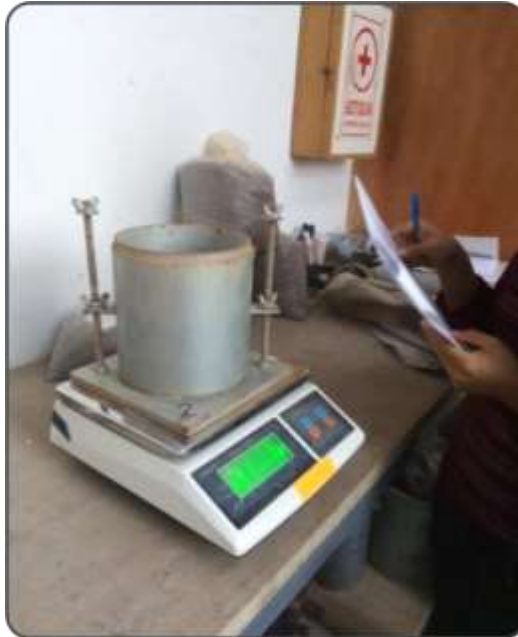
Figura 70. Proceso del pesado del molde de proctor. Fuente: Elaboración propia.
