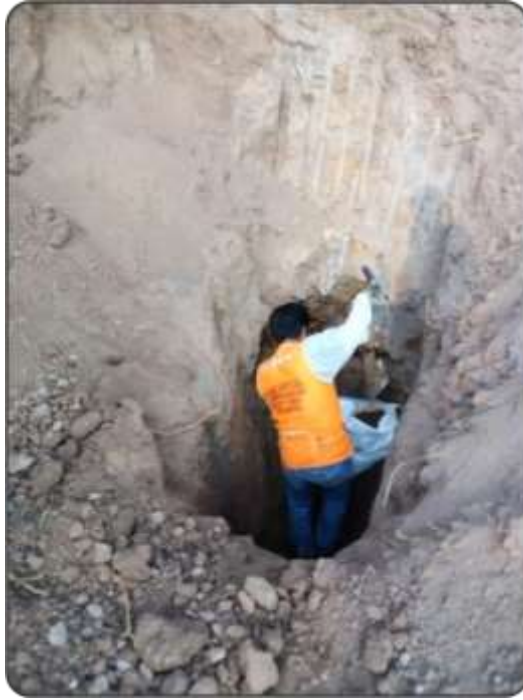
Figura 34. Extracción de la muestra de suelo para su colocación a los costales de rafia. Fuente: Elaboración propia.
