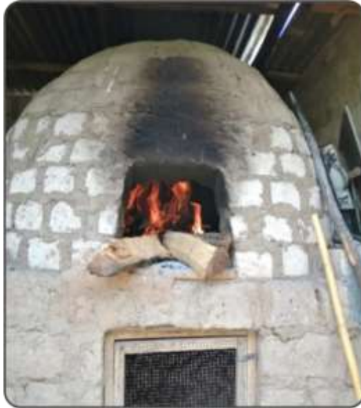
Figura 41. Horno artesanal calcinando la leña rajada de eucalipto. Fuente: Elaboración propia.
