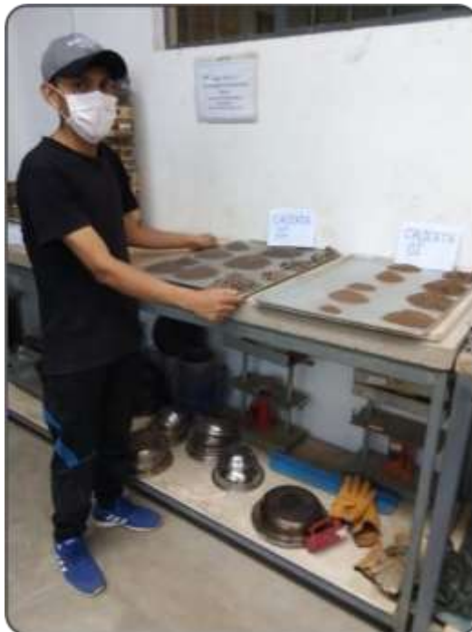
Figura 58. Muestra de suelo ordenadas de cada tamiz. Fuente: Elaboración propia.
