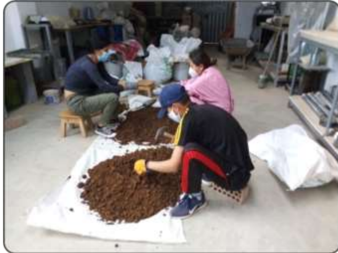
Figura 48. Proceso de desmenuzando de las partículas pegadas de la calicata C-1, para el ensayo de contenido de humedad.
