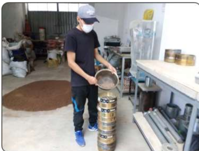
Figura 87. Proceso de vaciado de la muestra de suelo a los tamices que están ordenados. Fuente: Elaboración propia.
