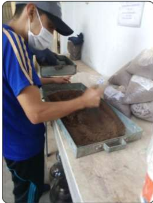
Figura 106. Haciendo el proceso del mezclado de la muestra de suelo más el agua. Fuente: Elaboración propia.
