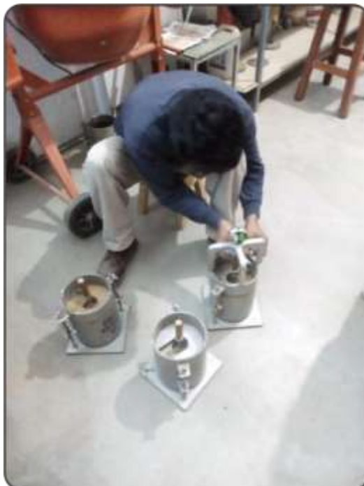
Figura 78. Proceso del colocado del trípode a los moldes. Fuente: Elaboración propia.
