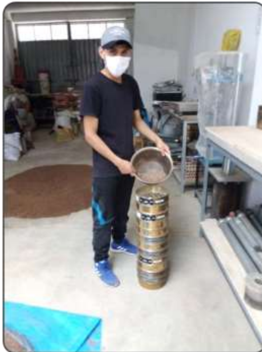
Figura 56. Proceso de vaciado de la muestra de suelo a los tamices que están ordenados. Fuente: Elaboración propia.
