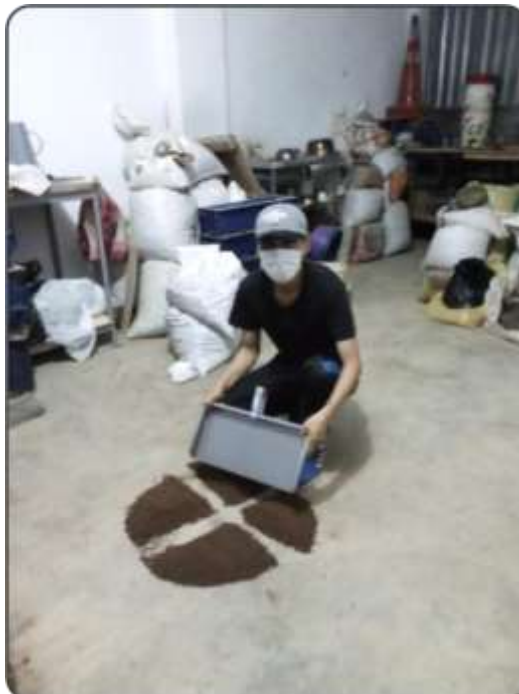
Figura 51. Proceso de cuarteo de la muestra de suelo. Fuente: Elaboración propia.
