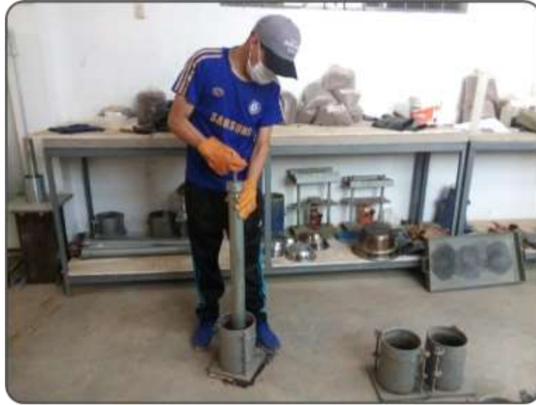
Figura 109. Proceso del compactado del ensayo de proctor. Fuente: Elaboración propia.
