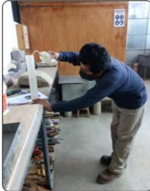
Figura 68. Midiendo la cantidad de agua para cantidad muestra de suelo. Fuente: Elaboración propia.
