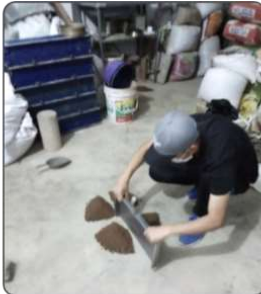
Figura 54. Proceso de cuarteo de la muestra de suelo. Fuente: Elaboración propia.
