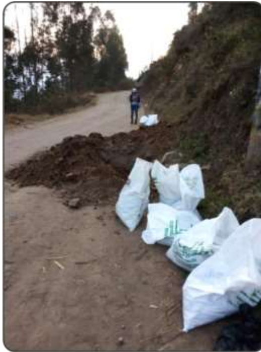
Figura 36. Muestras de suelo ensacados de la calicata C-1, para transportar al laboratorio. Fuente: Elaboración propia.
