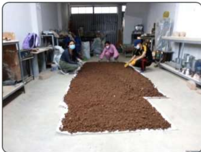
Figura 49. Proceso del desmenuzando de la calicata C-1, para el resto de los ensayos de laboratorio.
