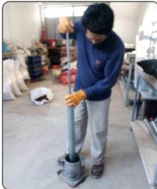
Figura 72. Proceso del compactado del ensayo de proctor. Fuente: Elaboración propia.
