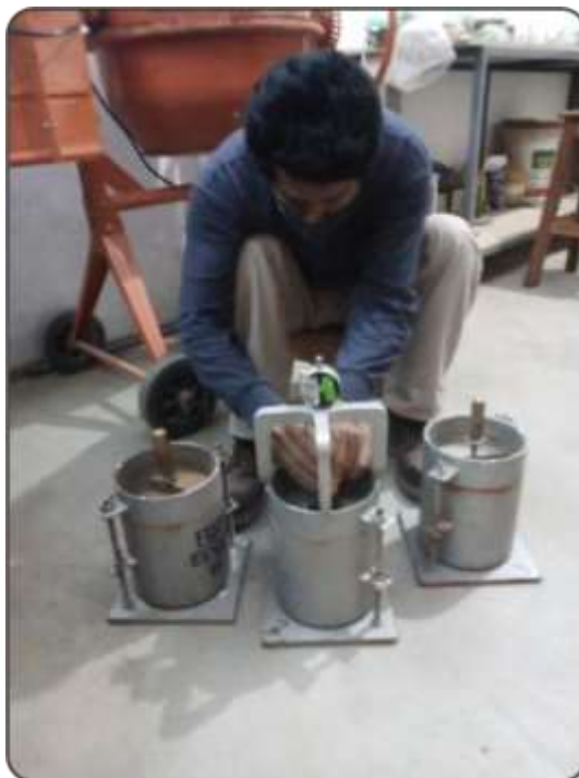
Figura 115. Proceso del colocado del trípode a los moldes. Fuente: Elaboración propia.
