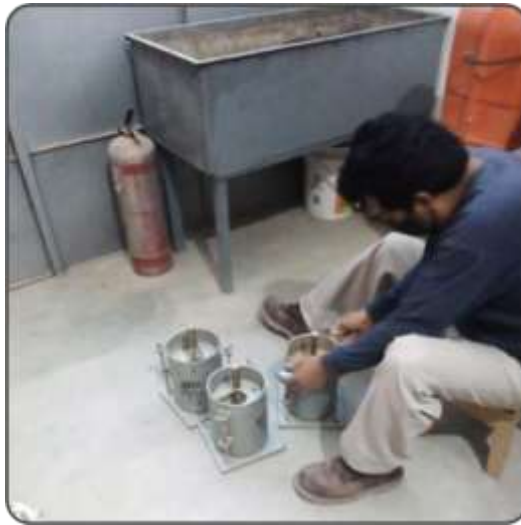
Figura 77. Proceso del colocado de la sobrecarga en los moldes. Fuente: Elaboración propia.
