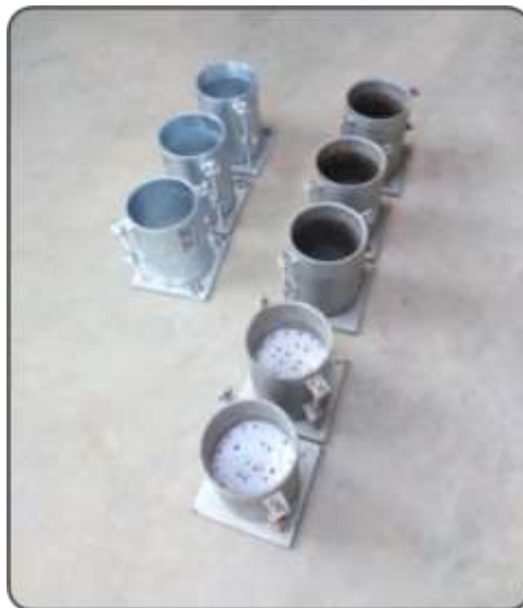
Figura 108. Nivelando los moldes del proctor para realizar el compactado. Fuente: Elaboración propia.
