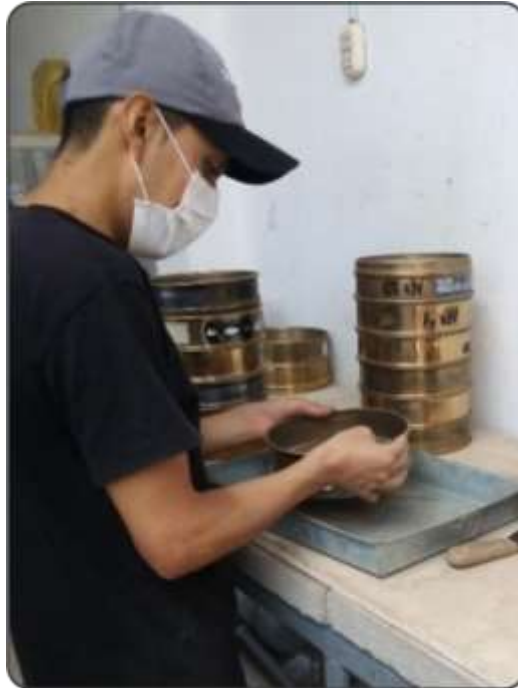
Figura 99. Realizando el proceso de tamizaje manual en la malla N°40. Fuente: Elaboración propia.
