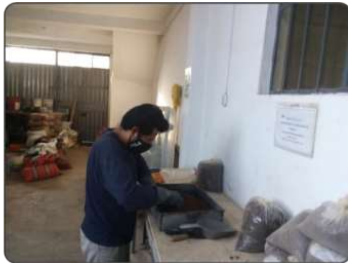
Figura 74. Proceso del mezclado de la muestra de suelo más el agua. Fuente: Elaboración propia.
