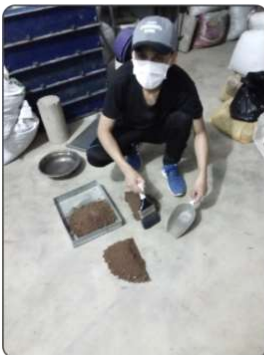
Figura 86. Selección de la muestra de suelo luego del cuarteo. Fuente: Elaboración propia.
