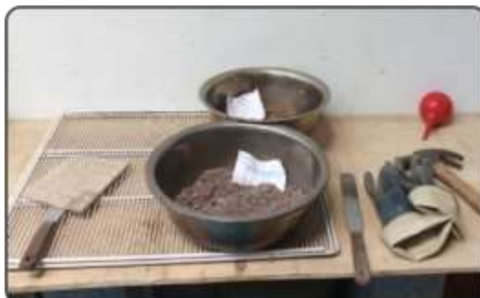
Figura 84. Proceso del enfriamiento de la muestra de suelo. Fuente: Elaboración propia.
