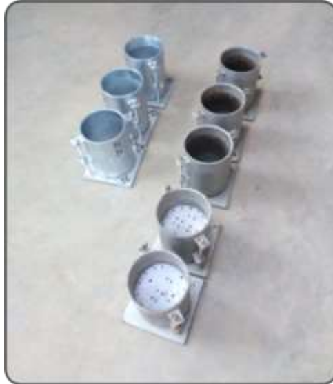
Figura 71. Nivelando los moldes del proctor para realizar el compactado. Fuente: Elaboración propia.
