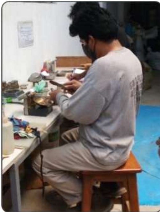
Figura 101. Colocado de la muestra pastosa en la cuchara de Casagrande por técnico laboratorista. Fuente: Elaboración propia.
