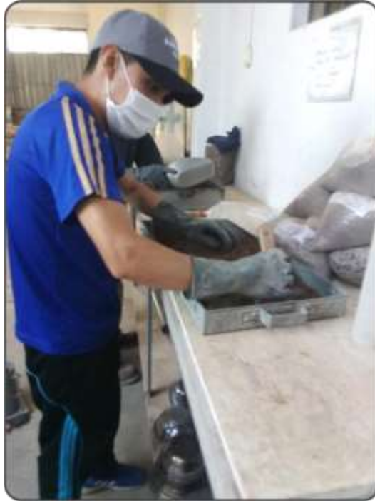
Figura 111. Proceso del mezclado de la muestra de suelo más el agua. Fuente: Elaboración propia.
