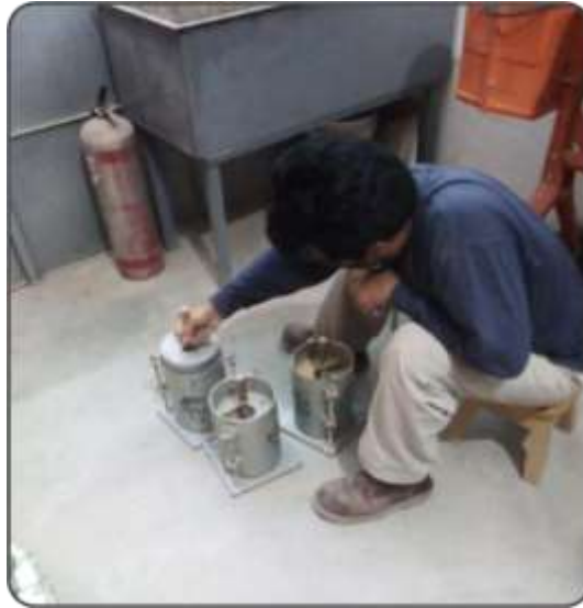
Figura 114. Proceso del colocado de la sobrecarga en los moldes. Fuente: Elaboración propia.
