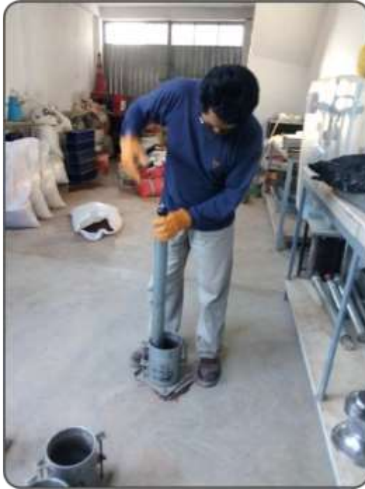
Figura 75. Realizando el proceso de compactado de la muestra de suelo. Fuente: Elaboración propia.
