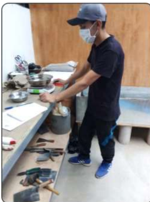
Figura 83. Proceso de pesado de la muestra de suelo húmedo. Fuente: Elaboración propia.
