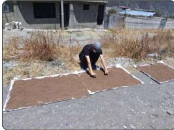
Figura 50. Proceso del secado al aire libre de la calicata C-1. Fuente: Elaboración propia.
