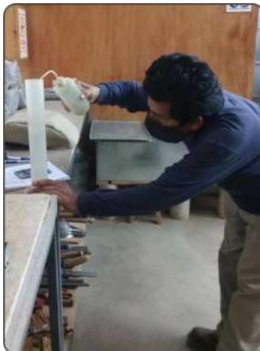
Figura 105. Midiendo la cantidad de agua para cantidad muestra de suelo. Fuente: Elaboración propia.
