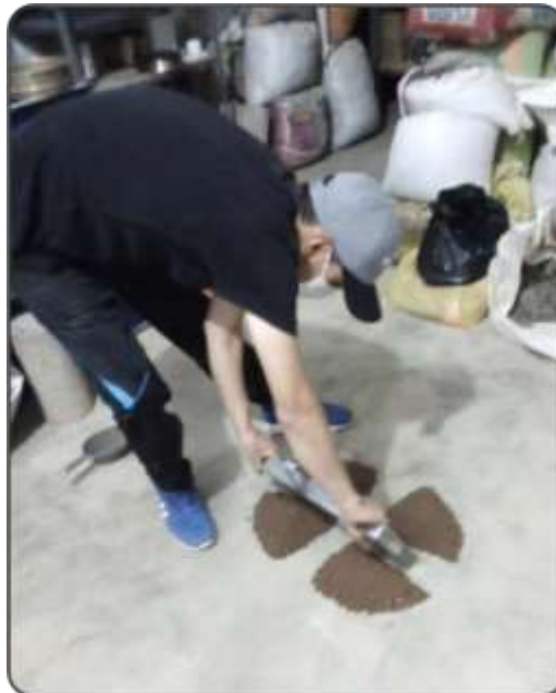
Figura 85. Proceso de cuarteo de la muestra de suelo. Fuente: Elaboración propia.
