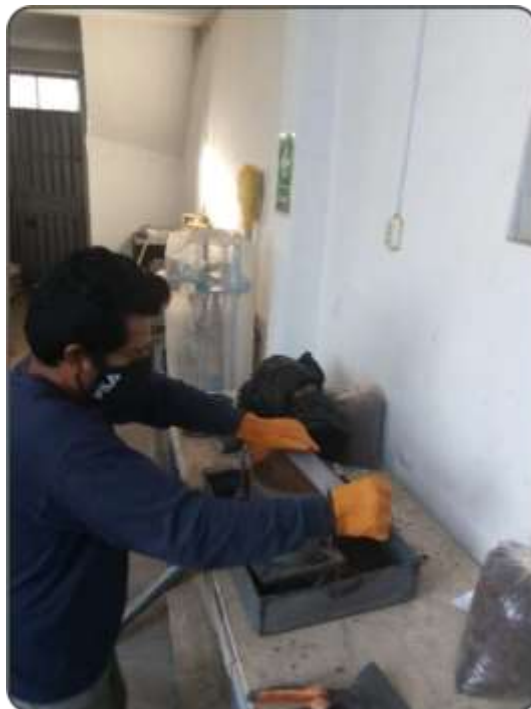
Figura 113. Proceso del nivelado de la muestra que está en el molde usando una regla metálica.
