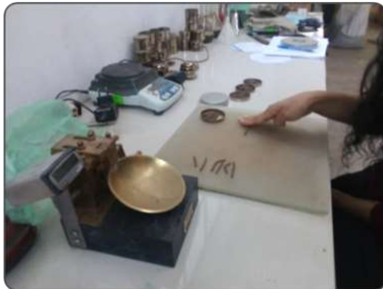
Figura 102. Proceso de elaboración de rolones un diámetro aproximado de 3mm. Fuente: Elaboración propia.
