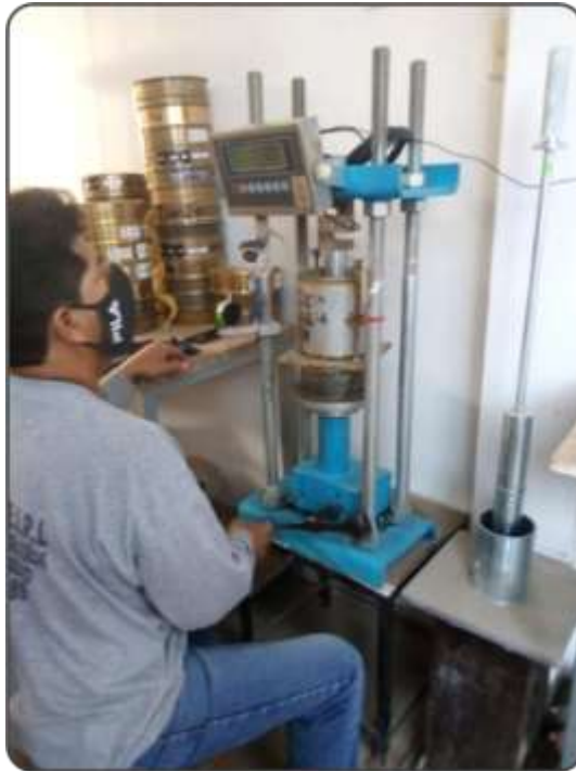
Figura 118. Realizando el proceso del prensado a la muestra. Fuente: Elaboración propia.
