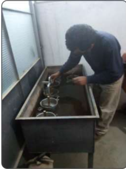
Figura 79. Proceso de saturación de las muestras en un contenedor de agua. Fuente: Elaboración propia.
