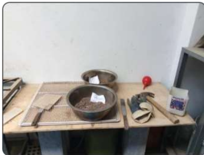
Figura 53. Proceso del enfriamiento de la muestra de suelo. Fuente: Elaboración propia.
