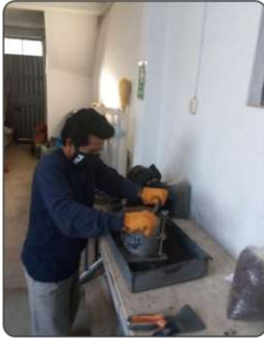
Figura 73. Realizando el proceso del enrazado de la muestra con una regla metálica. Fuente: Elaboración propia.
