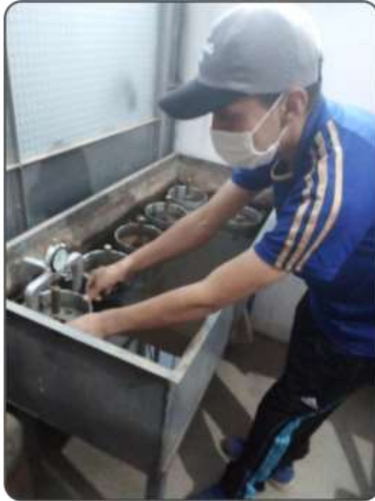
Figura 116. Proceso de saturación de las muestras en un contenedor de agua. Fuente: Elaboración propia.
