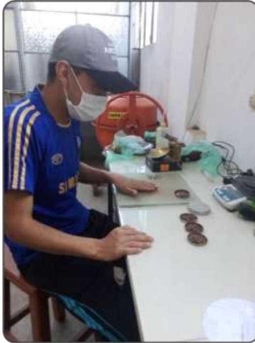
Figura 66. Colocación de los rolones de 3mm en su capsula respectiva. Fuente: Elaboración propia.
