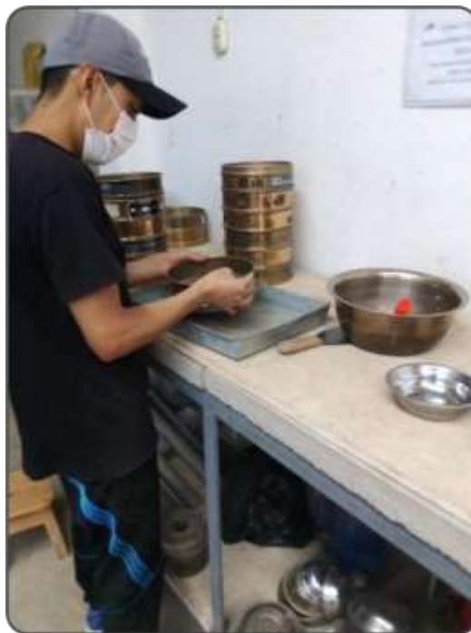
Figura 62. Realizando el proceso de tamizaje manual en la malla N°40. Fuente: Elaboración propia.
