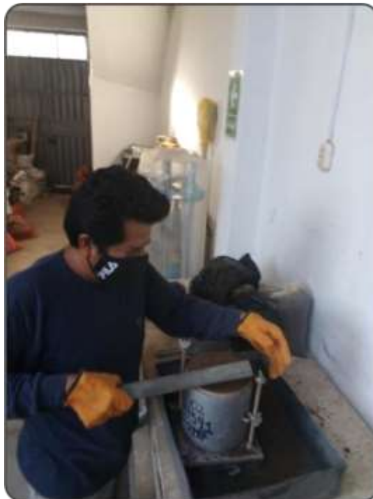
Figura 110. Realizando el proceso del enrazado de la muestra con una regla metálica. Fuente: Elaboración propia.
