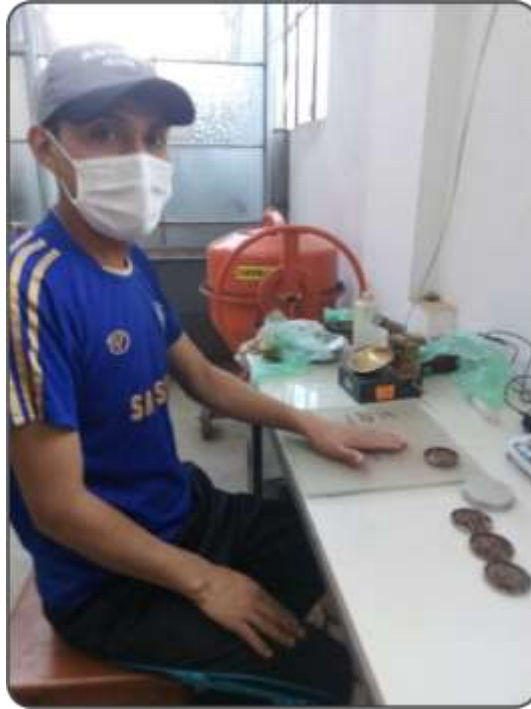
Figura 103. Colocación de los rolones de 3mm en su capsula respectiva. Fuente: Elaboración propia.
