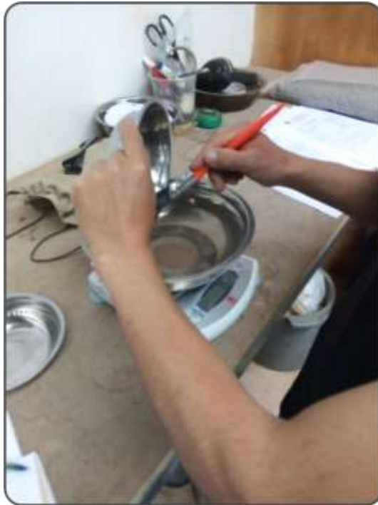
Figura 88. Proceso de pesado de cada tamiz retenido. Fuente: Elaboración propia.
