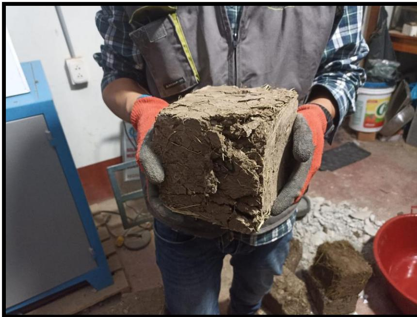
Fotografía 23: Muestras de cubos de abobe para en ensayo de flexión.
