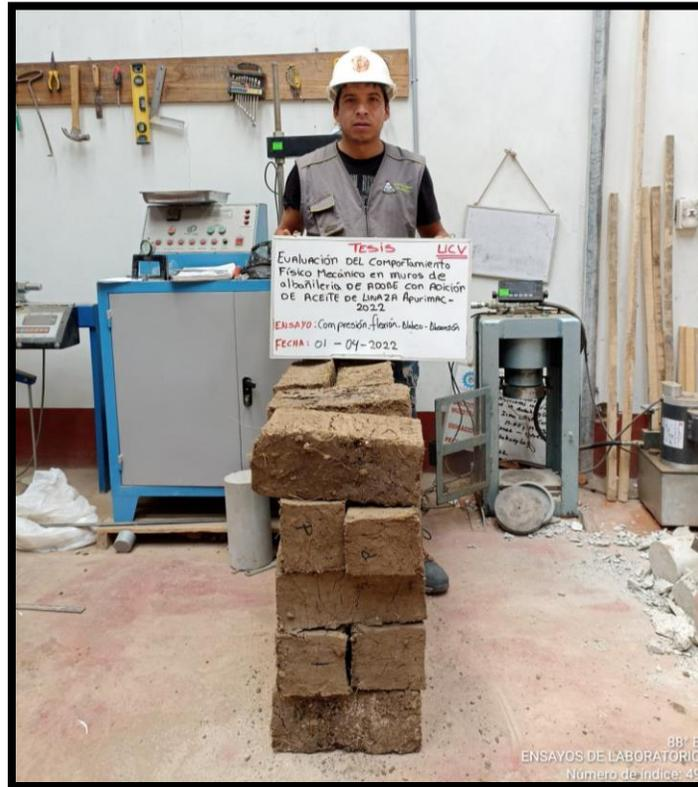
Fotografía 20: Muestras de cubos de abobe para en ensayo de compresión.
