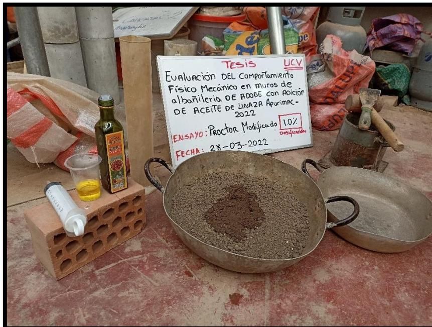
Fotografía 14: Ensayo de Proctor modificado en sus respectivas dosificaciones.
