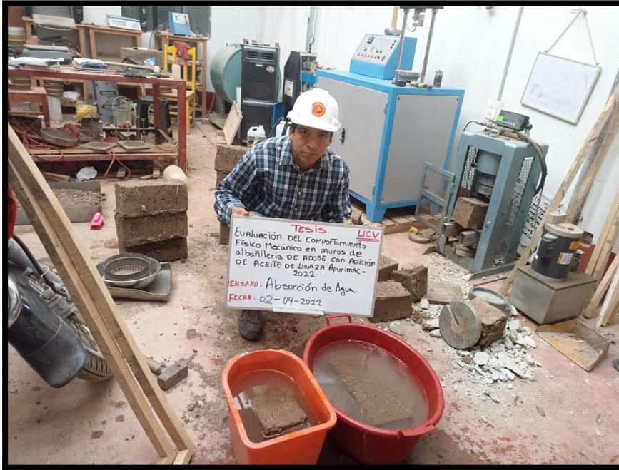
Fotografía 26: Muestras sumergidas en agua.
