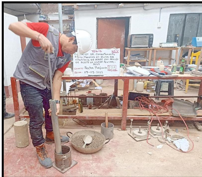
Fotografía 16: Ensayo de Proctor modificado.
