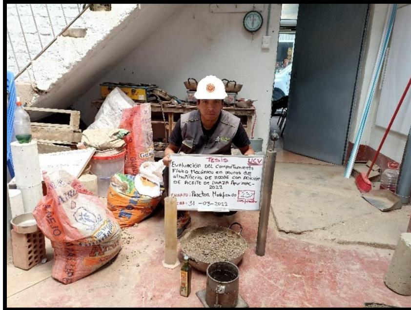
Fotografía 15: Ensayo de Proctor modificado.
